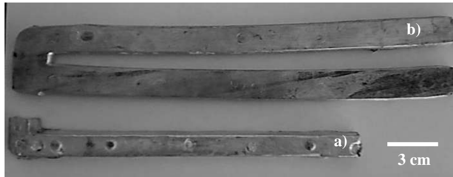
Figura 3. 5: Pieza en condiciones de; a) colada y b) laminada.
