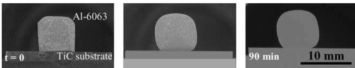
Figura 2. 15: Comportamiento de mojabilidad del Al-6063/TiC a 900°C en Ar[15].
