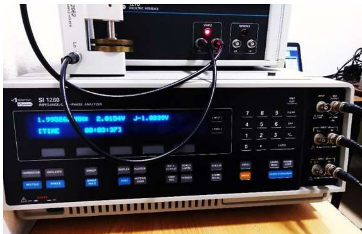
Figura 3.10. Multímetro para medir la impedancia de las pastillas de ZnO.
