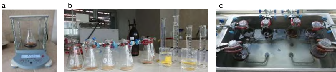
Figura 11. 24. Matraz con 2 g de harina de madera (a), matraz con harina de madera y 100 ml de NaOH al 1.0% (b), muestras en baño de agua durante 60 minutos (c).
