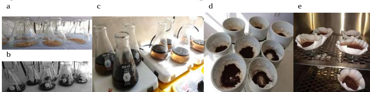
Figura 11. 28. Harina libre de extraíbles (a), harina libre de extraíbles en ácido sulfúrico (b), Soluciones de las muestras sometidas a ebullición (c), muestras en filtro para lavado (d), muestras a la estufa para peso constante lignina (e).
