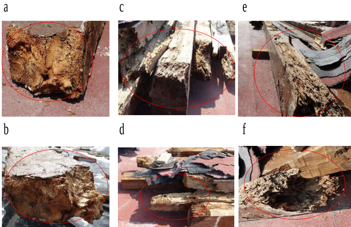
Figura 11. 6. Condiciones de las cabezas de las vigas de la Catedral Metropolitana de Morelia (b, c, d, e y f viguería con posibilidades de ser reutilizada, a y b madera en pésimas condiciones fracturada al ser retirada).
