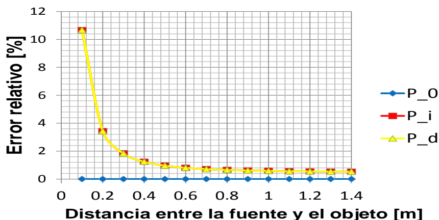
Figura 31. Variación del error relativo de la componente e_z del vector de sensibilidad dependiente de la distancia entre la fuente de iluminación y la muestra.
