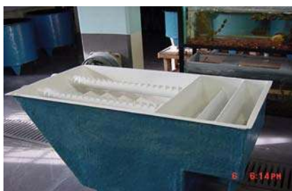
Figura 2. Tanque de sedimentación
