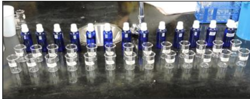
Figura 19. Vasos de precipitados y soluciones de NaOCl para ensayo de disolución en reposo.
