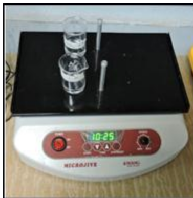
Figura 22. Agitador mecánico para agregar movimiento a las soluciones de NaOCl en el ensayo de disolución de tejido pulpar bovino.
