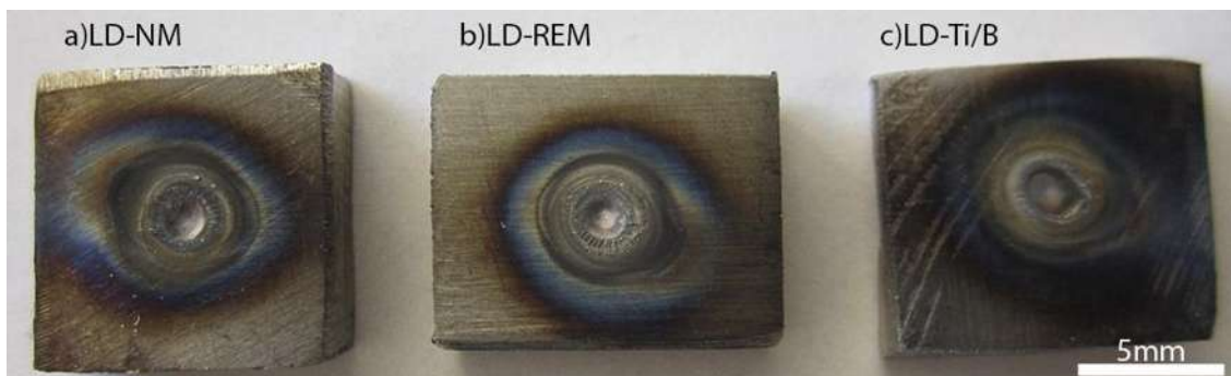
Figura 3.34 Macrografías de botones de soldadura en condición de 25 A de corriente y 3 s. de permanencia.
