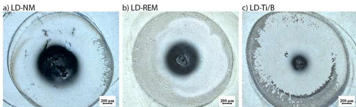
Figura 3.36 Micrografías de botones de soldadura mediante LOM (5x) en condición de 25 A y 3 s, a) acero LD-NM, b) acero LD-REM y c) acero LD-Ti/B.
