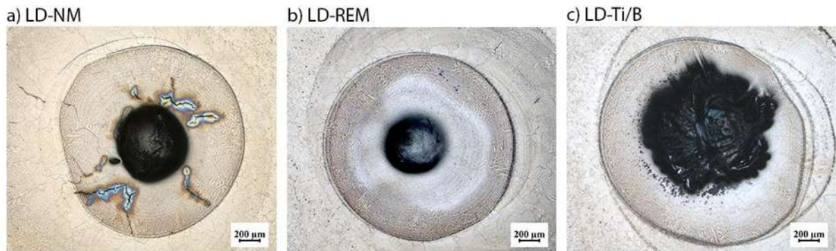
Figura 3.35 Micrografías de botones de soldadura mediante LOM (5x) en condición de 20 A y 3 s, a) acero LD-NM, b) acero LD-REM y c) acero LD-Ti/B.
