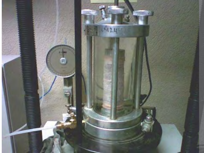
Imagen 3. 22 Ensaye de compresión triaxial en operación.
