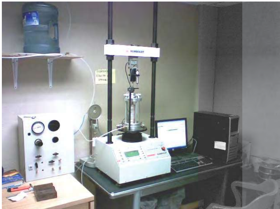
Imagen 3. 21 Equipo utilizado para las pruebas triaxiales.
