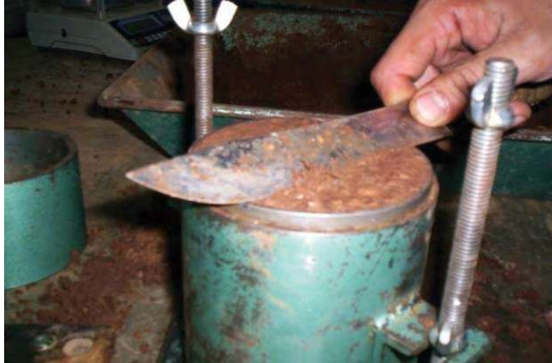
Imagen 3. 15 Enrase del material en el molde Próctor (material 3).
