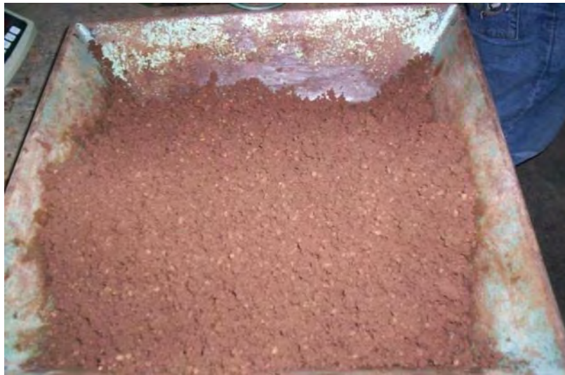
Imagen 3. 14 Adición de agua al material (material 3).
