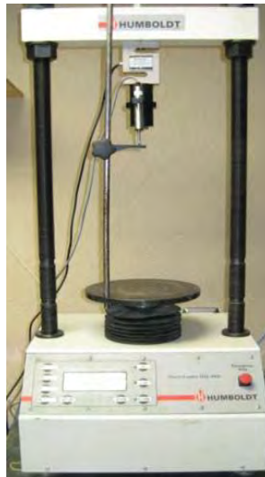
Imagen 3. 28 Marco de carga digital Máster Loader HM-3000 marca Humboldt.
