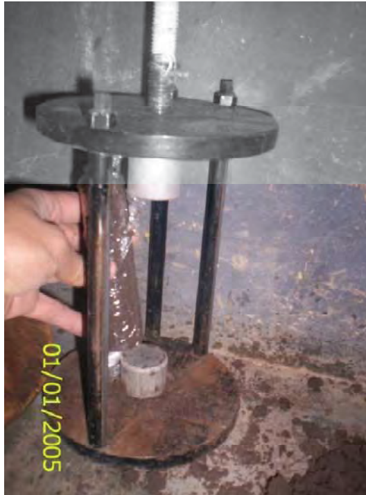
Imagen 3. 18 Protección del espécimen para conservar la humedad (material 2).
