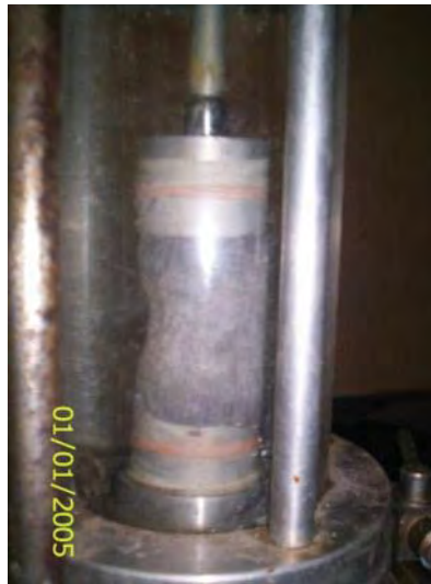
Imagen 3. 20 Ensaye de compresión triaxial en el punto de falla.
