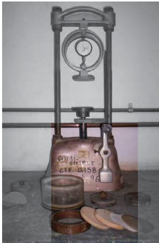
Imagen 3. 24 Marco de compresión simple para el ensaye de presión de expansión.
