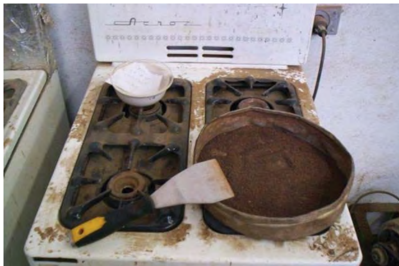
Imagen 3. 9 Secado mediante el procedimiento de secado rápido (material 3).
