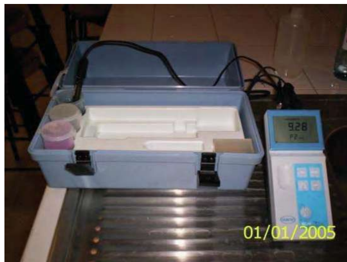
Imagen 3. 2 Proceso de calibración del potenciómetro, utilizando líquidos tipo.
