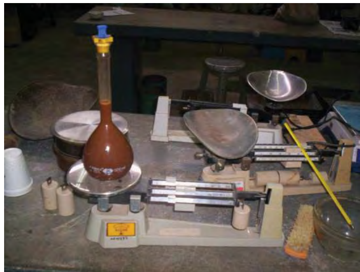
Imagen 3. 12 Proceso de pesaje y medición de la temperatura (material 3).
