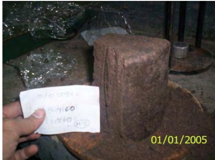
Imagen 3. 17 Labrado del espécimen (material 2).
