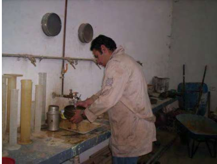
Imagen 3. 10 Procedimiento de lavado del material, tamizándolo por la malla No. 200.
