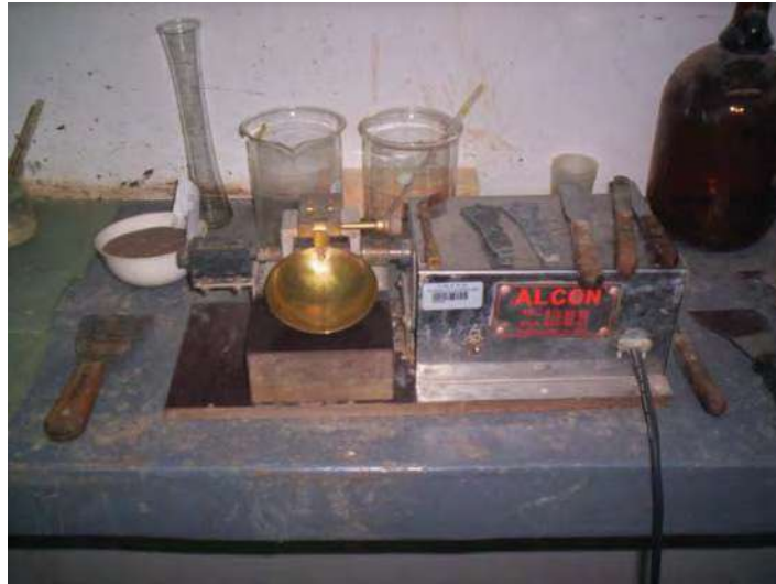
Imagen 3. 13 Equipo para la determinación de los Límites de consistencia.
