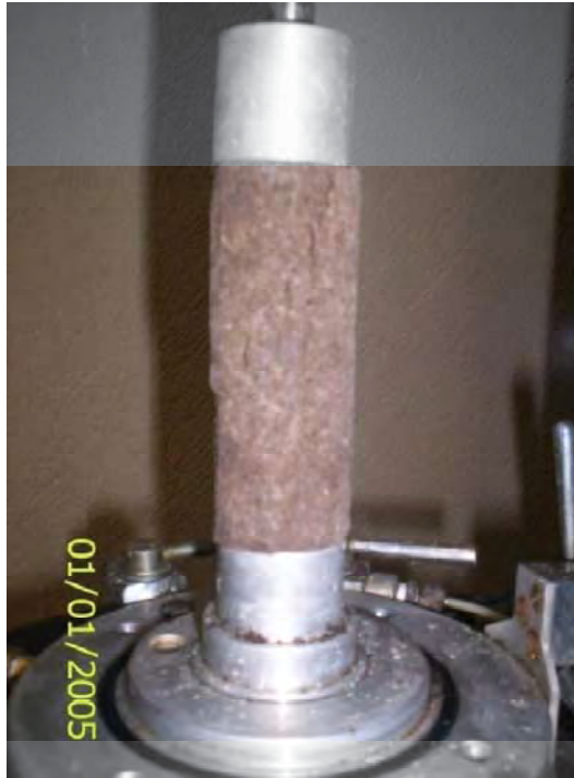
Imagen 3. 19 Espécimen (montado) después de ensayarlo, nótese el plano de falla (material 3).
