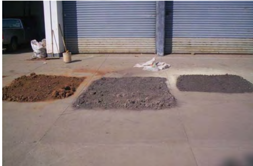
Imagen 3. 8 Secado del material al aire libre en el laboratorio.
