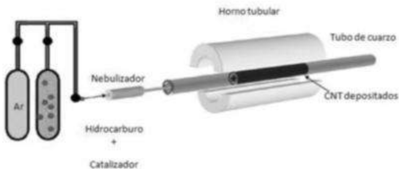
Figura 12. Diagrama del método de rocío pirolítico
