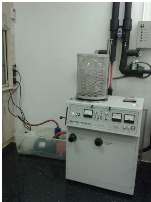
Figura 32. Equipo para depositar carbono
