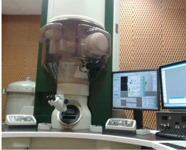
Figura 17. Microscopio electrónico de aberración corregida, en UTSA; San Antonio, Texas
