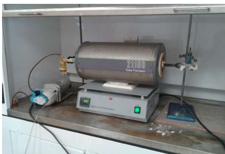
Figura 26. Sistema Rocío Pirolítico para la obtención de los NTC
