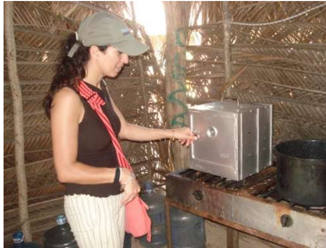
Figura 18. Secado de arena en horno para determinar porcentaje de humedad.
