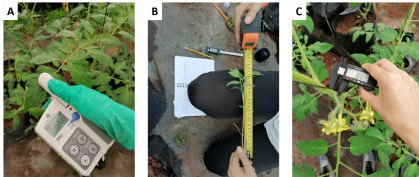
Figura 8. Medición de variables en planta. A) Medición de unidades SPAD; B) Medición de altura de la planta con flexómetro y C) Medición de diámetro del tallo con vernier digital.
