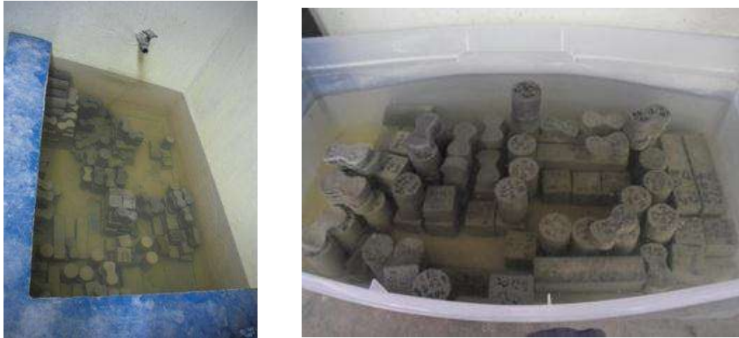
Ilustración 3.5.4.1. Pila de curado y contenedor alternativo para el curado de los especímenes.
