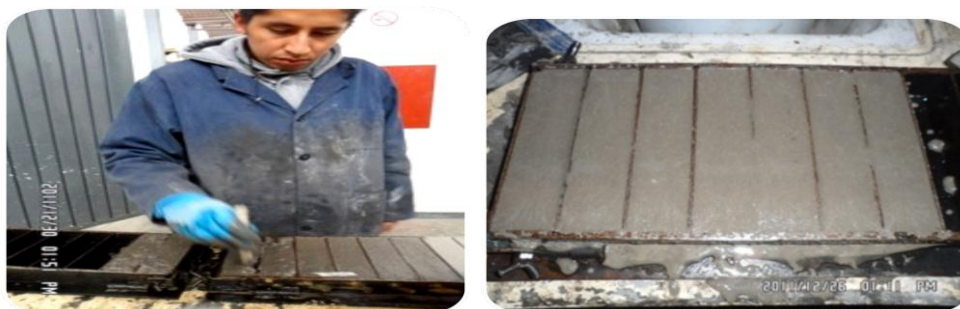
Ilustración 3.5.3.6. Llenado de especímenes prismáticos de 4cm x 4cm x 16cm
