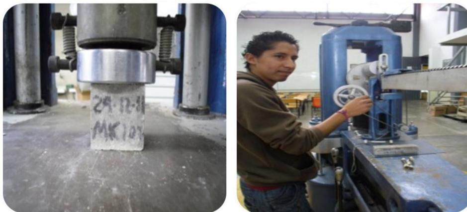
Ilustración 3.6.2.1.1. Prueba de Resistencia en cubos utilizando la máquina universal Tinius Olsen.
