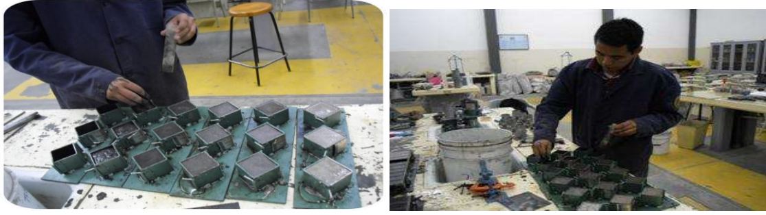
Ilustración 3.5.3.3. Lote de moldes para cubos de 5x5x5cm. Ilustración 3.5.3.4. Preparación de los moldes para elaboración de cubos de mortero y cubos.
