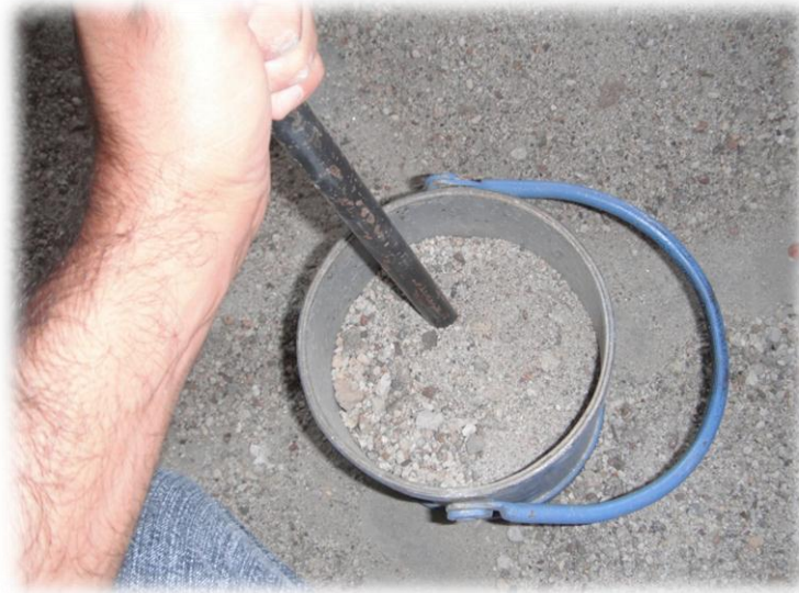
Ilustración 0.4.1.4. Varillado de la arena en la prueba de MVSV
