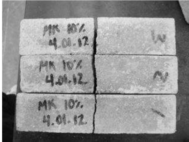
Ilustración 3.6.2.2.3. Resultados de la prueba de flexión estática. Tipo de ruptura al centro.
