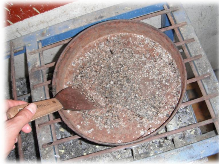
Ilustración 0.4.1.1. Secado del arena en parrilla.
