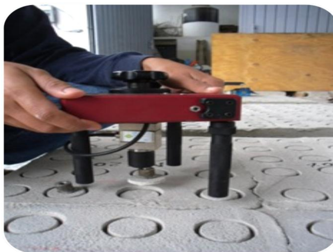
Ilustración 3.6.2.4.11. Realización de la prueba de adherencia, mediante el equipo de Pull Off.
