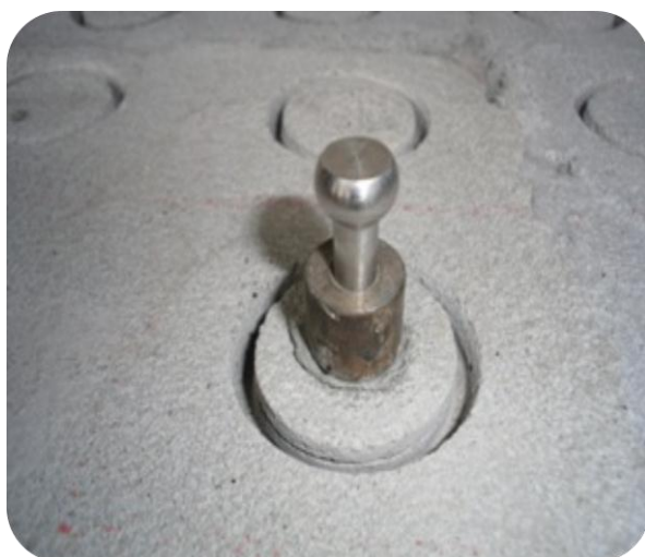
Ilustración 3.6.2.4.6. Dolly con adaptador para el aparato de Prueba Pull Off
