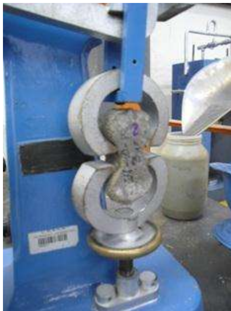
Ilustración 3.6.2.3.2. Aplicación de la fuerza de tensión sobre la briqueta.
