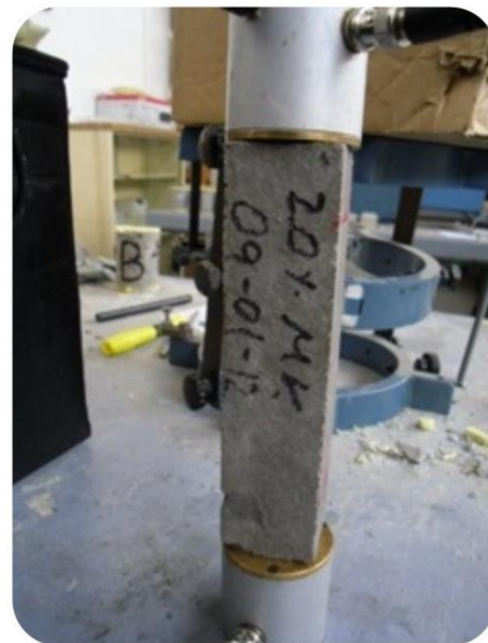
Ilustración 3.6.1.2.3. Equipo para medir la velocidad de pulso ultrasónico y espécimen prismático colocado para realizarle la prueba de velocidad de pulso ultrasónico.
