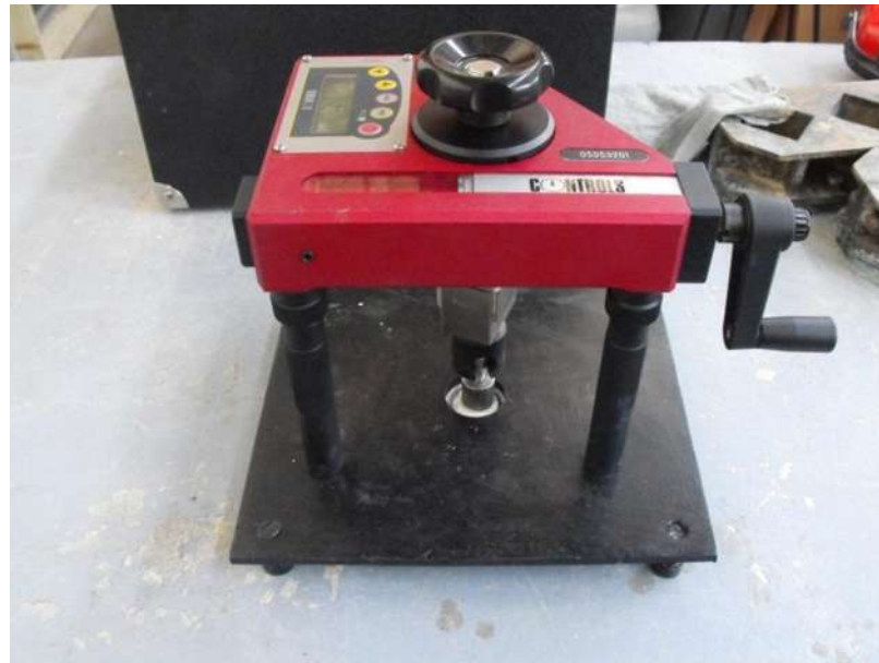
Ilustración 3.6.2.4.5. Equipo para prueba Pull Off marca CONTROLS.
