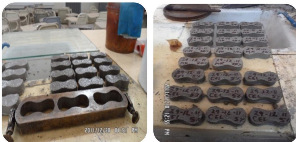
Ilustración 3.5.3.7. Elaboración de briquetas, utilizando molde y cristal previamente engrasado.
