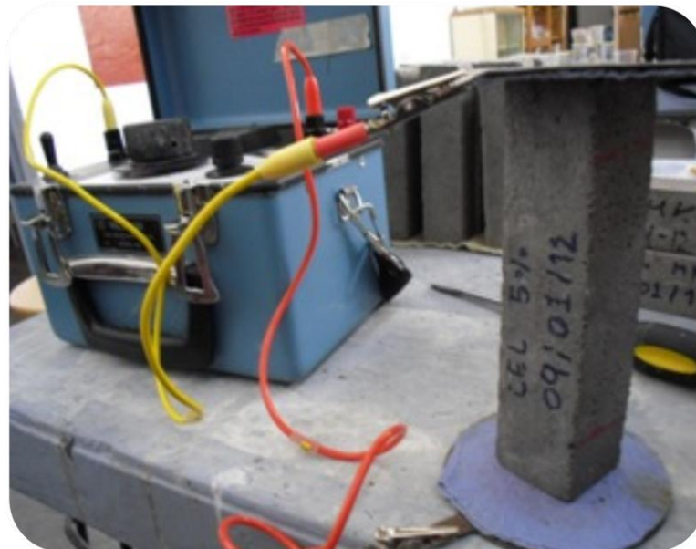
Ilustración 3.6.1.1.2. Especimen prismático colocado entre las dos placas de cobre lista para tomar la resistencia eléctrica.
