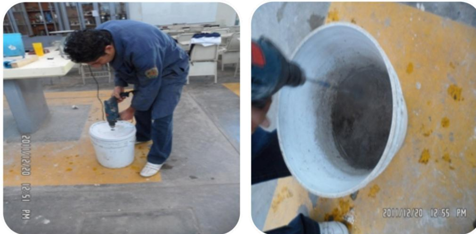
Ilustración 3.5.3 y 3.5.4. Método de mezclado de áridos mediante aspas de acero impulsadas por el taladro.
