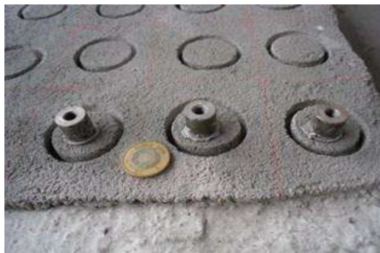
Ilustración 3.6.2.4.4. Relación de dimensiones de las perforaciones y discos utilizados.
