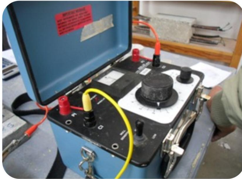
Ilustración 3.6.1.1.1. Equipo utilizado para determinar la resistividad eléctrica.
