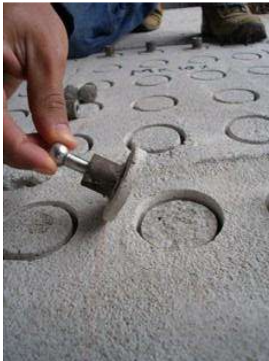
Ilustración 3.6.2.4.9. Falla entre revestimiento y el estrato. Tipo (3). Material MK.
