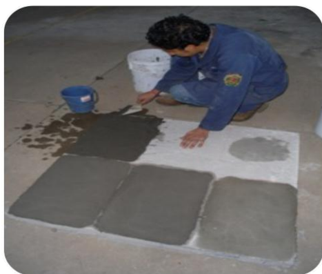
Ilustración 3.5.2.3. Agregado de la mezcla de mortero con sus diferentes sustituciones, alas losas de concreto para posteriormente realizarle la prueba de adherencia.
