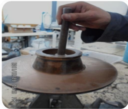
Ilustración 3.5.1. Prueba de fluidez. Mesa y Pisón de prueba.
