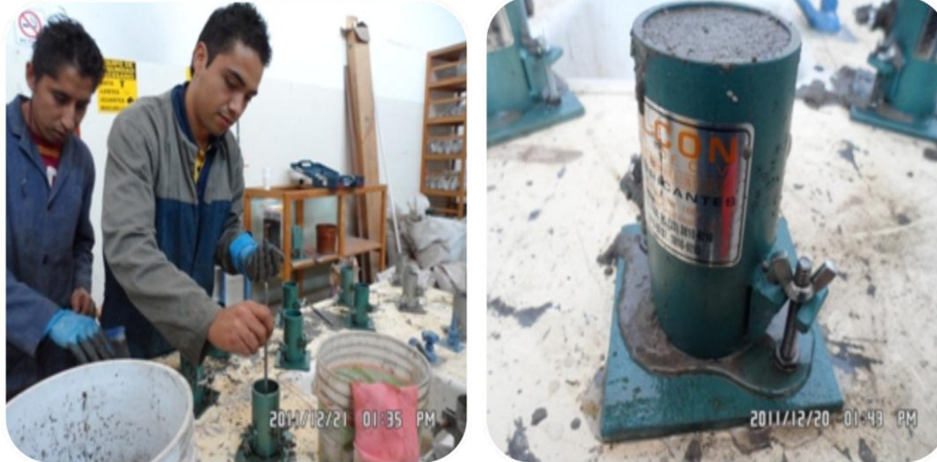
Ilustración 3.5.3.9. Fabricación de especímenes cilíndricos de 10cm de altura por 5cm de diámetro.
