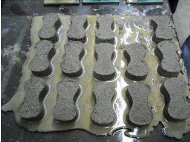
Ilustración 3.5.3.8. Sangrado en Briquetas después de un momento de elaboradas.
