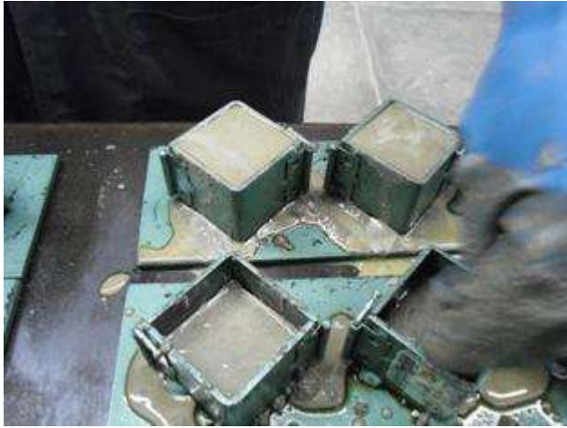
Ilustración 3.5.3.5. Procedimiento de llenado de cubos. Se observa el sangrado de la mezcla.
