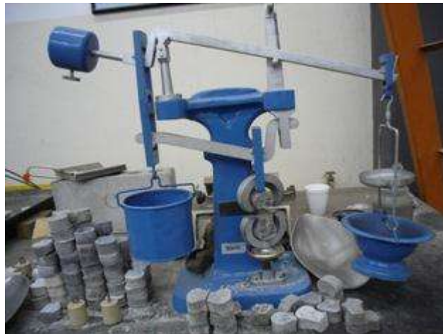
Ilustración 3.6.2.3.1. Máquina Michaelis para prueba a tensión en briquetas.
