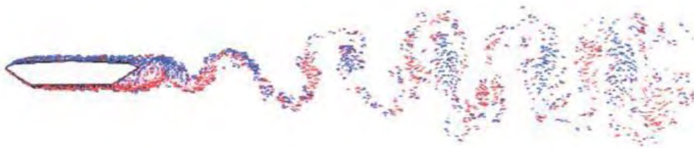
Figura 1.10 Desprendimiento de Torbellinos obtenido mediante Vórtices Discretos.
