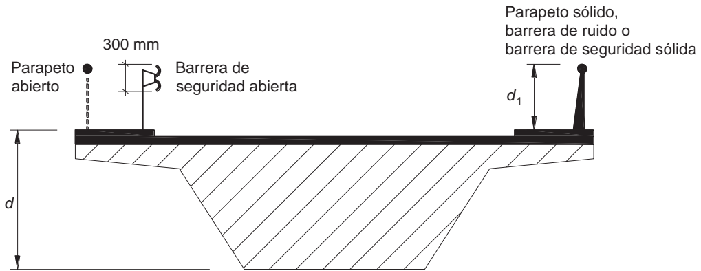
Figura 2.6 Canto a utilizar para el cálculo de A_{ref,x}
