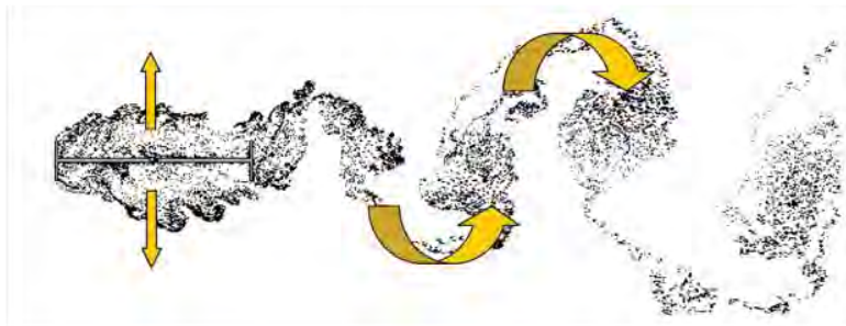
Figura 1.2 Vibraciones verticales generadas en un tablero por el desprendimiento de vórtices
