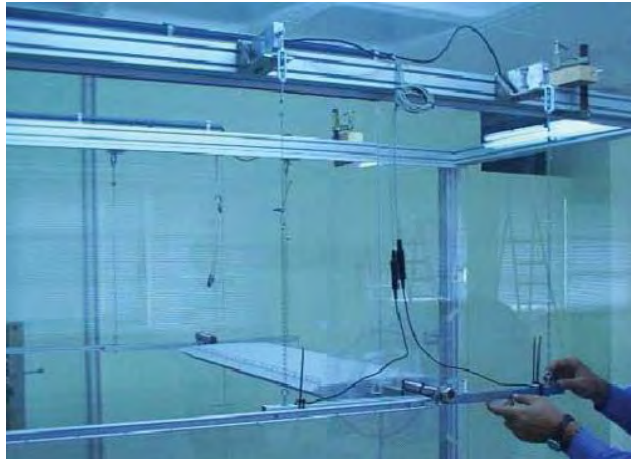
Figura 1.7 Modelo seccional del puente Gran Belt preparado para realizar un ensaye aeroelástico.
