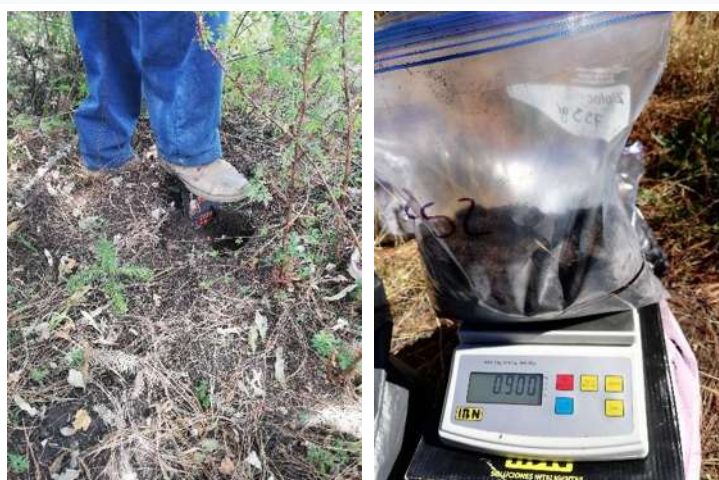
Figura 21. Toma de muestras de suelo en campo.
