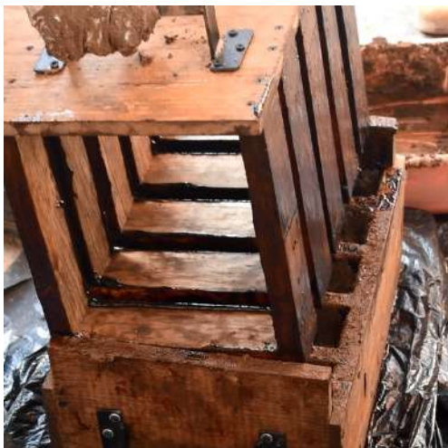
Fig. 323. Prensa y molde con mezcla. Fotografía propia. Tomada el 18 de octubre de 2020.
