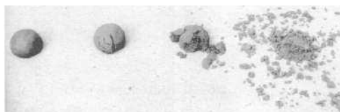
Fig. 112. Blanco Montero y Morales Pereira (2010). Ensayo de caída de bola. Recuperada del artículo "Ficha técnica: sistema constructivo adobe/tapial".
