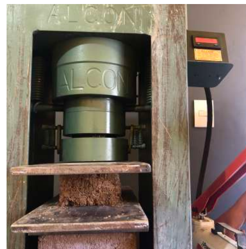
Fig. 276 Muestra de Diseño tres sometida a presión. Fotografía propia. Tomada el 25 de Mayo de 2020.
