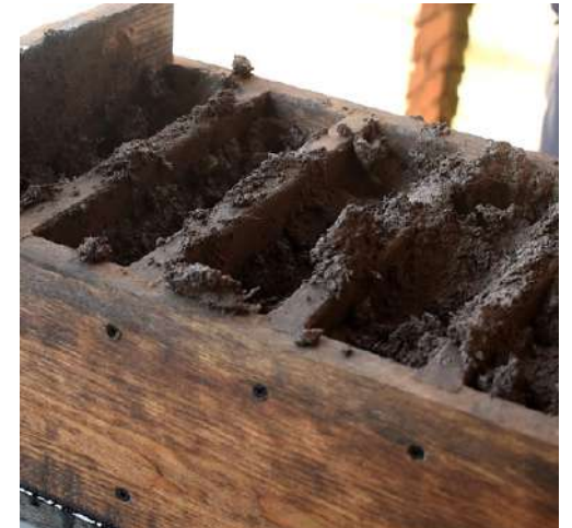
Fig. 311. Vaciado de mezcla a molde. Fotografía propia. Tomada el 04 de octubre de 2020.
