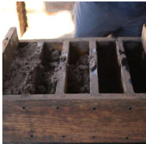
Fig. 309. Vaciado de mezcla a molde. Fotografía propia. Tomada el 04 de octubre de 2020.
