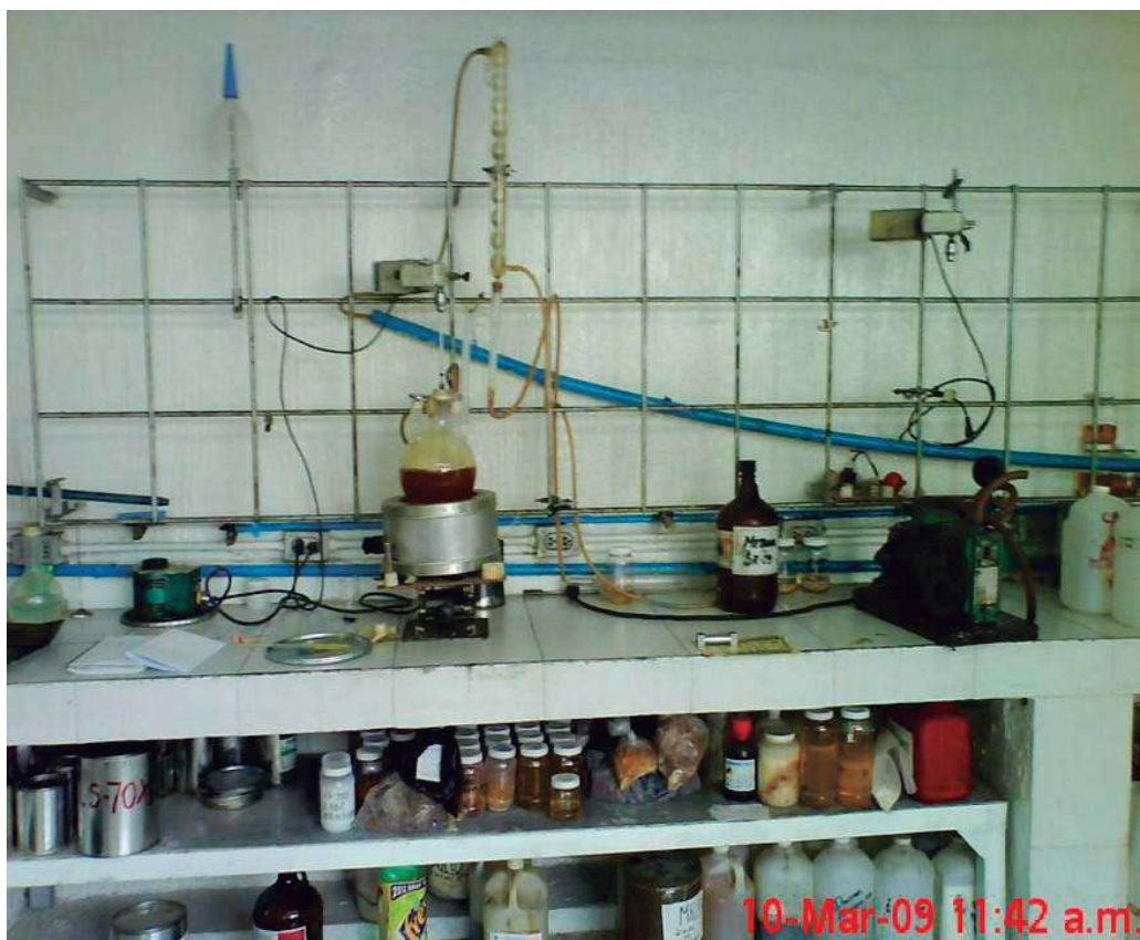
Figura 3.1. Reactor de cuatro bocas y accesorios empleados en la síntesis de aditivos
