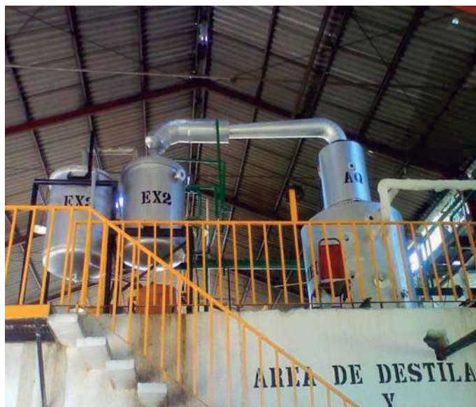
Figura 2.5. Típico sistema de destilación de resina de pino, planta resinera LAZARO CARDENAS AR DE IC, Ciudad Hidalgo Michoacán: derecha alambique tipo batch, izquierda condensadores o intercambiadores de placas para enfriar la mezcla agua-aguarrás.
