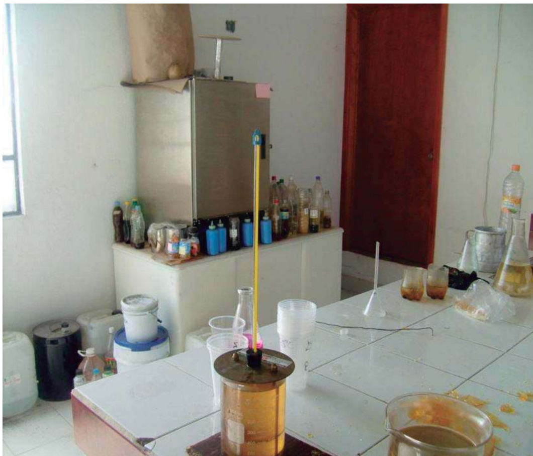
Figura 3.2. Equipo para determinar punto de ablandamiento y sólidos totales en breas empleadas en la síntesis de aditivos
