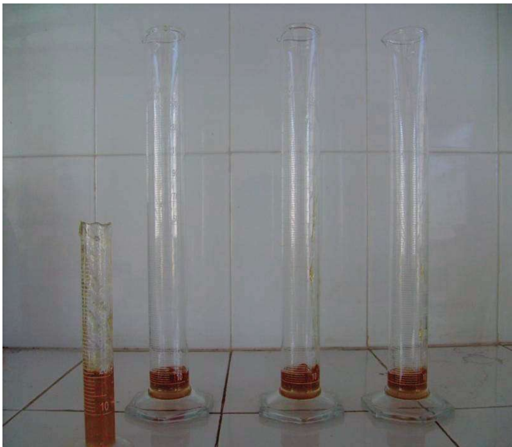
Figuras 3.6. Muestras de los aditivos sintetizados: resinato de sodio, resinato de sodio reforzado y resinato de trietanol amonio
