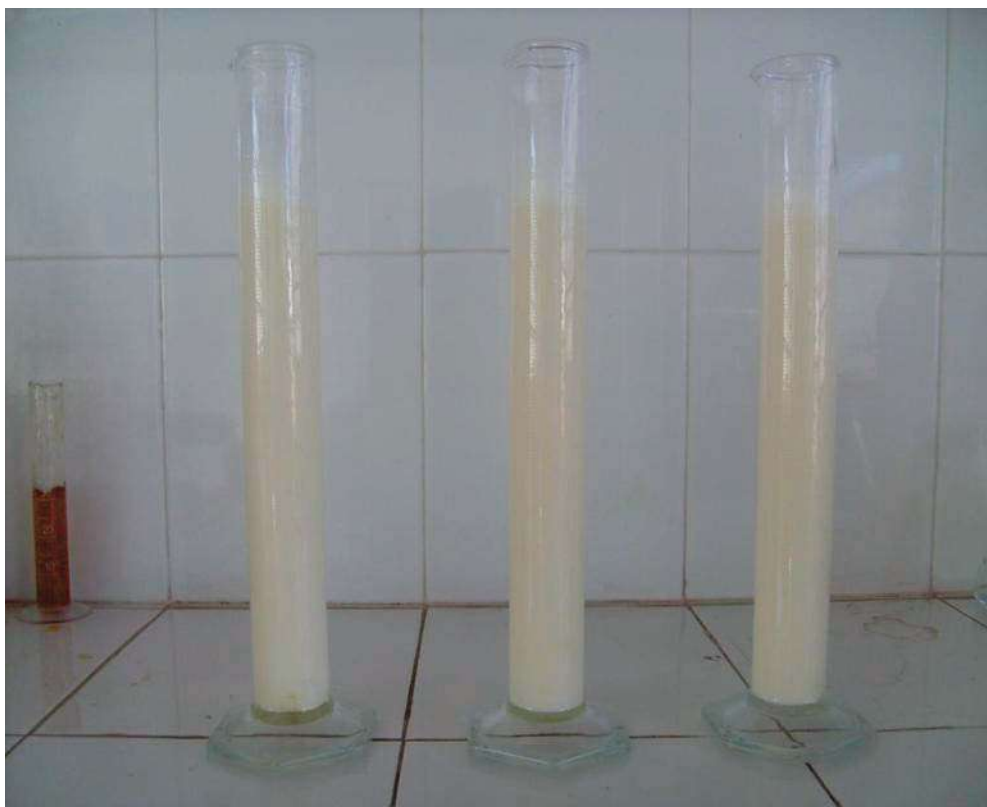
Figuras 3.7. Muestras de aditivos en emulsión: resinato de sodio, resinato de sodio reforzado y resinato de trietanol amonio
