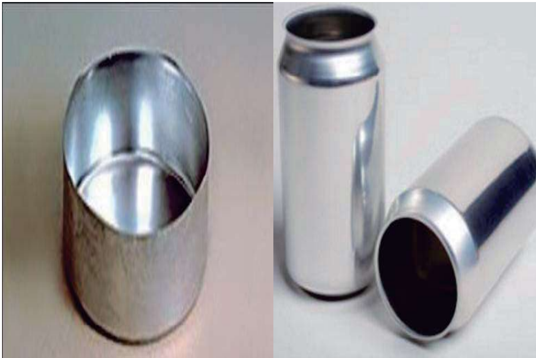
Figura 2.9. Copa cilíndrica de aluminio con la cual se forma el cuerpo de la lata hasta las dimensiones requeridas
