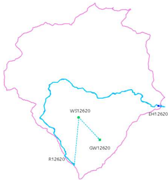
Figura 23. Esquema de modelación de la cuenca 12620 en WEAP.
