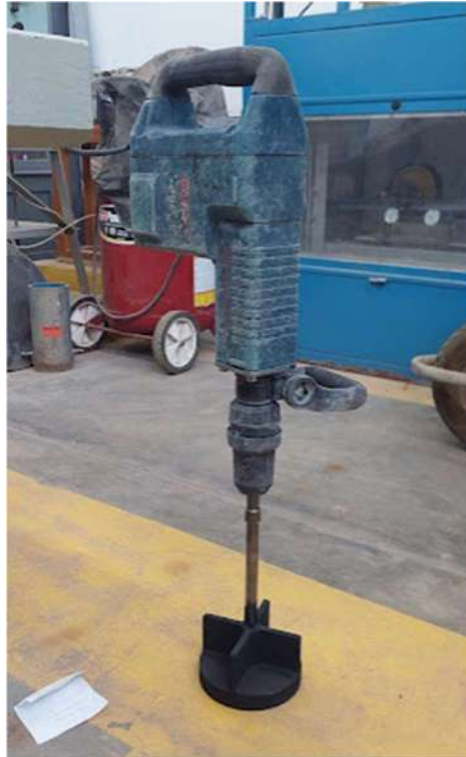
Figura 21. Compactador diseñado y construido para ensayo con rotomartillo BOSH de 10 kg y placa de \varnothing de 15 cm.
