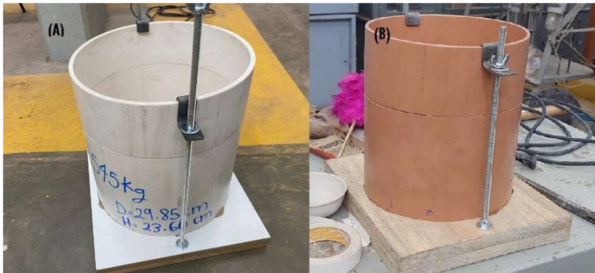
Figura 19. Moldes de compactación: (A) 12 in de diámetro y altura de 23.60 cm y (B) 10 in de diámetro y altura de 19.55 cm.
