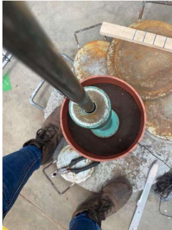
Figura 20. Prueba piloto en molde de 10 in con pisón de 4.54 kg.
