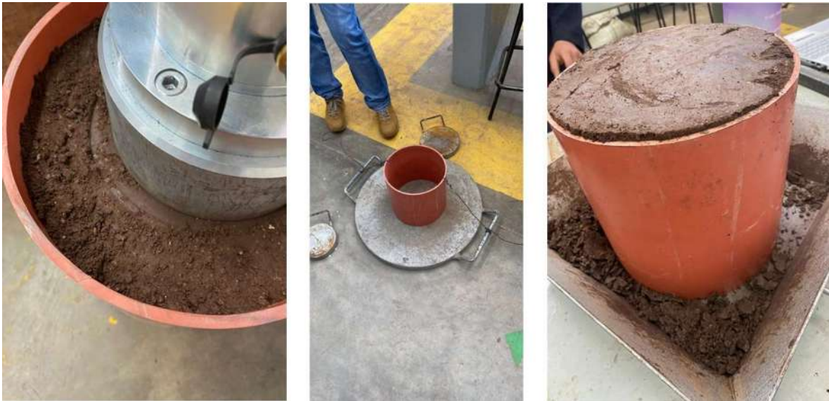
Figura 17. Prototipos previos al molde final y sus irregularidades.
