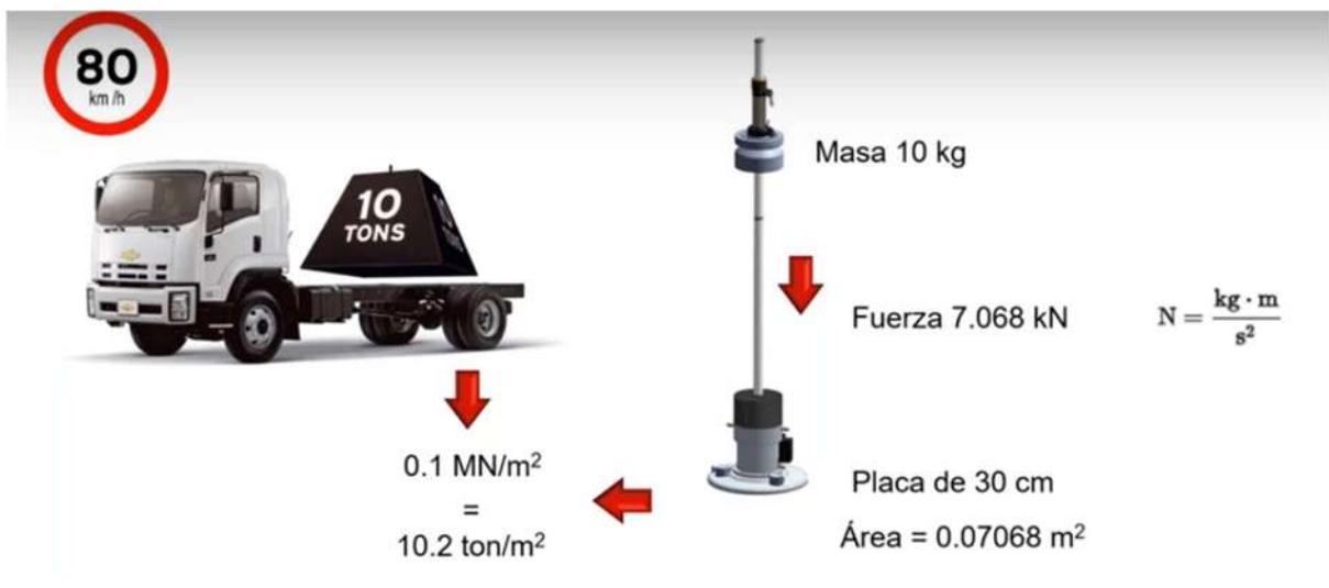
Figura 13. Principio de operación del LWD. (Casteñeda, 2020).
