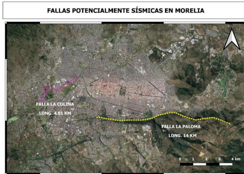
Figura 2.1.5 Falla de la Paloma. Se puede observar los deslizamientos en el talud, lo que comprueba la presencia de actividad sísmica. Figura modificada de Garduño-Monroy, et al. (2001). Falla de la Colina. Se extiende de NE a SO, con la mancha urbana no es tan notable desde la fotografía satelital. Figura modificada de Garduño-Monroy, et al. (2001).
