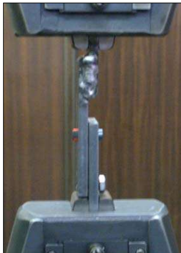
Figura 4.24. Muestra sometida al corte en el equipo utilizado para la evaluación.
