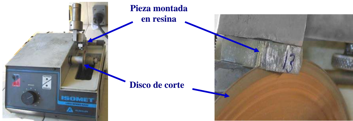
Figura 3.6 Equipo empleado para el corte de las muestras.
