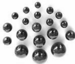
Figura 2.1 Bolas de nitruro de silicio empleadas en válvulas de retención
