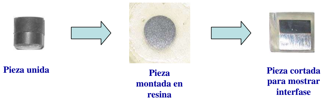
Figura 3.7 Montaje y corte de las muestras unidas.
