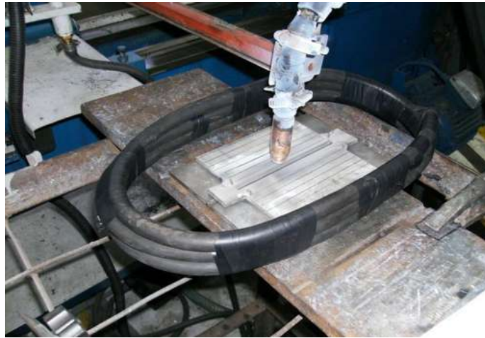
Figura 3.3 Arreglo experimental para inducir la aplicación de un campo magnético axial durante la soldadura.
