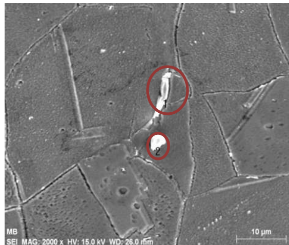
Figura 4.6 Detalle de la microestructura del material base IN600.
