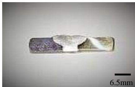
Figura 3.5 Corte transversal de las soldaduras para metalografía.
