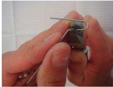
FIG 20. SE MUESTRA COMO EL ALAMBRE ES DOBLADO CON LOS DEDOS Y SOSTENIDO CON LA PINZA. FUENTE PROPIA.
