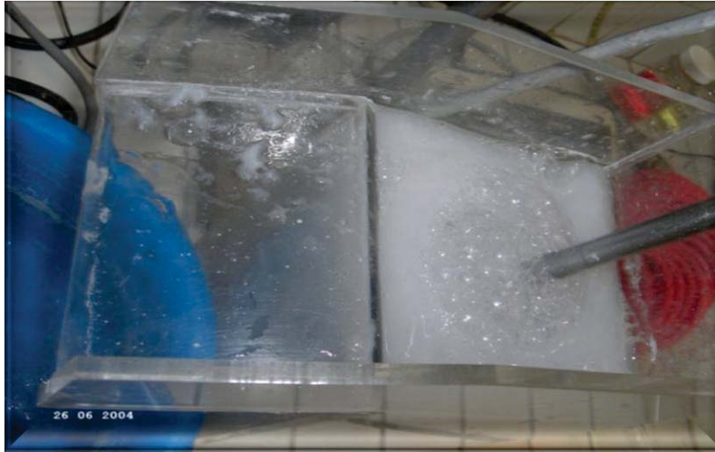
Fig. 8.- Celda de Flotación.
