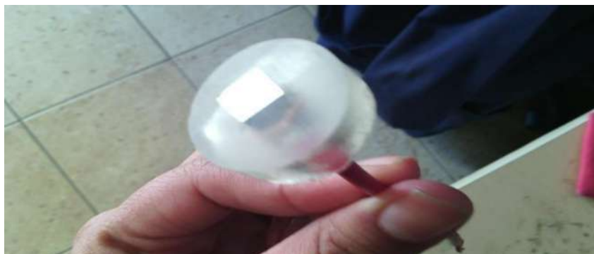
Figura 3.7. Probeta encapsulada con resina epóxica.
