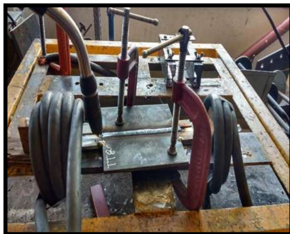
Figura 3.5. Dirección perpendicular del campo magnético aplicado durante el proceso de soldadura.
