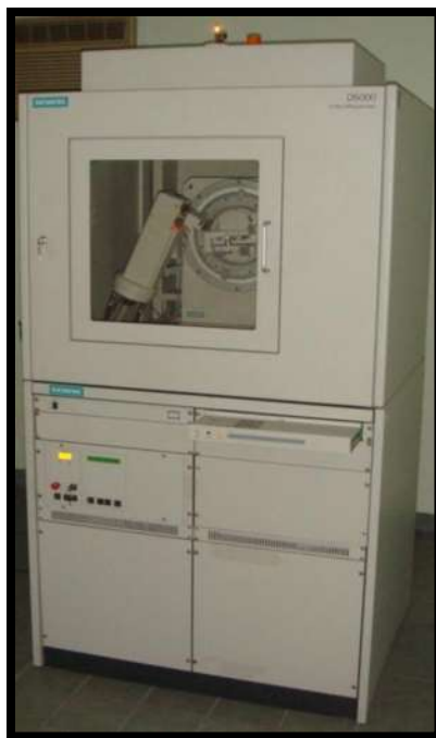
Figura 2.4.- Difractómetro de Rayos X Siemens D5000.
