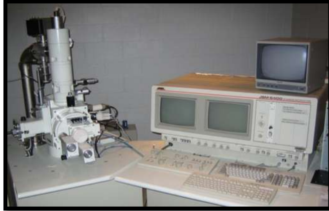
Figura 2.5.- Microscopio Electrónico de Barrido JEOL 6400.
