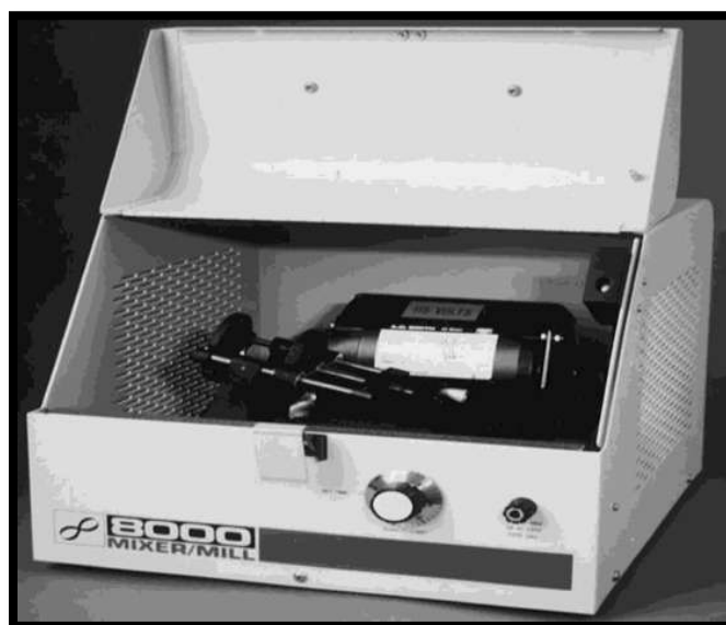
Figura 2.2 Molino de bolas SPEX 8000M
