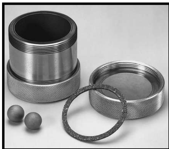
Figura 2.3 Vial y bolas de acero endurecido
