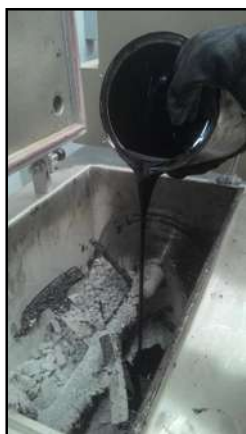
Figura 111 Mezclado de materiales y curado de la mezcla asfáltica, paso (2 y 3).
