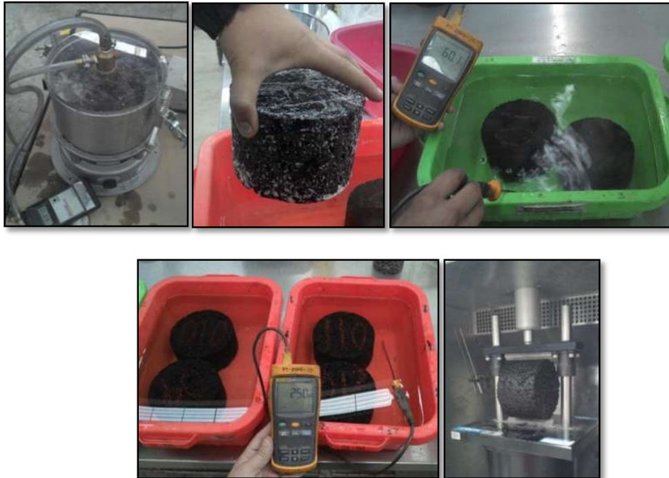
Figura 24 Acondicionamiento de especímenes para ensayo TSR.
