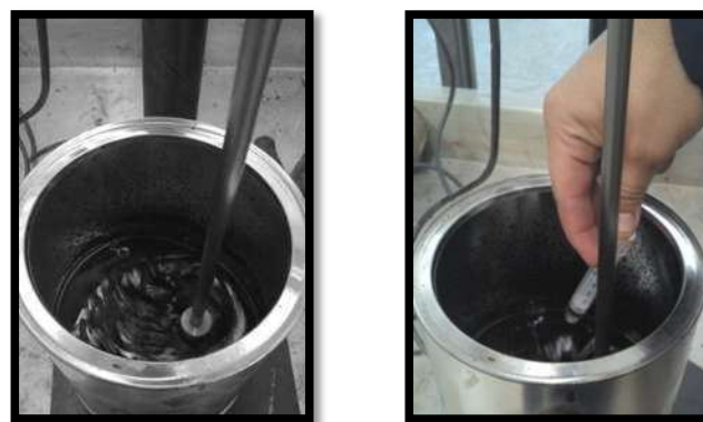
Figura 109 Incorporación del aditivo con el asfalto (Paso 3-4).
