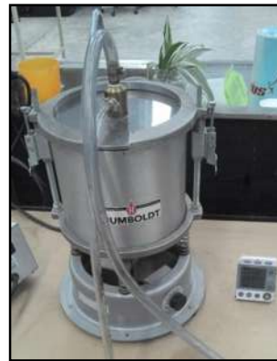
Figura 114 Separación de la mezcla asfáltica y lectura de su peso en el recipiente tarado, paso 1.
