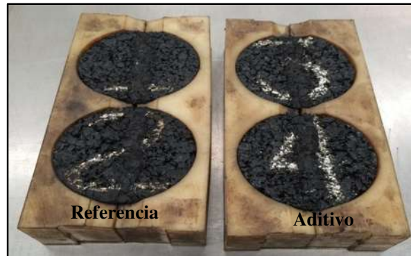
Figura 53 Especímenes de ensayo al finalizar la prueba en el APA.
