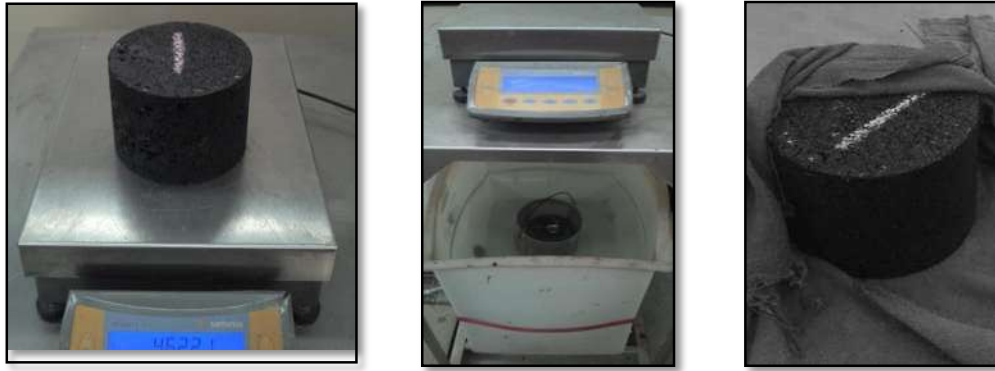
Figura 113 Determinación de las mediciones (peso seco, peso sumergido y saturado y superficialmente seco, paso 1-3).
