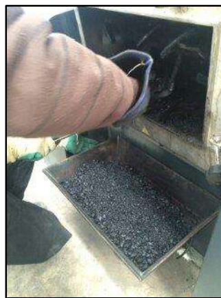
Figura 111 Mezclado de materiales y curado de la mezcla asfáltica, paso (2 y 3).
