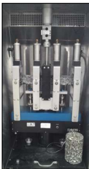
Figura 68 Espécimen de ensayo de fatiga, flexión en cuatro puntos.
