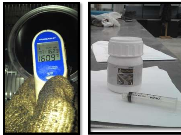
Figura 108 Incorporación del aditivo al asfalto (Paso 1-2).
