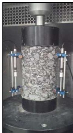
Figura 58 Núcleos de mezcla asfáltica en el ensayo de módulo dinámico.
