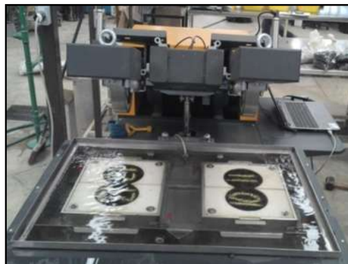
Figura 55 Acondicionamiento de especímenes en el equipo de prueba Rueda Cargada de Hamburgo.
