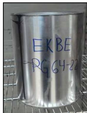
Figura 110 Acondicionamiento del agregado pétreo y material asfalto, paso (1).
