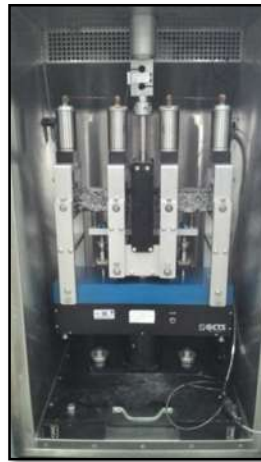
Figura 32 Equipo y especímenes de ensayo de fatiga en flexión en cuatro puntos.
