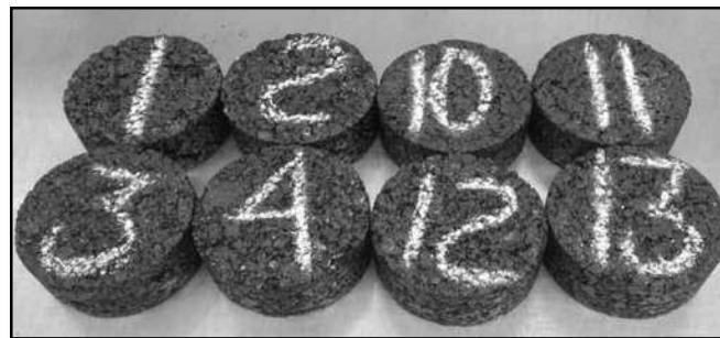
Figura 54 Especímenes de ensayo de deformación permanente a través del Analizador de Rueda Cargada de Hamburgo.
