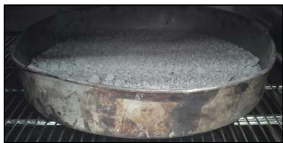
Figura 110 Acondicionamiento del agregado pétreo y material asfalto, paso (1).
