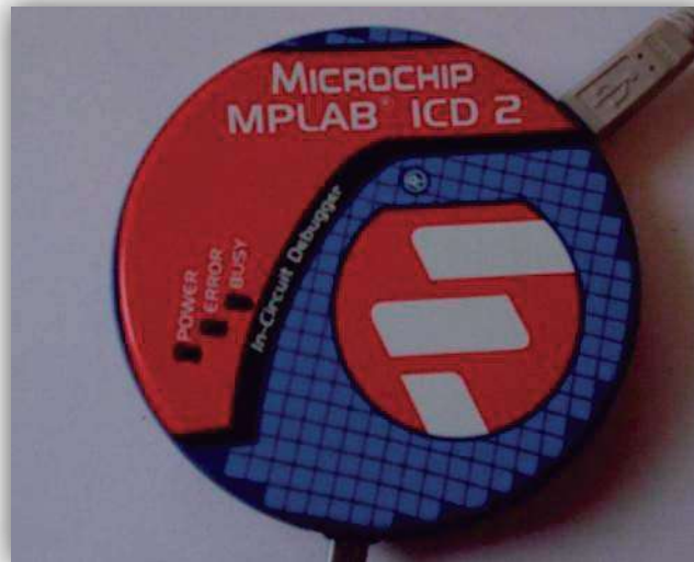
Fig. 2.3.8 MPLAB ICD-2 graba y depura en circuitos los dsPIC
