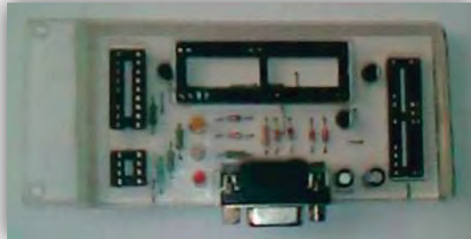
Fig. 2.3.1 Dispositivo para grabar el programa en el PIC
