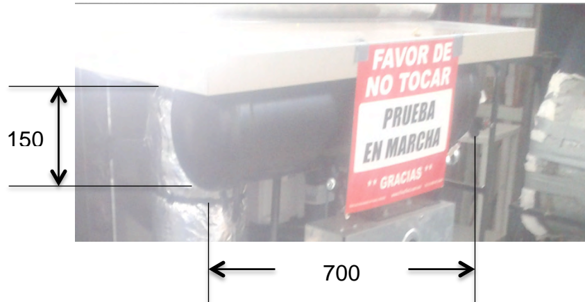
Figura 4-8. Dimensiones en milímetros del rectificador de la máquina ROBUR.
