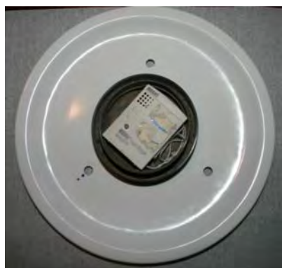
Figura 18. Data logger (HOBOS) dentro del dispositivo de protección
