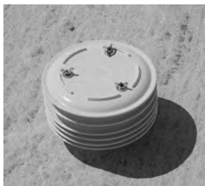
Figura 19. Dispositivo de protección colocado en azotea
