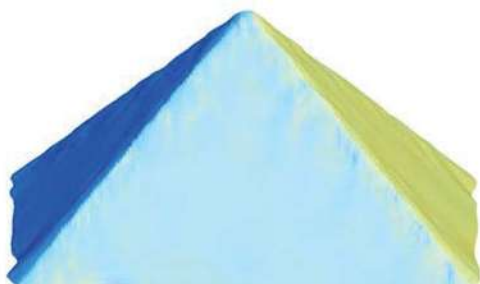
(a) Estimación de normales con el método de Hoppe et al.
