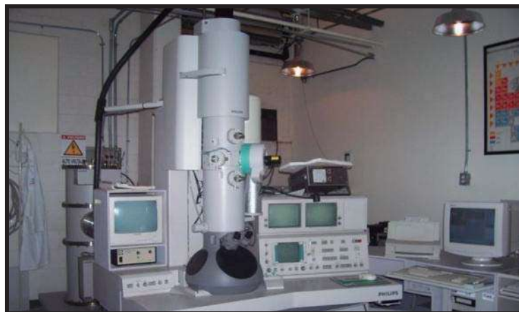
Figura 15. Microscopio Philips CM200 con filamentos de LaB 6
