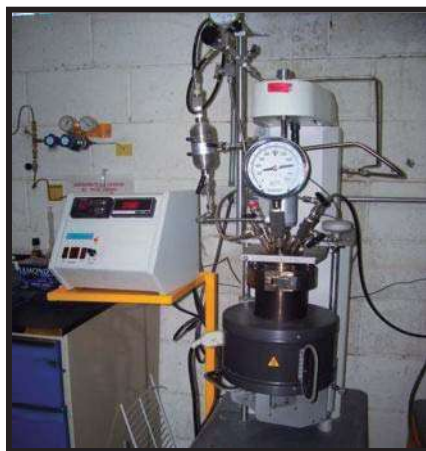
Figura 8. Reactor por lotes usado en la reacción de HDS e HDN en el laboratorio.
