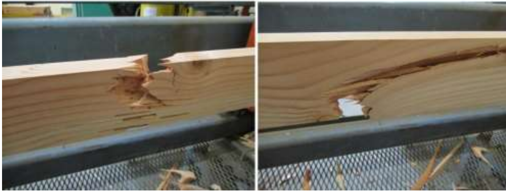
Imagen 41. Falla ensayo de tracción. 73
