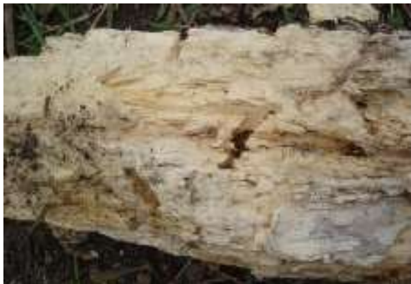
Imagen 44. Pudrición blanca avanzada en un pedazo de madera.
