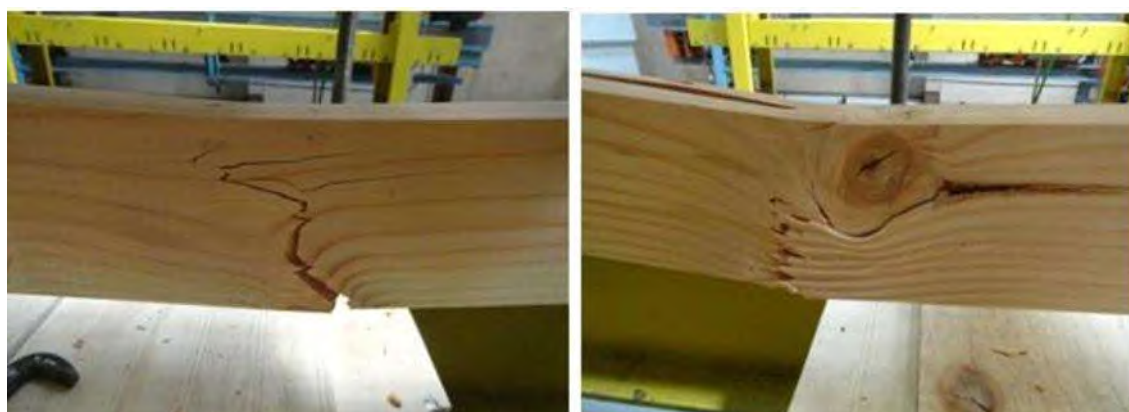
Imagen 40. Falla ensayo de flexión. 62
