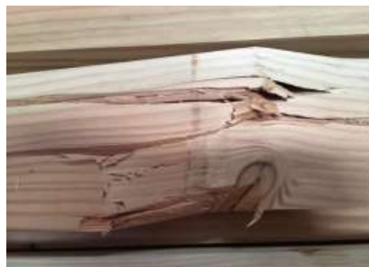
Imagen 39. Falla en ensayo de compresión paralela. 50
