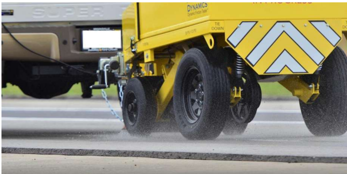
| Imagen 14. NAC Dynamic Friction Tester (DFT)™ Fuente: http://yazicilt.com . |
