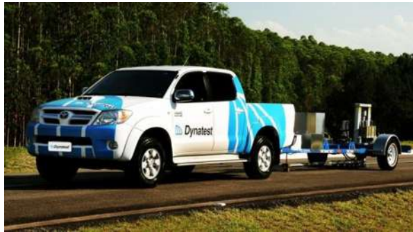
| Imagen 15. Falling Weight Deflectometer – FWD DYNATEST Fuente: http://dynatest.com |
