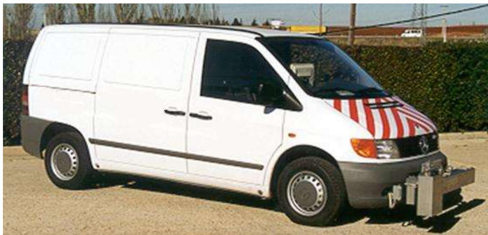
| Imagen 7. Perfilógrafo Laser. Fuente: http://es.wikipedia.org/wiki/%C3%8Dndice_de_regularidad_internacional |
