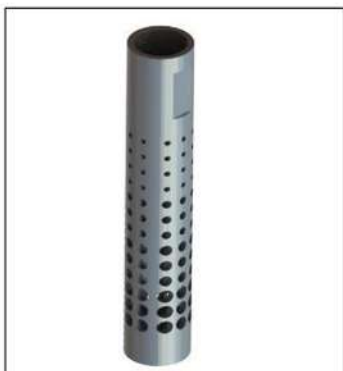
Figura 16. Patrón de orificios 1/8", 3/16", 1/4" y 5/16" de diámetro, cabezal base 20 cm.
