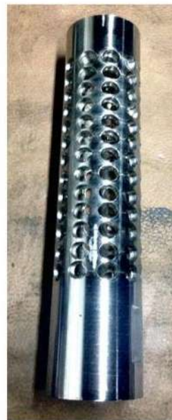
Figura 5 - Cabezal instalado en el punto de inyección de aire.
