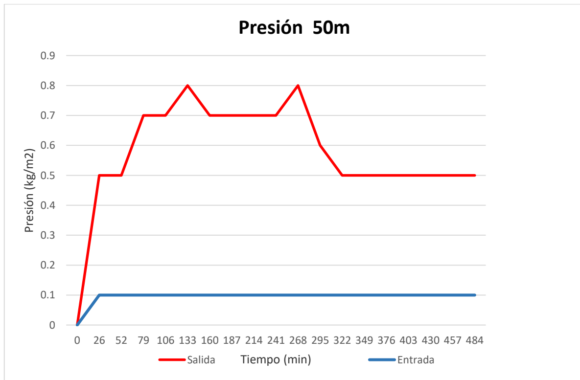
Figura 5.1. Presión a la entrada y salida del pozo geotérmico, empleando 50 m con el sistema air-lift .
