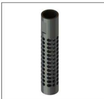
Figura 14. Patrón de orificios 3/16" de diámetro, cabezal de 20 cm.
