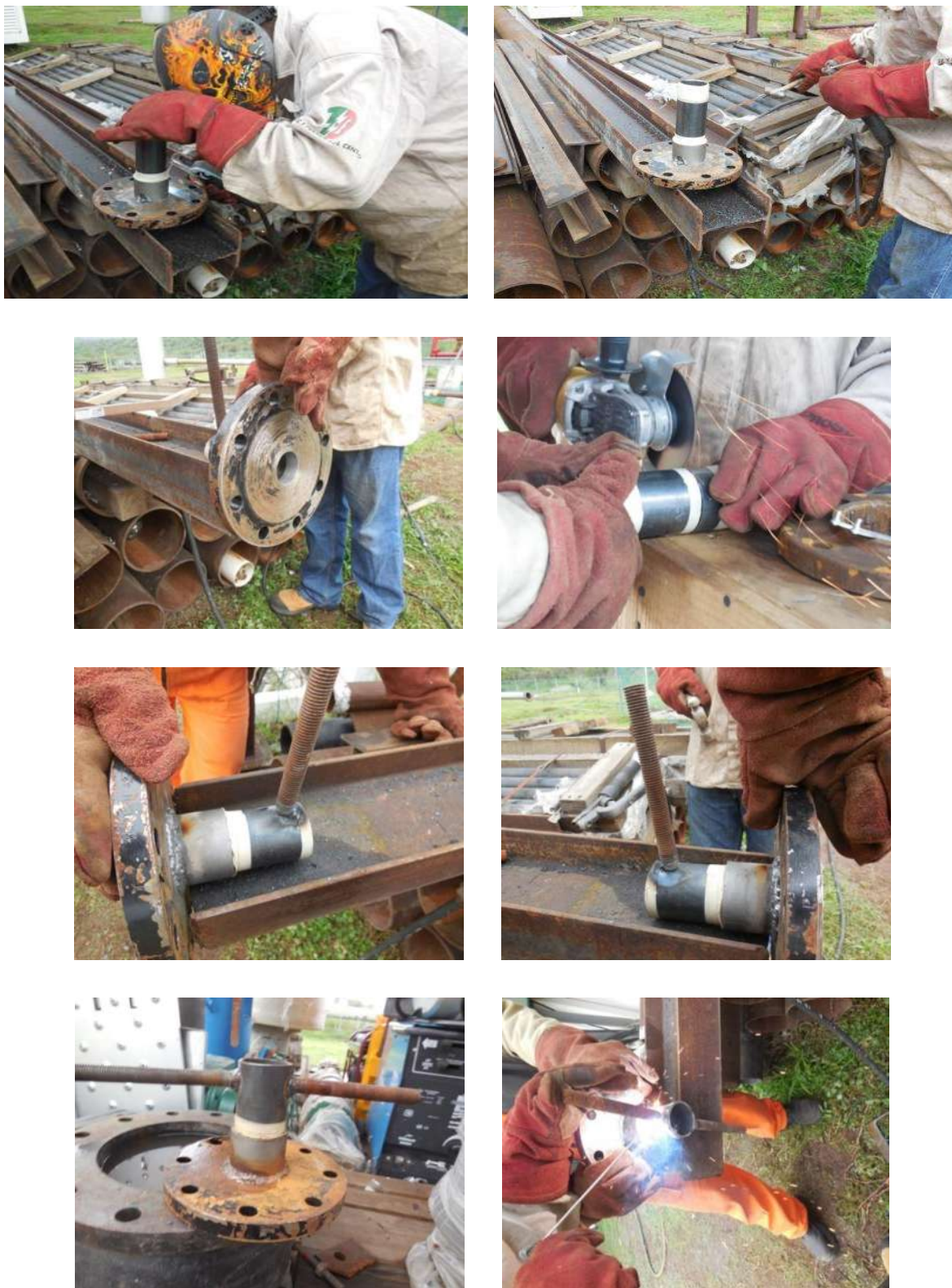
Figura 4.19. Construcción del prensaestopa (A).
