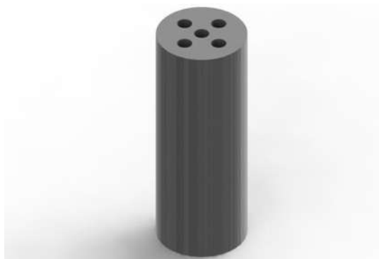
Figura 3.13. Patrón de orificios 1/4" de diámetro, cabezal de 10 cm.
