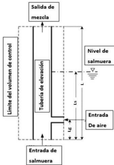
Figura 4 - Volumen de control del sistema Airlift en el que se muestran las secciones que lo conforman para su construcción.
