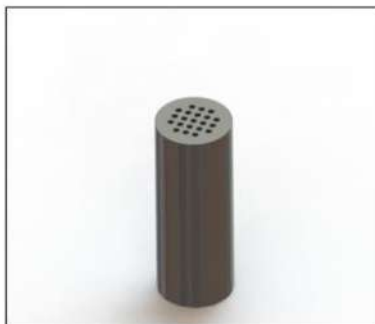
Figura 13. Patrón de orificios 1/8" de diámetro, cabezal de 10 cm.
