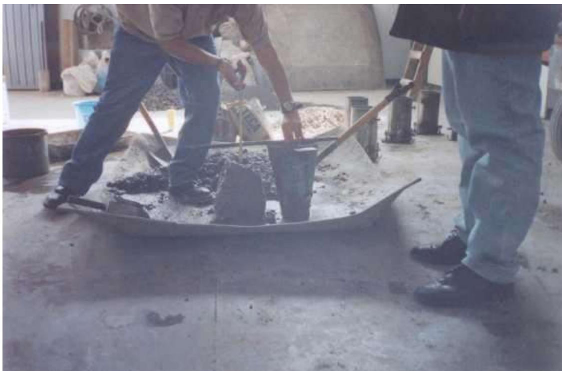
Figura 10. Determinación del revenimiento de las mezclas de concreto hidráulico.
