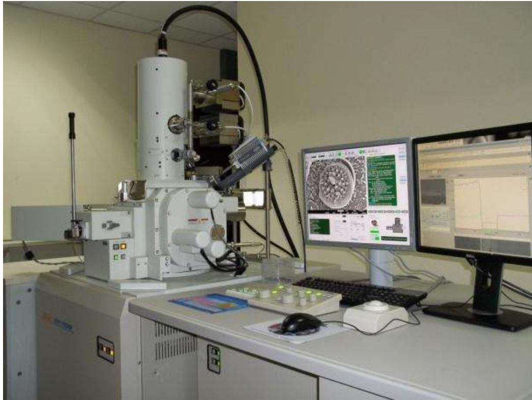
Figura 3.4. Microscopio de barrido FEG JEOL JSM-7600F.
