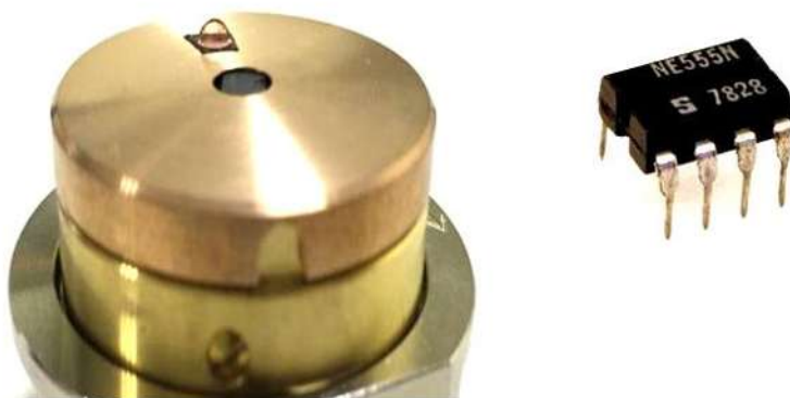
Figura 3.8. Montaje encapsulado circuito integrado NE555 en MEB.
