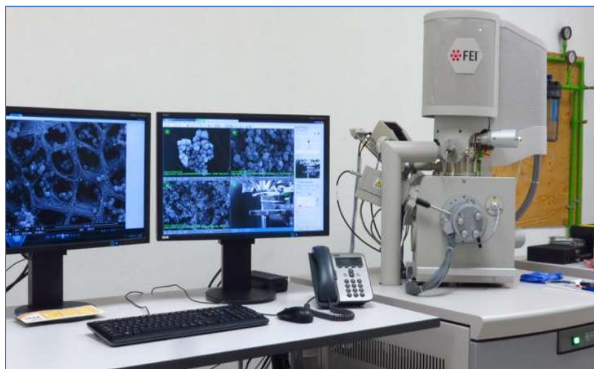
Figura 3.6. Microscopio Electrónico de Barrido FEI QUANTA-250.
