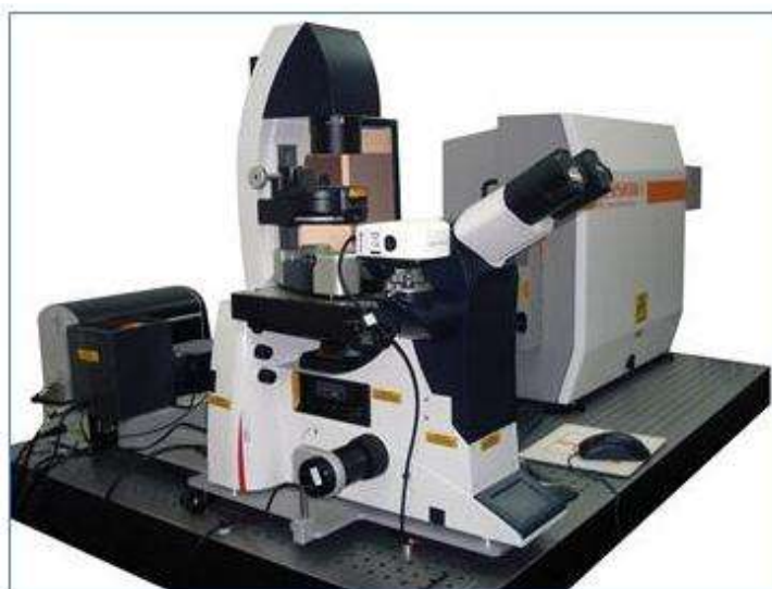
Figura 3.5. Espectrómetro Micro Raman RENISHAW inVia Raman Microsoft.
