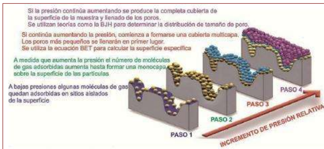
Figura B.2. Esquema de un análisis por fisisorción de Nitrógeno, tomada de la Norma International Standard ISO 15901-3 (2007).
