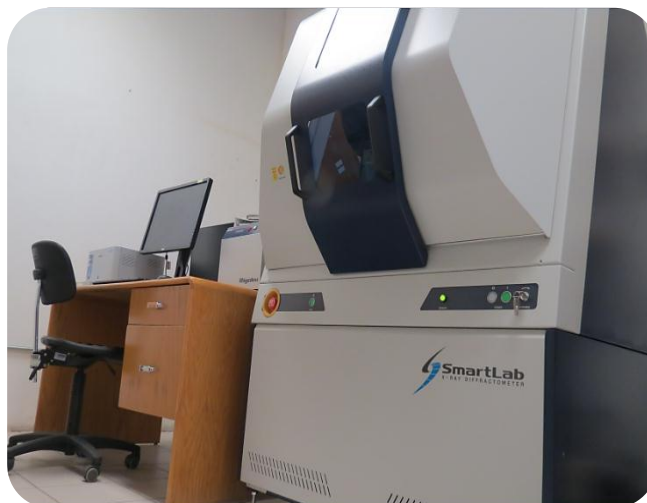
Figura 3.2. Difractómetro de Rayos X Rigaku SmartLab
