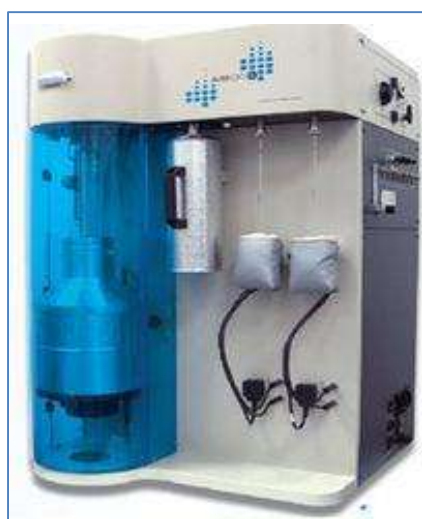
Figura 3.3. Equipo de Fisisorción de Nitrógeno NOVA 3200e.
