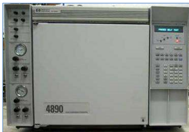
Figura 3.10. Cromatógrafo de Gases HP, modelo 4890.
