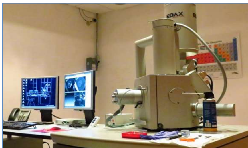
Figura 3.7. Microscopio Electrónico de Barrido FEI QUANTA-200.
