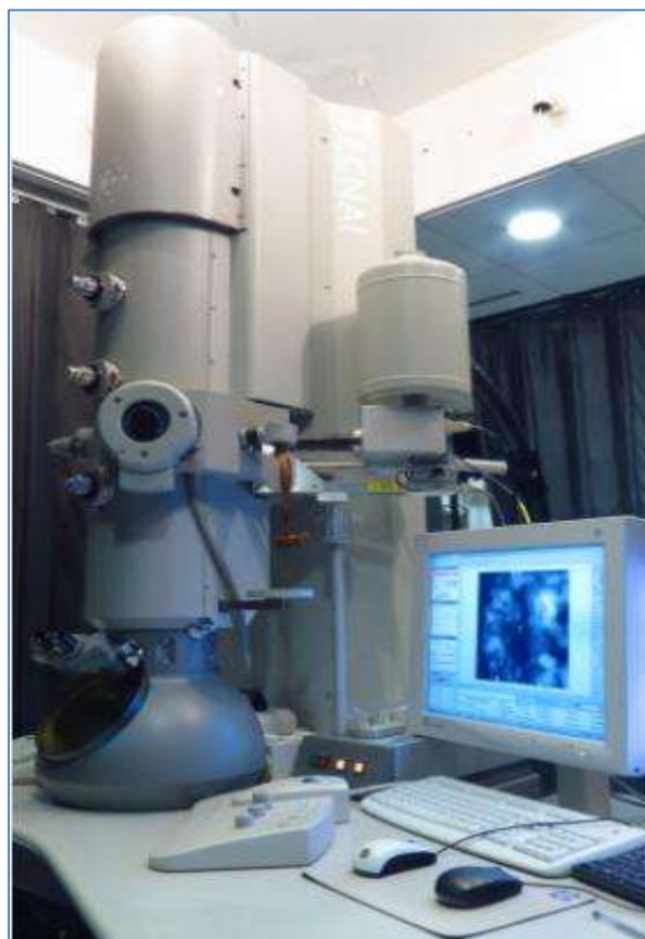
Figura 3.8. Microscopio Electrónico de Transmisión FEI F30.
