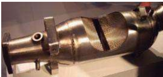
Figura E.2 Sección transversal de un convertidor de centro metálico.
