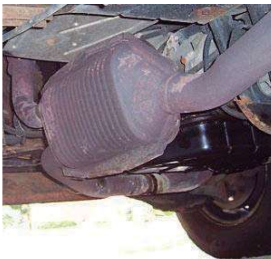
Figura E.1 Convertidor catalítico en una Dodge Ram Van.
