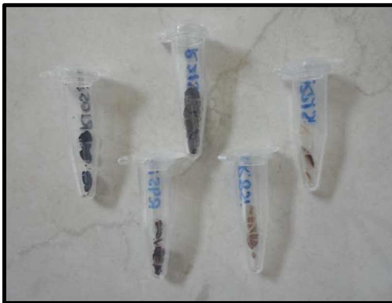
Figura 4.5. Tratamiento térmico de los monolitos de SiO_2 a 400°C.
