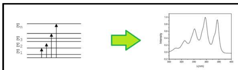
Figura 3. A5-11. Espectro de absorción característico de una muestra en espectrometría UV-vis.
