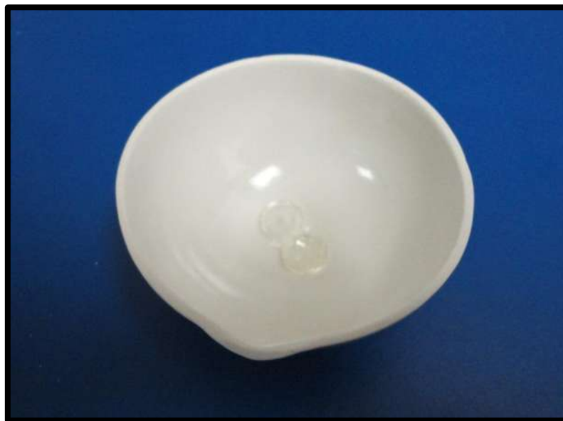
Figura 4.6. Tratamiento térmico de los monolitos de SiO_2 a 500°C.
