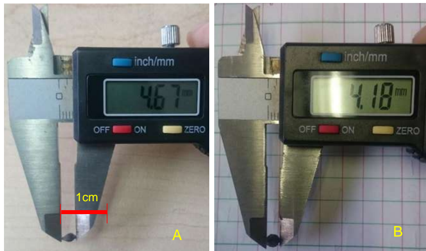
Figura 4. Medición de longitud (A) y diámetro (B) de semillas de C. elaeagnoides .
