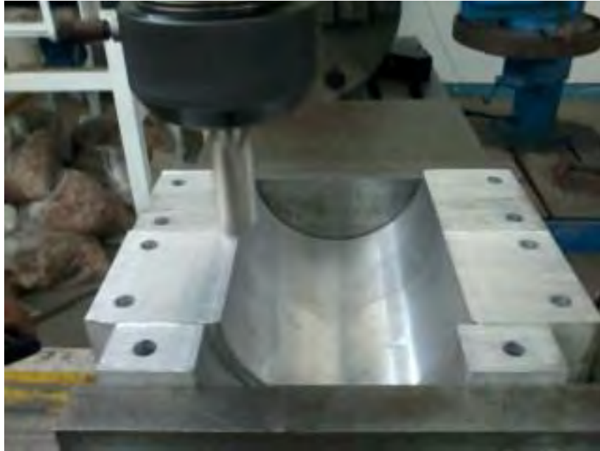
Fig. 4.4. Fresado de elementos de sujeción de la segunda columna.
