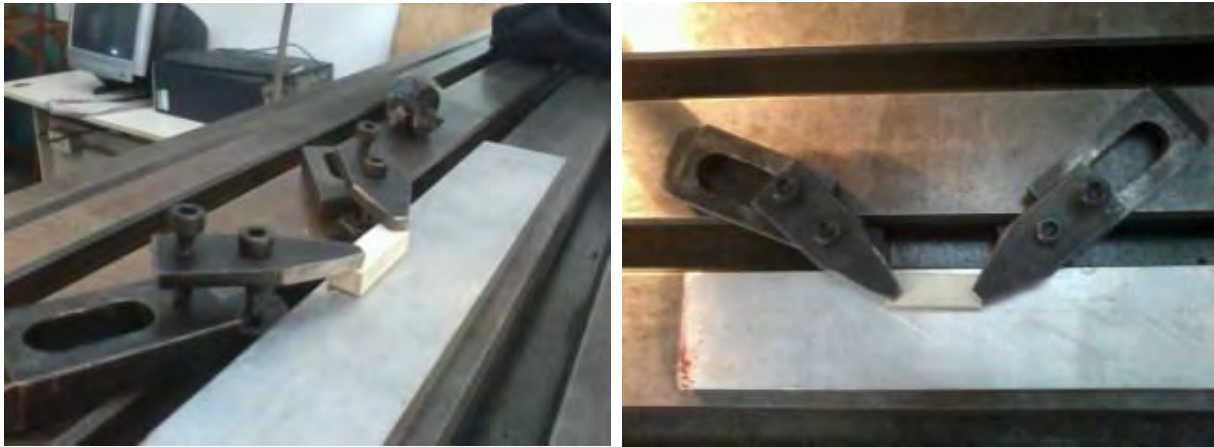
Fig. 3.8. Modo de sujeción para el maquinado de las probetas ABS.
