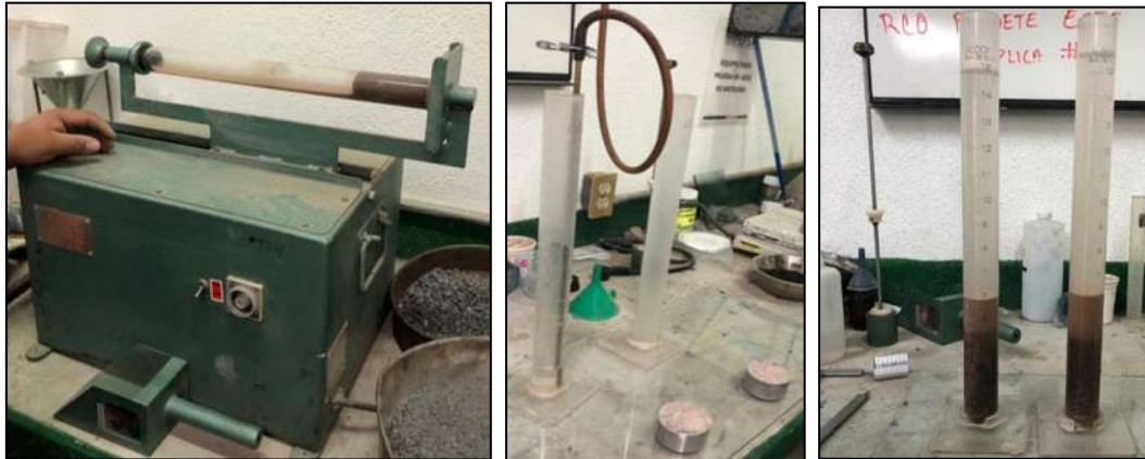
Figura V-34. Procedimiento de la prueba de equivalente de arena Fuente: Propia
