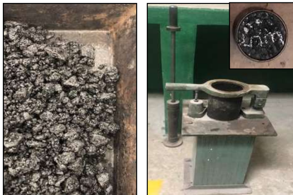
Figura V-49. Fabricación de muestras mediante la metodología Marshall
