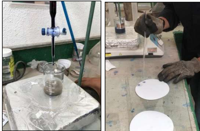
Figura V-35. Procedimiento de la prueba de valor de azul de metileno de una arcilla Fuente: Propia
