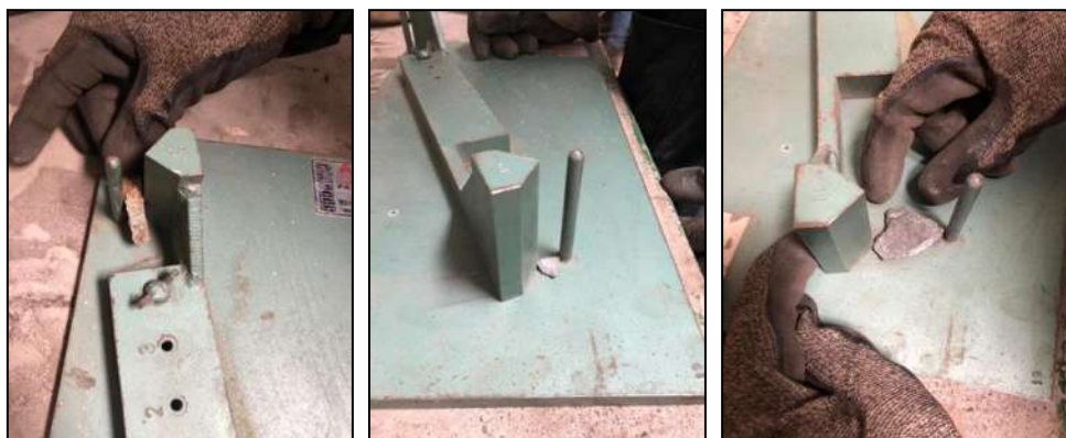
Figura V-30. Prueba para el porcentaje de partículas planas y alargadas del agregado grueso
