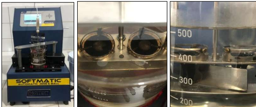
Figura V-38. Procedimiento de la prueba de punto de reblandecimiento
