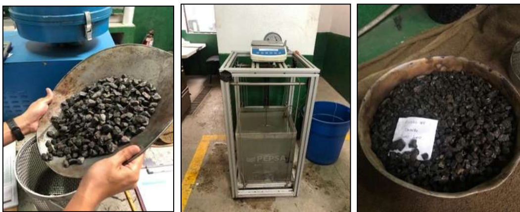
Figura V-25. Prueba de gravedad y absorción en agregado grueso Fuente: Propia
