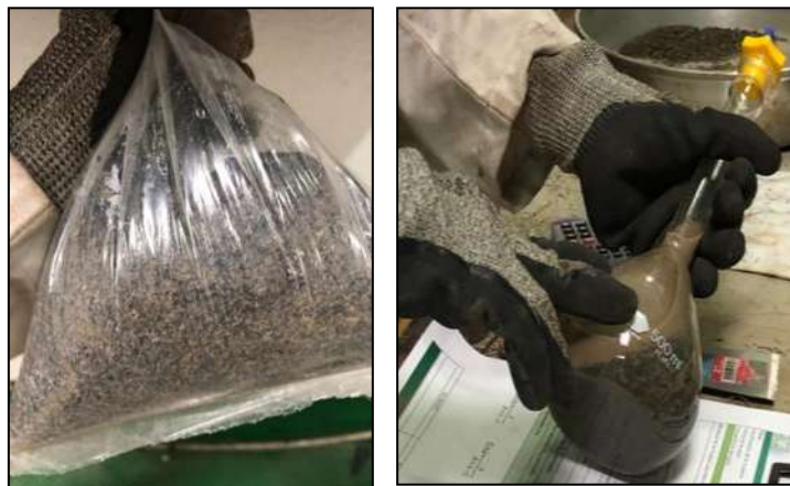
Figura V-26. Prueba de gravedad y absorción en el agregado fino
