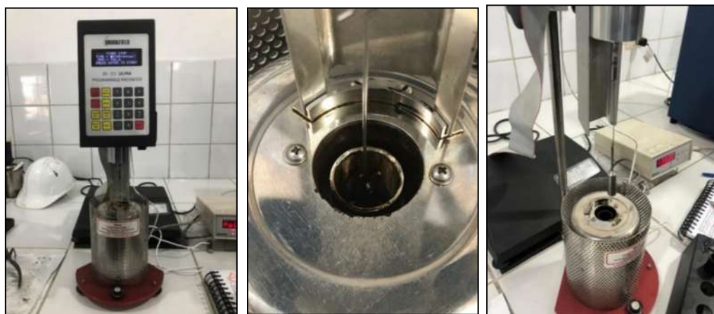
Figura V-37. Procedimiento de la prueba de viscosidad rotacional Brookfield
