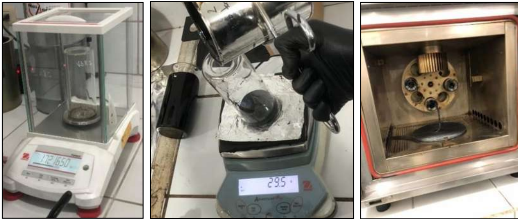
Figura V-40. Procedimiento de la prueba de envejecimiento del cemento asfáltico en horno rotatorio de película delgada (RTFO)
