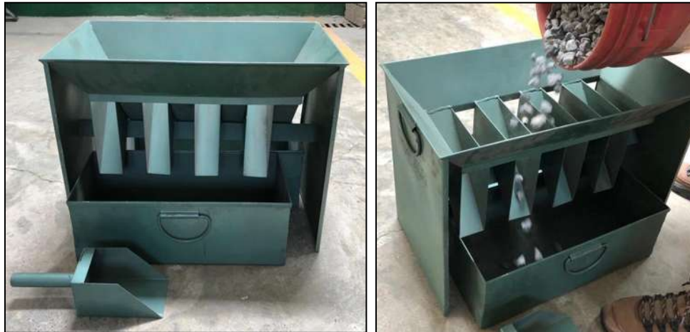
Figura V-20. Cuarteo (Separación Mecánica) Fuente: Propia
