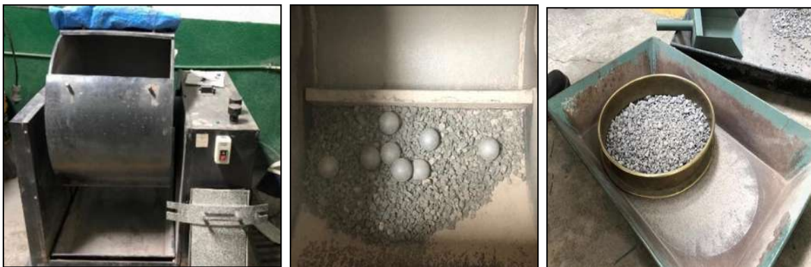
Figura V-27. Prueba de resistencia a la degradación por abrasión e impacto en la máquina de los ángeles
