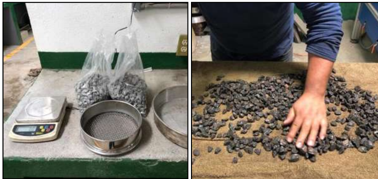
Figura V-31. Prueba para el porcentaje de partículas planas y alargadas del agregado grueso
