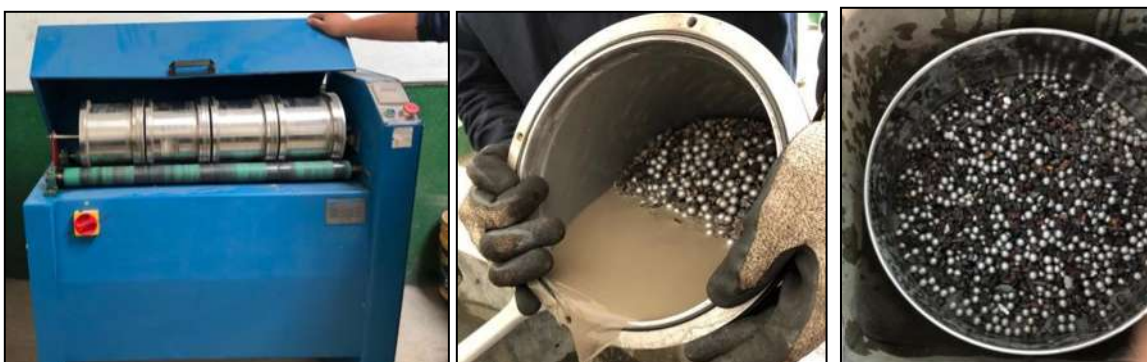
Figura V-28. Prueba de resistencia a la degradación por abrasión en la maquina Micro-Deval
