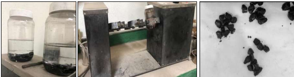
Figura V-32. Prueba para el desprendimiento por fricción en la fracción gruesa de materiales pétreo
