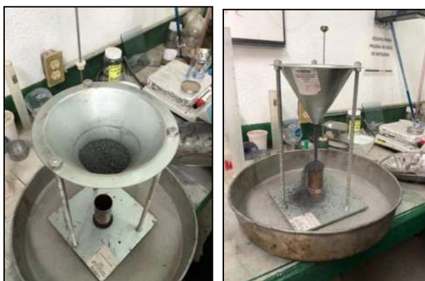
Figura V-33. Prueba del contenido de vacíos no compactados del agregado fino
