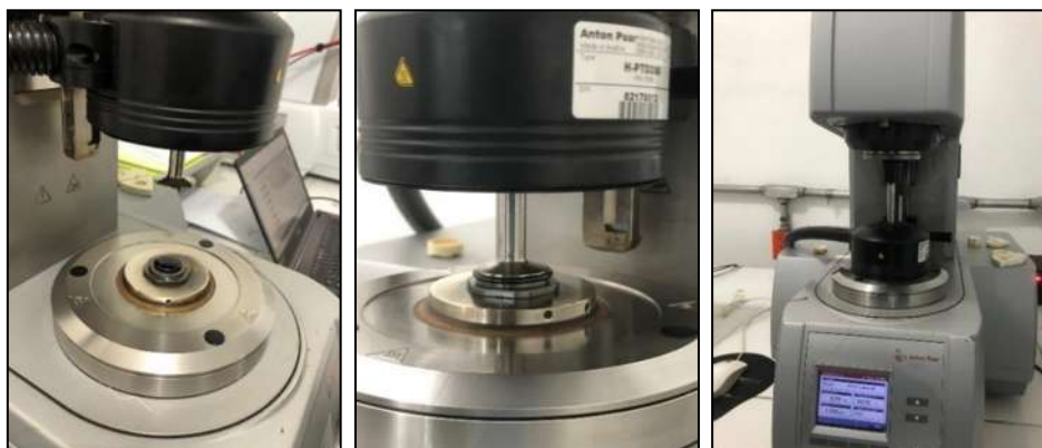
Figura V-39. Procedimiento de la prueba de módulo reológico de corte dinámico
