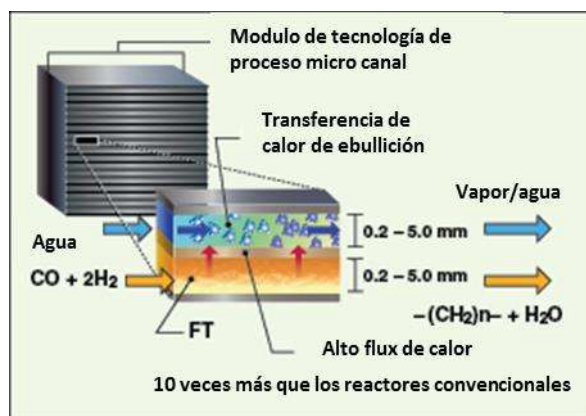
Figura 2.6 Esquema de un módulo de reacción de micro canal.
