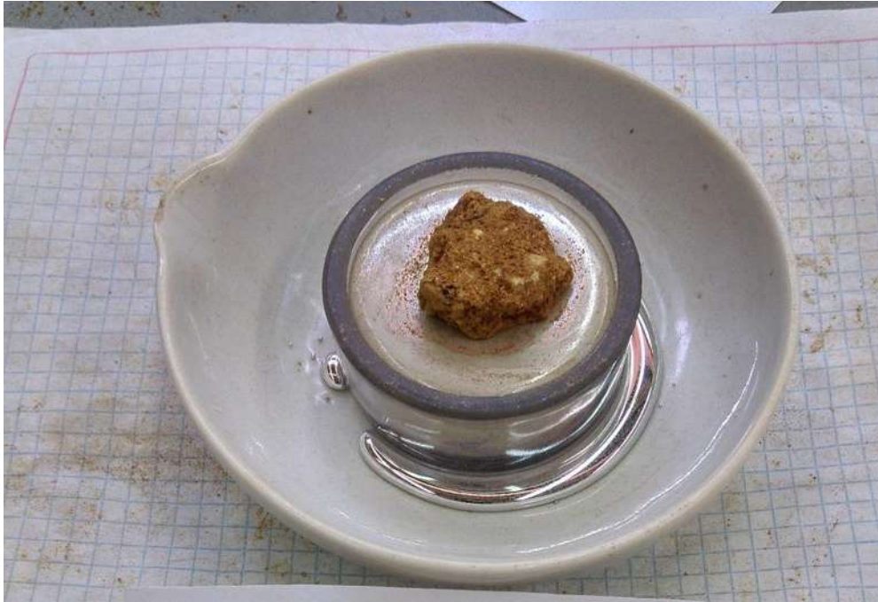
Figura 20.- Mercurio desalojado al momento de sumergir la pastilla de suelo. El PVHL se obtuvo de la siguiente manera
