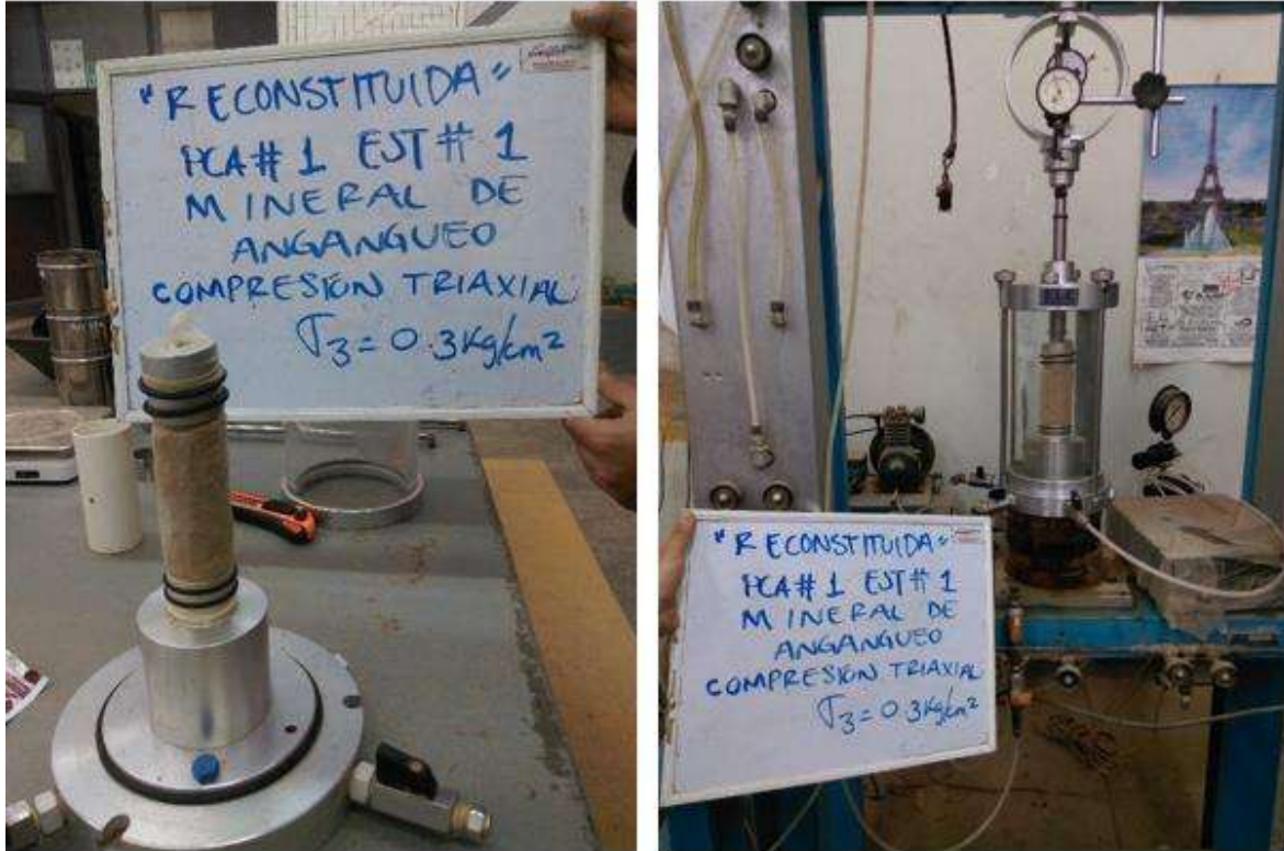
Figura 27.- En la parte izquierda preparación de la muestra para su ensayo triaxial y parte derecha muestra montada para la ejecución de la prueba.
