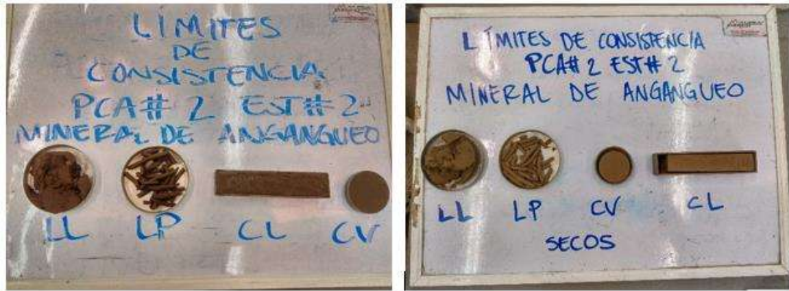
Figura 22.- Límites de consistencia Húmedos y secos.
