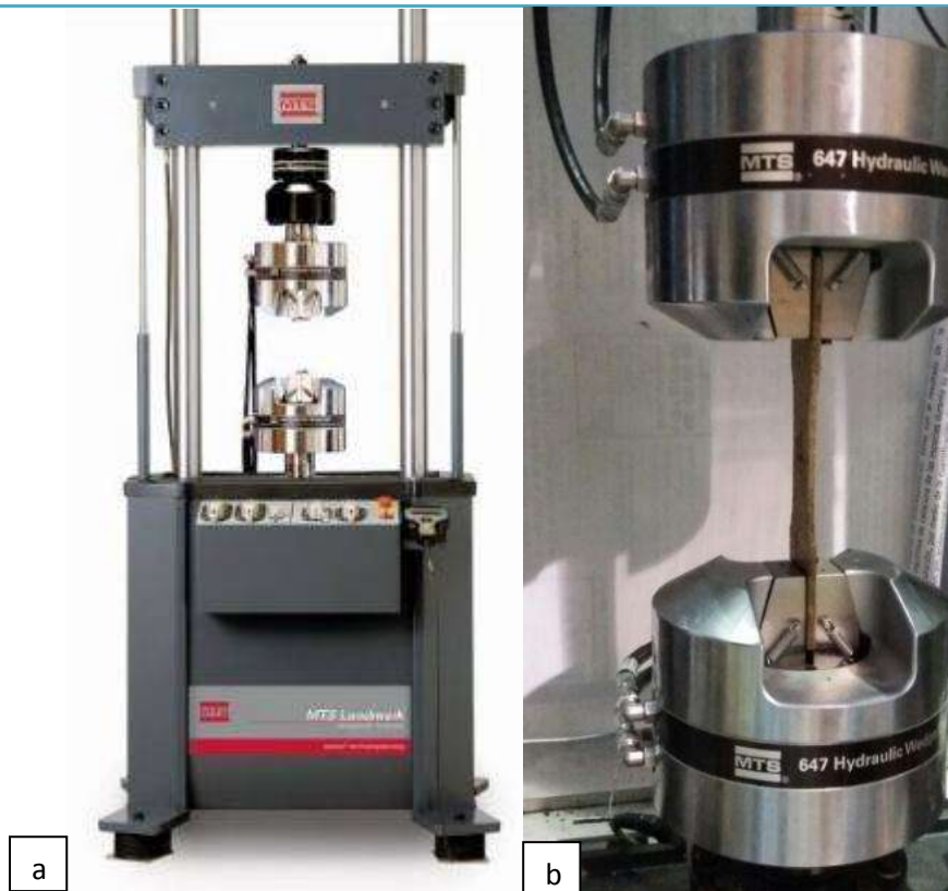
Figura XV. Máquina Universal instron. a) Presentación comercial. b) Calibración previo a realizar las pruebas de desprendimiento.
