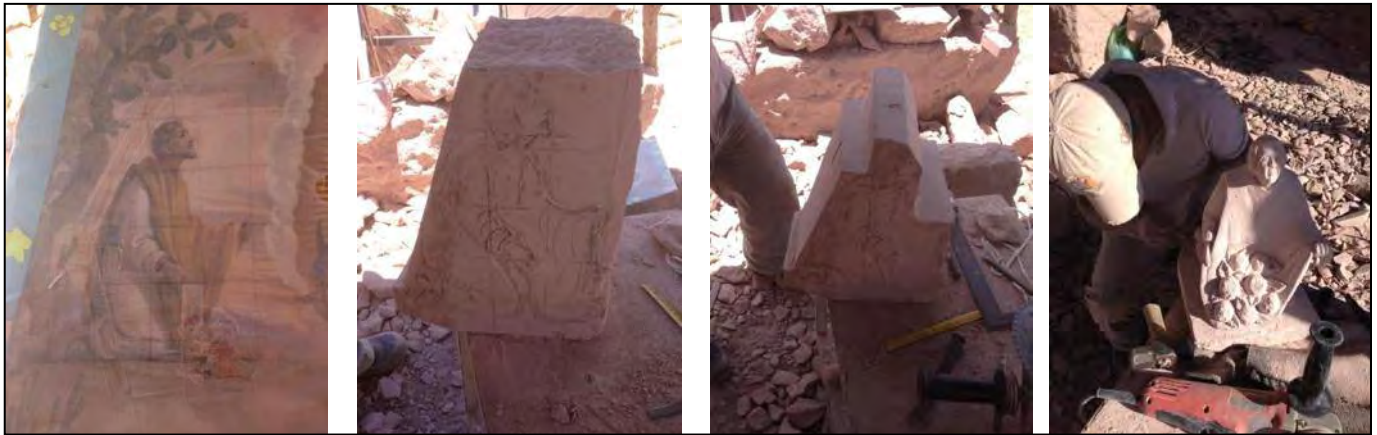
IMAGEN II.6.1.1.a.- Secuencia de izquierda a derecha, del proceso del trazo con cuadrícula, -con la finalidad de cuidar proporciones.
