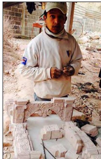
IMAGEN III.2.4.1.a.- El maestro verifica que la talla sea perfecta para lograr un óptimo ensamblaje. Fotografía de la autora, octubre del 2015.
