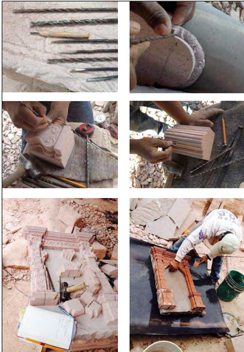
IMAGEN II.10.2.a.b.c.d.e.f.- Imágenes del terminado de la pieza, mediante el uso de cinceles delgados y afilados para darle precisión al detalle; así como la limpieza final de la piedra. Imágenes tomadas por la autora en marzo, abril, mayo y noviembre del 2015.
