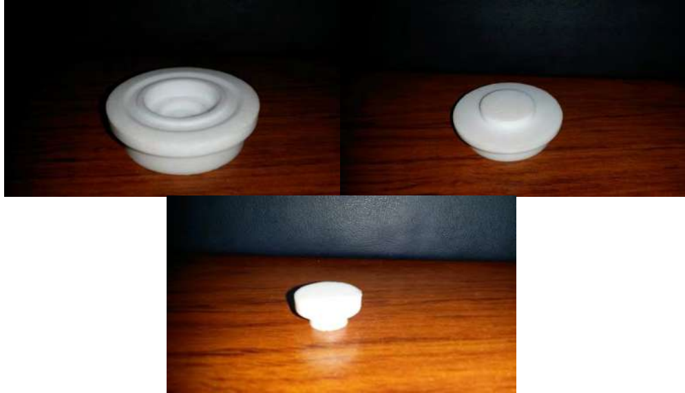
Figura 2. 11 Piezas terminadas del molde de teflón, maquinadas en torno.
