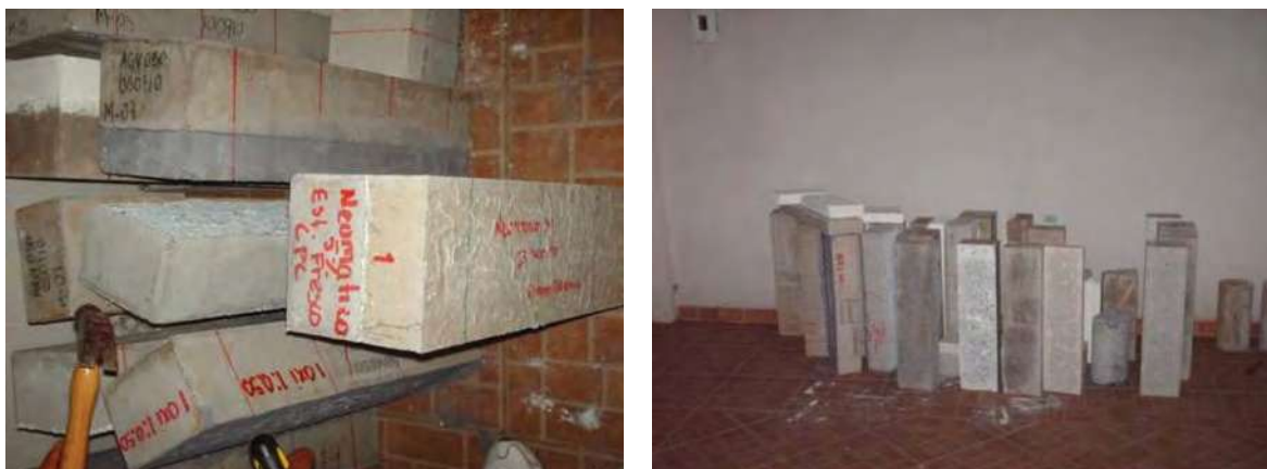
Fotografías 5.79. Vigas sometidas a esfuerzo de flexión.
