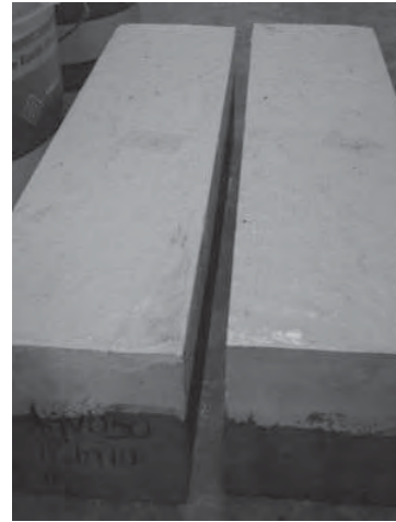
Fotografías 5.61 a y b. Desmolde y almacenamiento de la mezcla de Nanoconcreto GP – 33%MAR TI, 33%GR2-3, 30%TiO 2 , CH.
