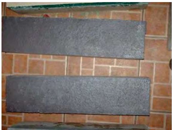
Fotografías 5.49 a, b y c. Desmolde y almacenamiento de especímenes de Nanoconcreto GP – 25%MAR TI, 25%GR2-3, 100%OXIFe, 7%AGUA CH, (grietas superficiales).
