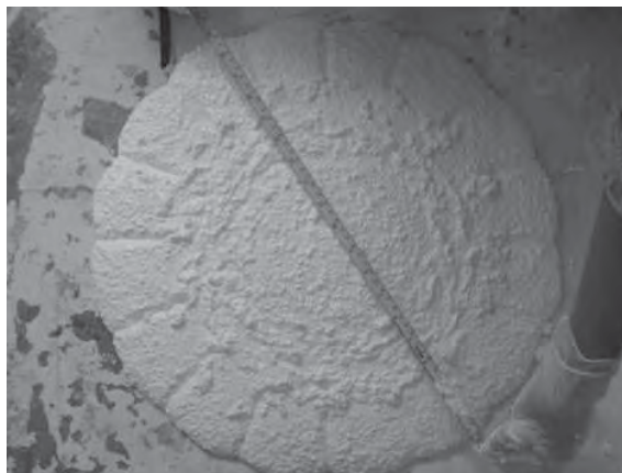
Fotografías 5.59 a, b, c, d, e y f. Medición del Revenimiento y Extensibilidad de la mezcla de Nanoconcreto GP – 33%MAR TI, 33%GR2-3, 30%TiO 2 , CH.
