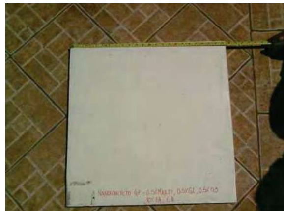
Fotografías 6.17 a y b respectivamente. Placa de Material Geopolimérico Estándar Con y Sin Fibra después de Intemperismo Ambiental.
