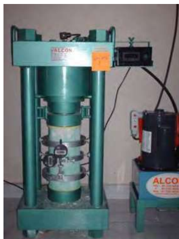
Fotografía 5-84 a, b y c. Preparación y medidas de las deformaciones en Especímenes ultra-thin de Concreto CPC y Nanoconcreto GP – 50%MAR TI, 50%GR2-3, CH
