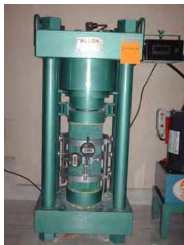
Fotografía 5.86 a, b y c. Preparación y medidas de las deformaciones en Especímenes ultra-thin de Concreto CPC y Nanoconcreto GP – 25%MAR TI, 25%GR2-3, 50%OXIFe, CH.
