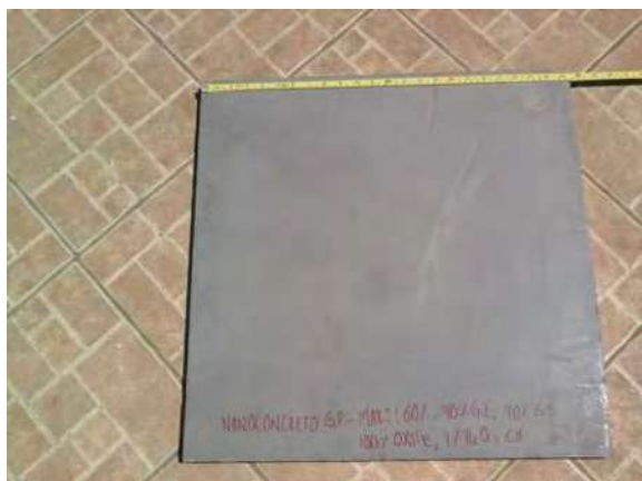
Fotografías 6.18 a y b respectivamente. Placa de Material Geopolimérico Magnético Con y Sin Fibra después de Intemperismo Ambiental.
