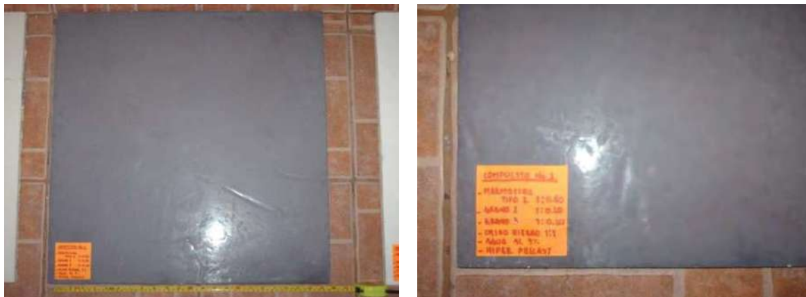
Fotografías 6.10 a y b respectivamente. Placa de Material Geopolimérico Magnético Sin Fibra antes de Intemperismo Ambiental.
