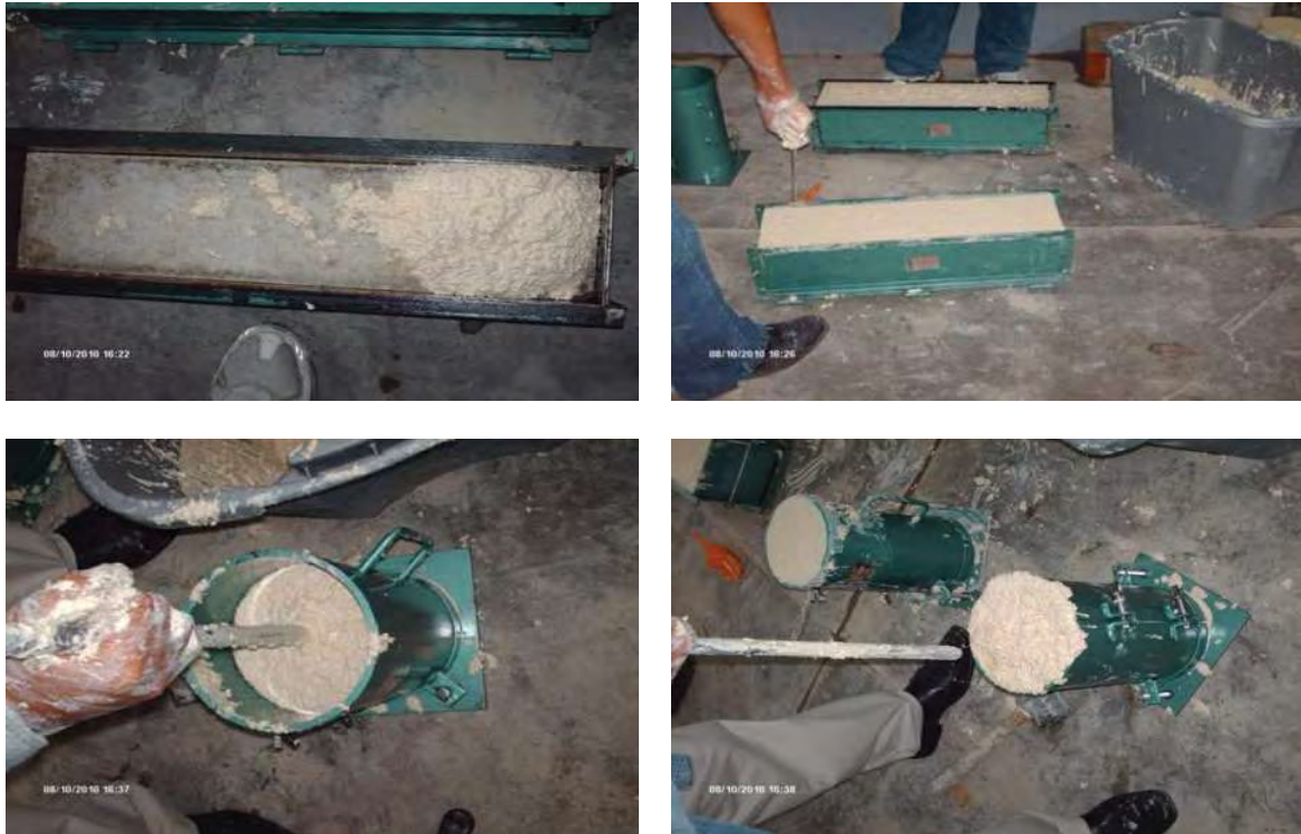
Fotografía 5.35. a, b, c y d respectivamente. Colado del Nanoconcreto GP – 50%MAR TI, 50%GR2-3, CH.
