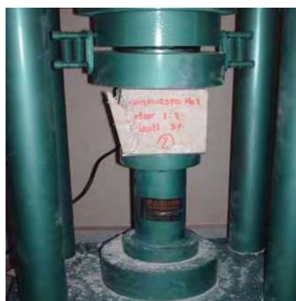
Fotografía 5.15. a y b. Determinación de la Resistencia a la Compresion del Nanoconcreto GP – 33%MAR TI, 33%GR2-3, 5%WOLLAS.
