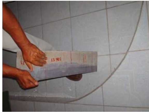
Fotografías 5.73. Prueba de Resistencia a Flexión en Especímenes ultra-thin compuesto de Nanoconcreto GP – 25%MAR TI, 25%GR2-3, 100%OXIFe, 7%AGUA, CH.
