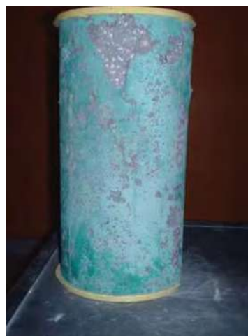
Fotografía 5.86 a, b y c. Preparación y medidas de las deformaciones en Especímenes ultra-thin de Concreto CPC y Nanoconcreto GP – 25%MAR TI, 25%GR2-3, 50%OXIFe, CH.
