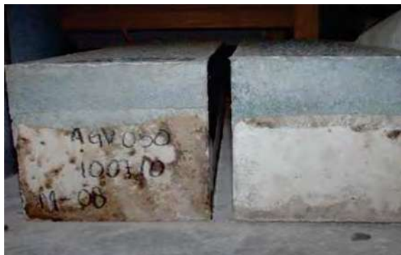
Fotografías 5.53 a, y b. Desmolde y almacenamiento de especímenes de Nanoconcreto GP – 33%MAR TI, 33%GR2-3, 5%NEU#80, CH.
