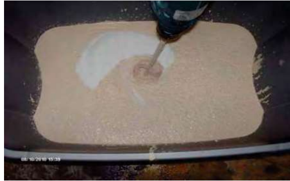
Fotografías 5.31. a y b. Preracion de moldes y elaboración de la mezcla de Nanoconcreto GP – 50%MAR TI, 50%GR2-3,CH.
