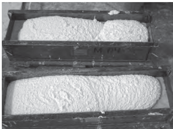
Fotografías 5.59 a, b, c, d, e y f. Medición del Revenimiento y Extensibilidad de la mezcla de Nanoconcreto GP – 33%MAR TI, 33%GR2-3, 30%TiO 2 , CH.
