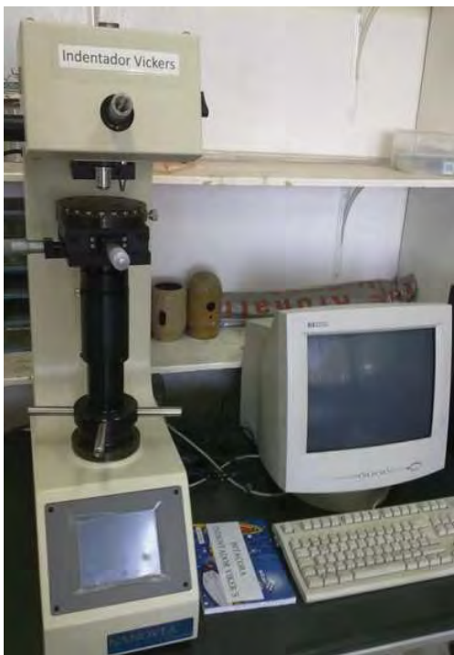
Fotografía 2.11. Indentador Vicker utilizado para la obtención de la dureza del material.
