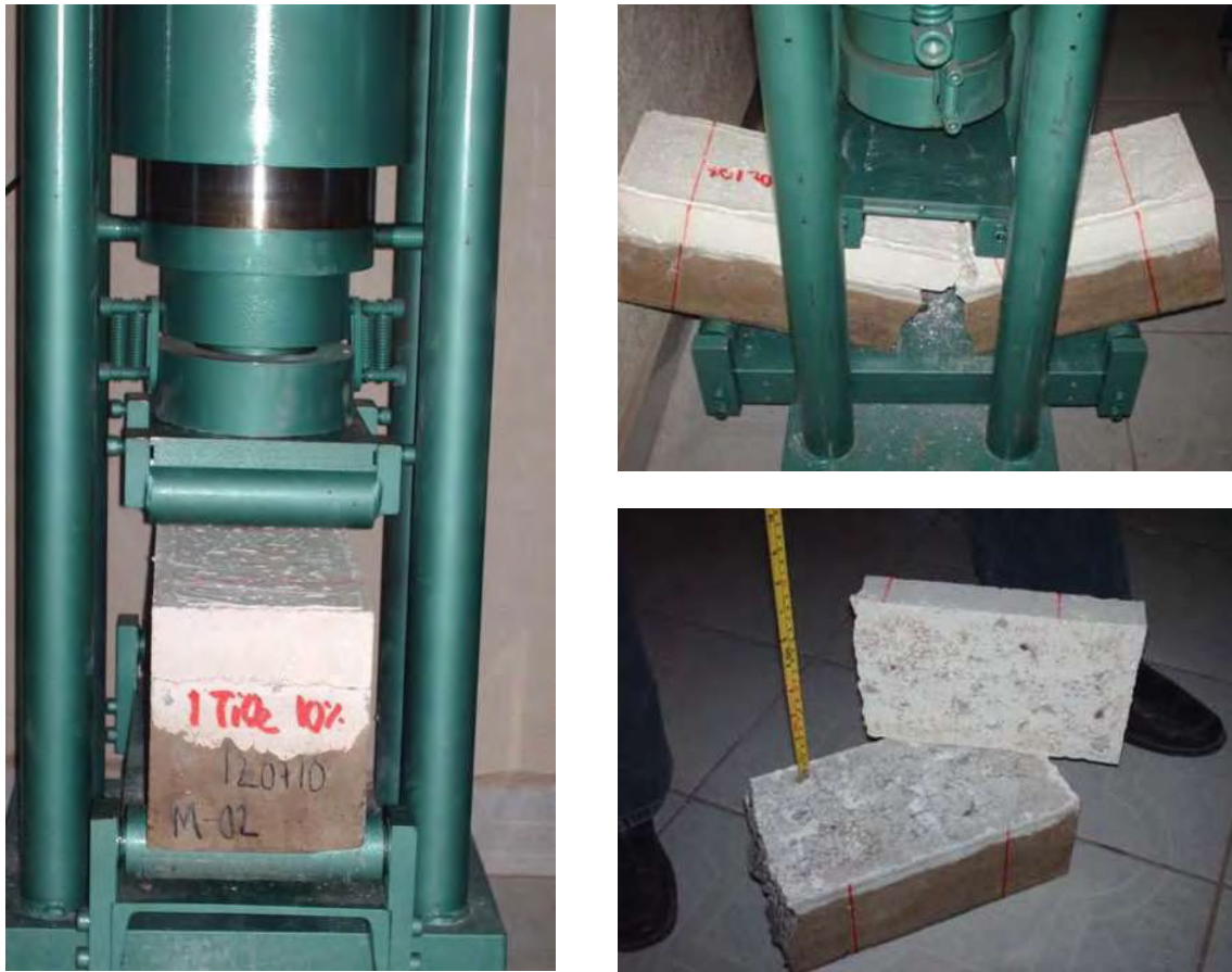
Fotografías 5.75. Prueba de Resistencia a Flexión en Especímenes ultra-thin compuesto de Nanoconcreto GP – 33%MAR TI, 33%GR2-3, 10%TiO 2 , CH.
