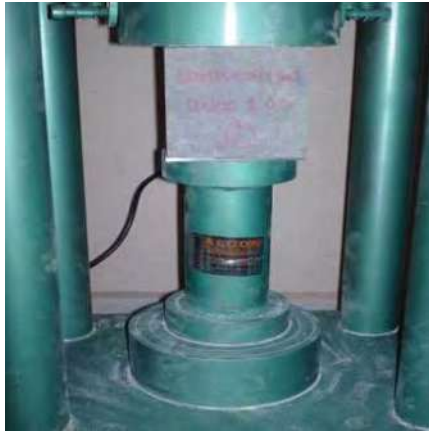
Fotografía 5.16. a y b. Determinación de la Resistencia a la Compresión del Nanoconcreto GP – 25%MAR TI, 25%GR2-3, 50%OXIFe.
