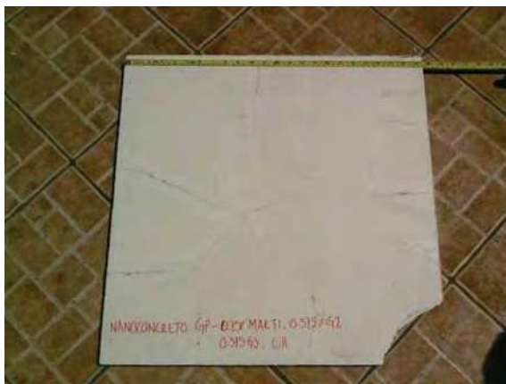
Fotografías 6.17 a y b respectivamente. Placa de Material Geopolimérico Estándar Con y Sin Fibra después de Intemperismo Ambiental.
