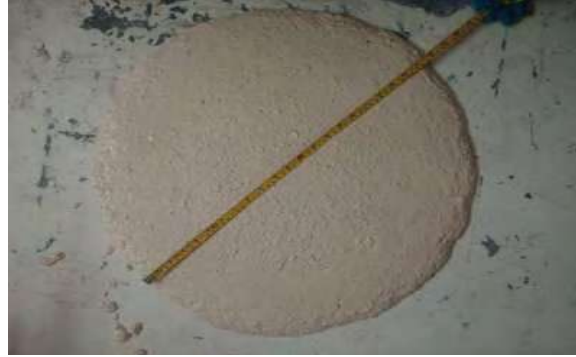
Fotografía 5.38. a, b, c, d, e y f respectivamente. Medición de la Extensibilidad y Revenimiento de la mezcla del Nanoconcreto GP – 33%MAR TI, 33%GR2-3, 5%WOLLAS, CH.
