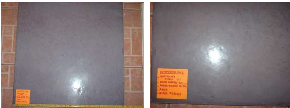
Fotografías 6.11 a y b respectivamente. Placa de Material Geopolimérico Magnético Con Fibra antes de Intemperismo Ambiental.
