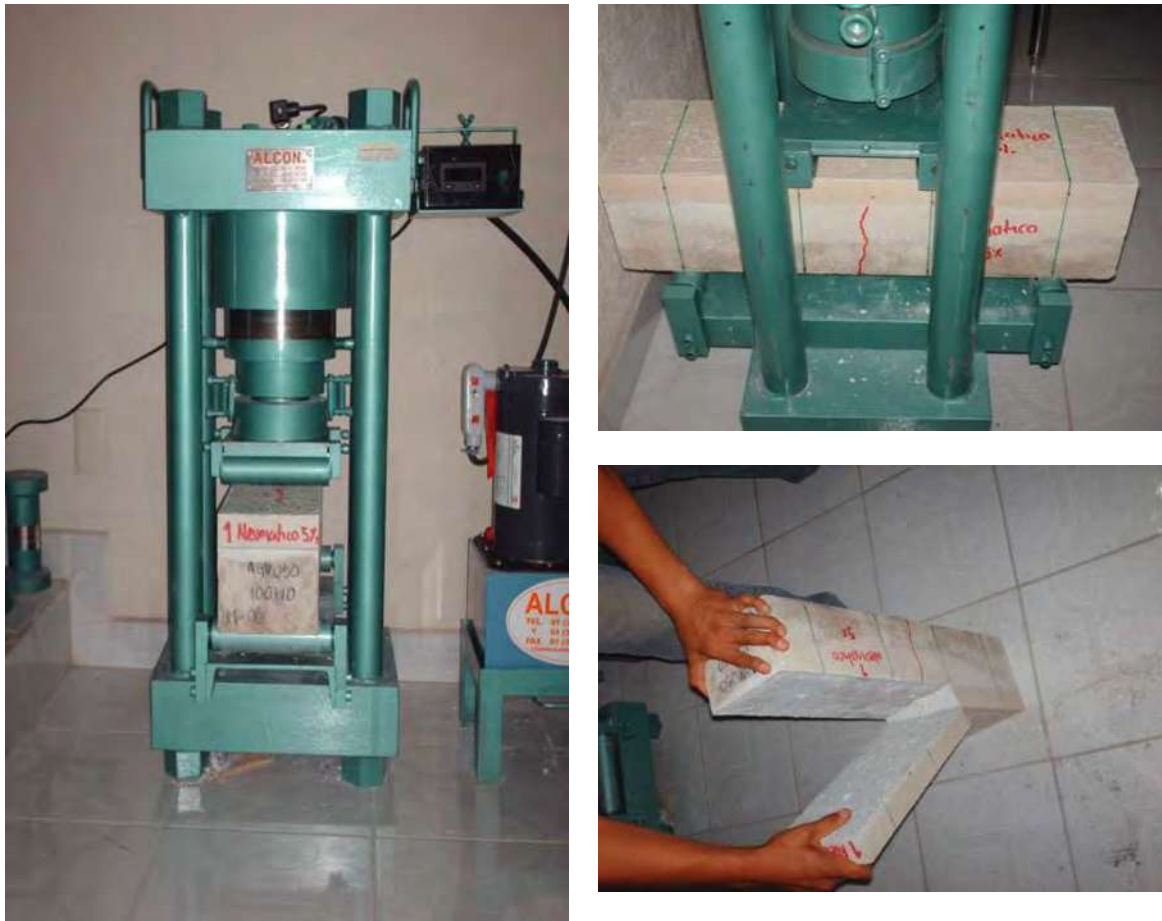
Fotografías 5.74. Prueba de Resistencia a Flexión en Especímenes ultra-thin compuesto de Nanoconcreto GP – 33%MAR TI, 33%GR2-3, 5%NEU#80, CH
