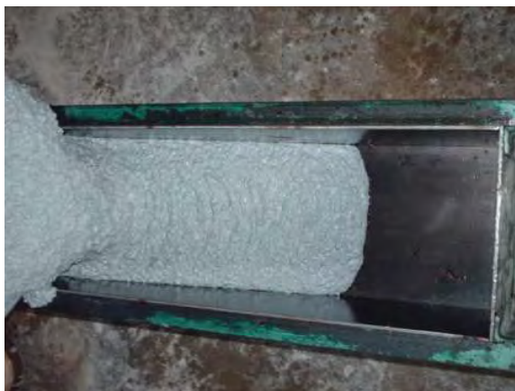
Fotografías 5.65 a y b. Elaboración y colado de la mezcla de Nanoconcreto GP – 50%MAR TI, 50%GR2-3, 5%NEU#80, CH de 15x15x60cm.
