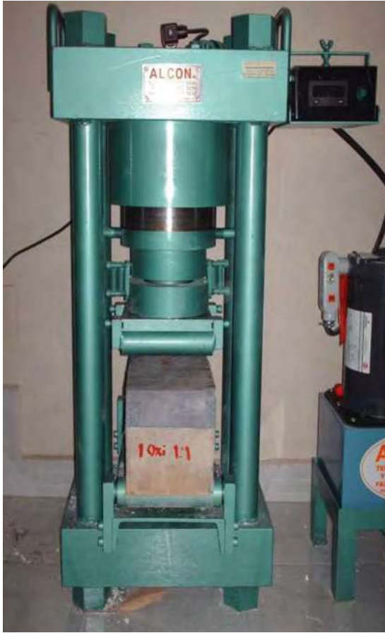
Fotografías 5.73. Prueba de Resistencia a Flexión en Especímenes ultra-thin compuesto de Nanoconcreto GP – 25%MAR TI, 25%GR2-3, 100%OXIFe, 7%AGUA, CH.
