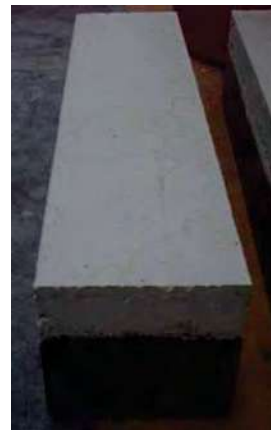
Fotografías 5.57 a y b. Desmolde y Almacenamiento de especímenes de Nanoconcreto GP – 33%MAR TI, 33%GR2-3, 10%TiO 2 , CH.
