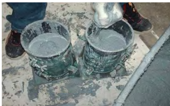
Fotografías 5.52 a, b, c y d. Colado de la mezcla de Nanoconcreto GP – 33%MAR TI, 33%GR2-3, 5%NEU#80, CH.
