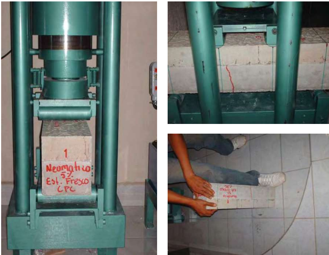
Fotografías 5.78. Prueba de Resistencia a Flexión en Especímenes ultra-thin compuesto de Nanoconcreto GP – 33%MAR TI, 33%GR2-3, 5%NEU#80, CH. (Estado Fresco).
