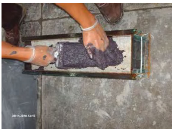
Fotografías 5.43 a, b, c, d, e y f. Medición del Revenimiento y Extensibilidad de la mezcla del Nanoconcreto GP – 25%MAR TI, 25%GR2-3, 100%OXIFe, 7%AGUA CH.
