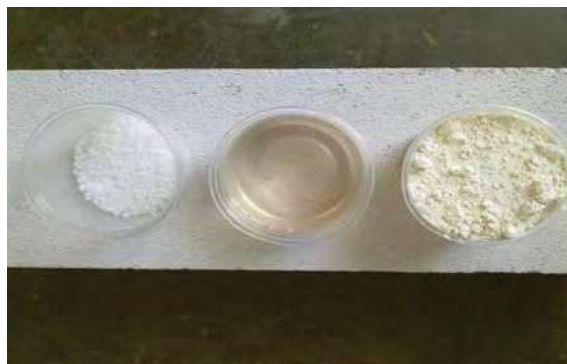
Fotografía 4.2. Nanopartículas de Sílice, hidróxido de potasio y óxido de aluminio para la conformación del nanocemento base.
