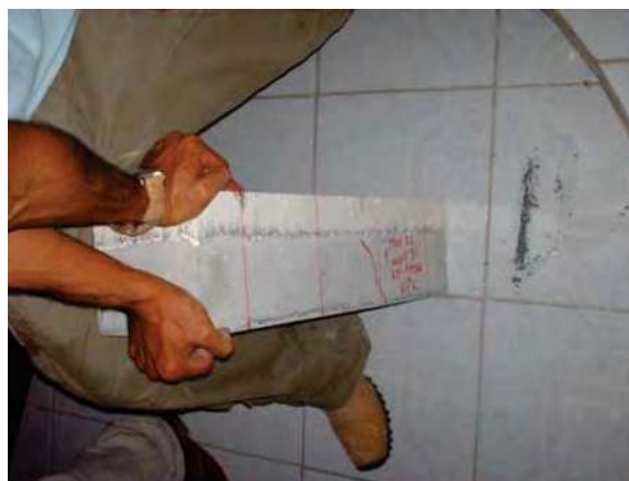
Fotografías 5.77. Prueba de Resistencia a Flexión en Espécímenes ultra-thin compuesto de Nanoconcreto GP – 33%MAR TI, 33%GR2-3, 5%WOLLAS, CH.
