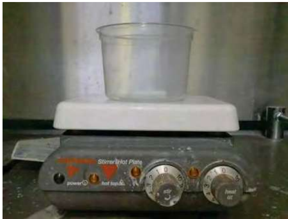
Fotografía 4.3. Mezcla de la solución alcalina en agitador magnético.
