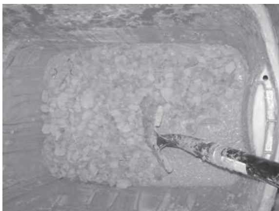
Fotografías 5.65 a y b. Elaboración y colado de la mezcla de Nanoconcreto GP – 50%MAR TI, 50%GR2-3, 5%NEU#80, CH de 15x15x60cm.
