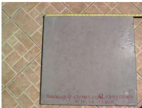
Fotografías 6.18 a y b respectivamente. Placa de Material Geopolimérico Magnético Con y Sin Fibra después de Intemperismo Ambiental.
