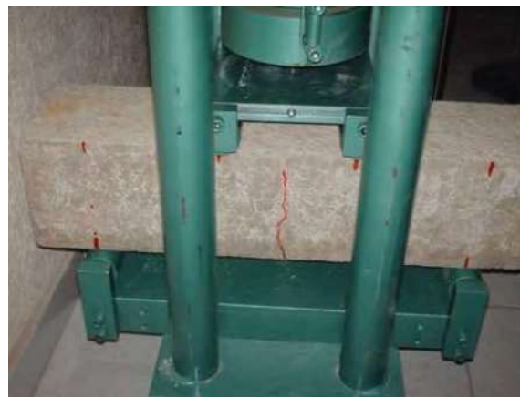
Fotografías 5.69. Prueba de Resistencia a Flexión en Especímenes de Concreto elaborado con CPC.
