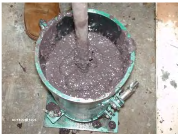
Fotografías 5.48 a, b, c y d. Colado de la mezcla del Nanoconcreto GP – 25%MAR TI, 25%GR2-3, 100%OXIFe, 7%AGUA CH.
