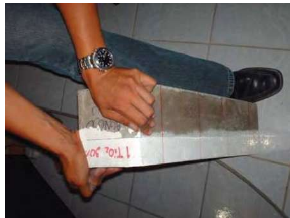
Fotografías 5.76. Prueba de Resistencia a Flexión en Especímenes ultra-thin compuesto de Nanoconcreto GP – 33%MAR TI, 33%GR2-3, 30%TiO 2 , CH.
