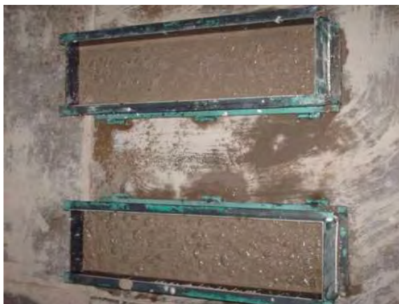
Fotografías 5.62 a y b. Elaboración y colado de la mezcla de concreto con CPC en dimensiones de 10x15x60 cm.
