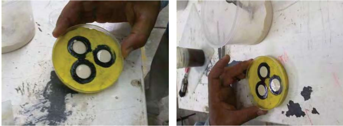
Fotografía 2.8. a y b. Preparacion de muestras para caracterizacion a través de IES.
