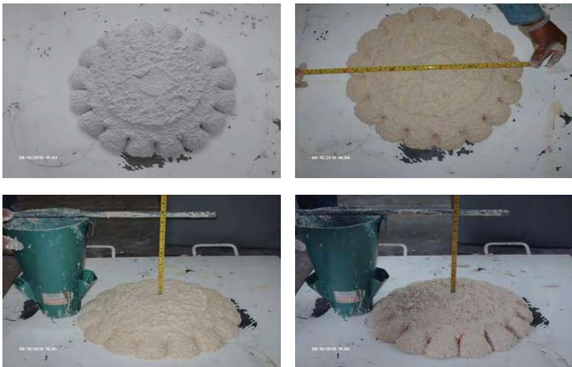
Fotografía 5.34. a, b, c, d e, f, g respectivamente. Medición de la Extensibilidad y Revenimiento en Nanoconcreto GP – 50%MAR TI, 50%GR2-3,CH.
