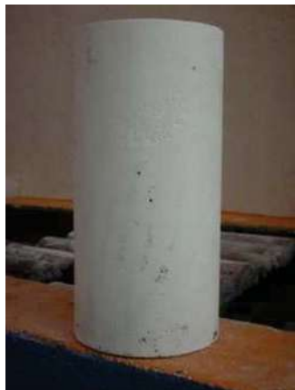
Fotografías 5.57 a y b. Desmolde y Almacenamiento de especímenes de Nanoconcreto GP – 33%MAR TI, 33%GR2-3, 10%TiO 2 , CH.
