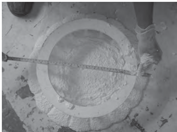
Fotografías 5.59 a, b, c, d, e y f. Medición del Revenimiento y Extensibilidad de la mezcla de Nanoconcreto GP – 33%MAR TI, 33%GR2-3, 30%TiO 2 , CH.
