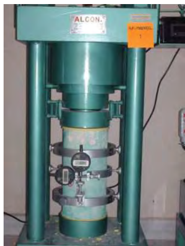
Fotografía 5.85 a, b y c. Preparación y medidas de las deformaciones en Especímenes ultra-thin de Concreto CPC y Nanoconcreto GP – 33%MAR TI, 33%GR2-3, 5%WOLLAS, CH.
