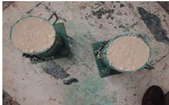
Fotografía 5.39. a, b, c y d respectivamente. Colado de la mezcla del Nanoconcreto GP – 33%MAR TI, 33%GR2-3, 5%WOLLAS, CH.
