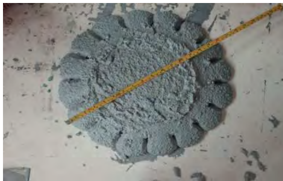
Fotografías 5.51 a, b, c, d y f. Medición del Revenimiento y Extensibilidad de la mezcla de Nanoconcreto GP – 33%MAR TI, 33%GR2-3, 5%NEU#80, CH.
