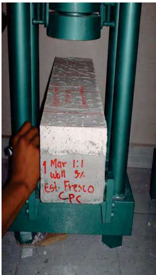
Fotografías 5.77. Prueba de Resistencia a Flexión en Espécímenes ultra-thin compuesto de Nanoconcreto GP – 33%MAR TI, 33%GR2-3, 5%WOLLAS, CH.
