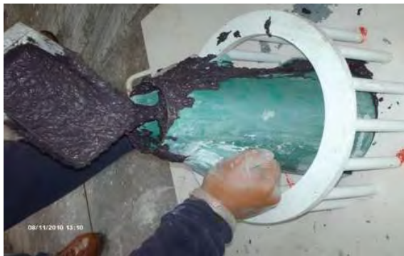
Fotografías 5.42 a y b. Elaboración de la mezcla del Nanoconcreto GP – 25%MAR TI, 25%GR2-3, 100%OXIFe, 7%AGUA CH.
