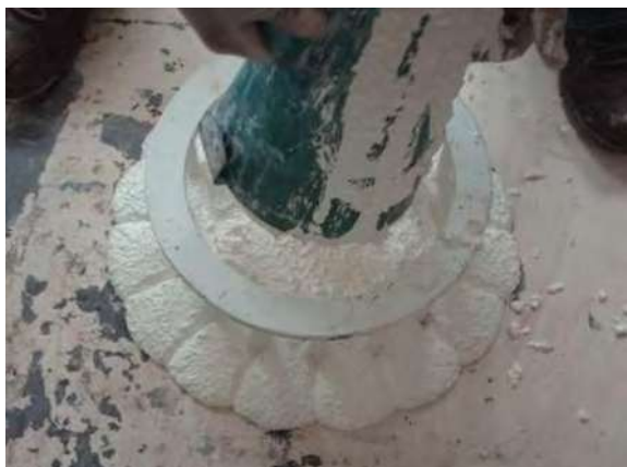
Fotografías 5.58 a, y b. Preparación y Elaboración de la mezcla de Nanoconcreto GP – 33%MAR TI, 33%GR2-3, 30%TiO 2 , CH.
