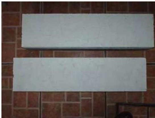
Fotografía 5.39. a, b, c y d respectivamente. Colado de la mezcla del Nanoconcreto GP – 33%MAR TI, 33%GR2-3, 5%WOLLAS, CH.
