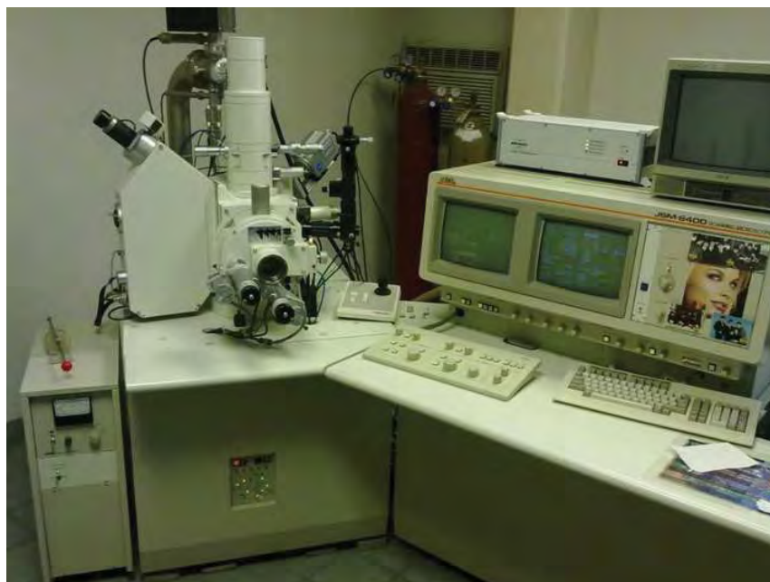
Fotografía 5.12. Equipo utilizado para la caracterización SEM.
