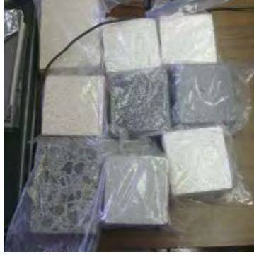
Fotografía 2.10. a y b. Especímenes pulidos para indentación Vicker.
