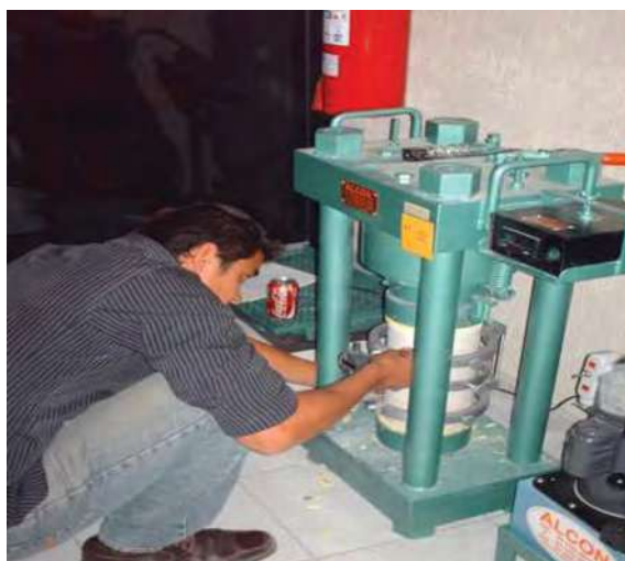
Fotografía 5.83 a, b y c. Preparación y medidas de las deformaciones en especímenes de concreto elaborado con CPC.
