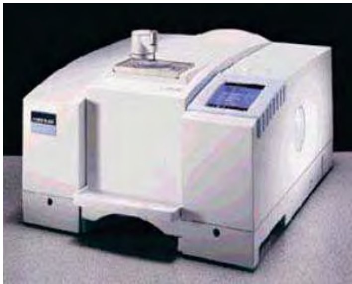
Figura 2.43. Equipo de FT-IR empleado para estudios de IR.
