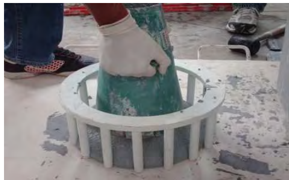
Fotografías 5.50 a y b. Preparación y elaboración de la mezcla de Nanoconcreto GP – 33%MAR TI, 33%GR2-3, 5%NEU#80, CH.
