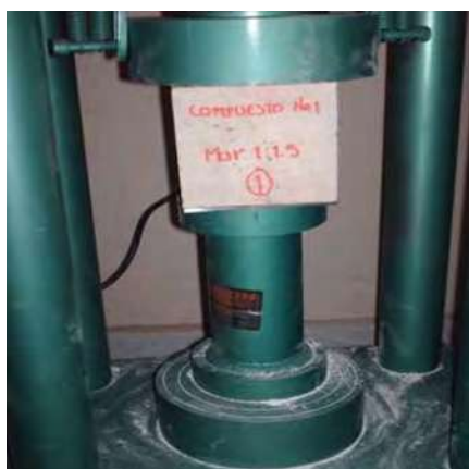
Fotografía 5.14. a y b. Determinación de la Resistencia a la Compresion del Nanoconcreto GP - 50%MAR TI, 50%GR2-3.
