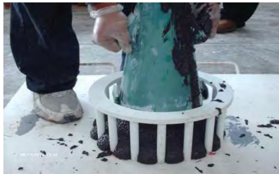
Fotografías 5.42 a y b. Elaboración de la mezcla del Nanoconcreto GP – 25%MAR TI, 25%GR2-3, 100%OXIFe, 7%AGUA CH.
