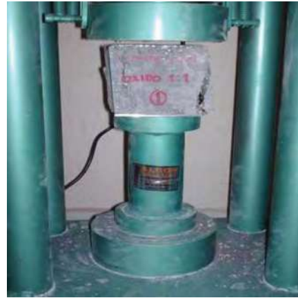
Fotografía 5.16. a y b. Determinación de la Resistencia a la Compresión del Nanoconcreto GP – 25%MAR TI, 25%GR2-3, 50%OXIFe.
