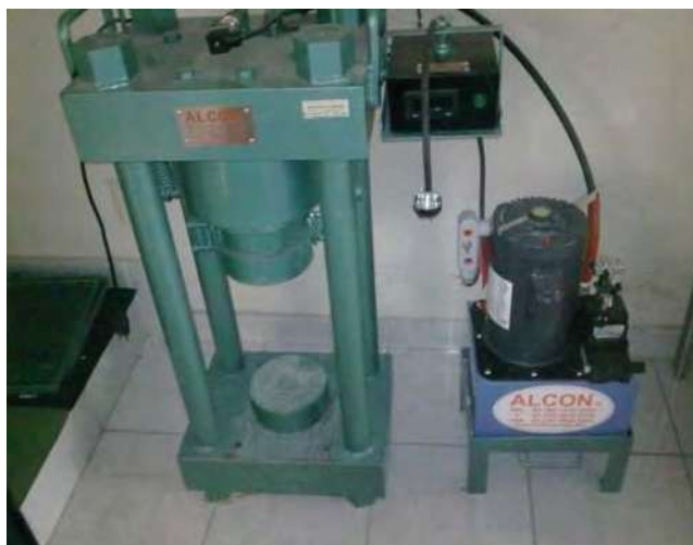
Fotografía 5.3. Prensa utilizada para la determinación de la resistencia a compresión.
