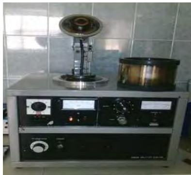
Fotografía 2.2. Equipo empleado para el recubrimiento de muestras mediante la pulverización.
