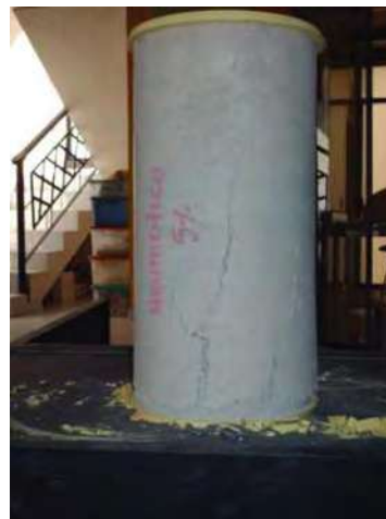
Fotografía 5.88 a, b y c. Preparación y medidas de las deformaciones en Especímenes ultra-thin de Concreto CPC y Nanoconcreto GP – 33%MAR TI, 33%GR2-3, 5%NEU#80, CH.
