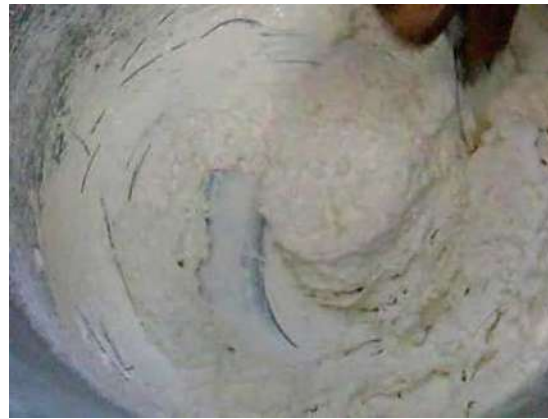
Fotografía 4.4. Mezcla de los componentes para la conformación de nanocemento geopolimérico.
