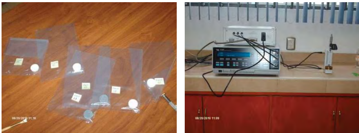
Fotografía 2.9. a y b. Muestras y equipo utilizado para caracterizacion a través de IES
