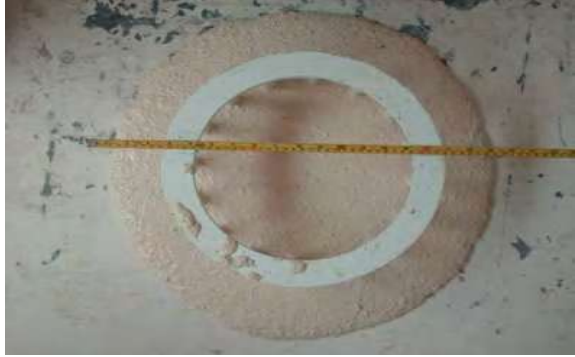
Fotografía 5.38. a, b, c, d, e y f respectivamente. Medición de la Extensibilidad y Revenimiento de la mezcla del Nanoconcreto GP – 33%MAR TI, 33%GR2-3, 5%WOLLAS, CH.
