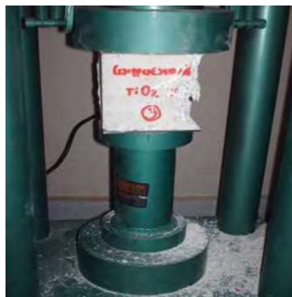
Fotografía 5.13. a y b. Determinación de la Resistencia a la Compresion del Nanoconcreto GP – 33%MAR TI, 33%GR2-3, 20%TiO2.
