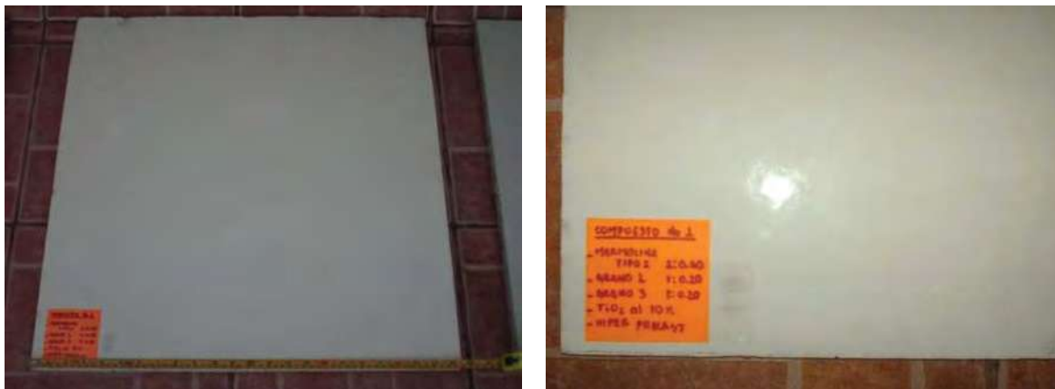
Fotografías 6.12 a y b respectivamente. Placa de Material Geopolimérico Reflectivo Sin Fibra antes de Intemperismo Ambiental.
