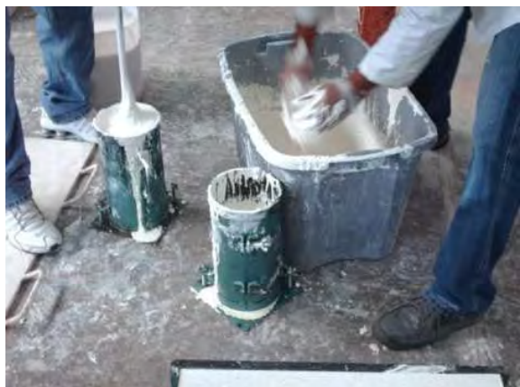
Fotografías 5.60 a, b, c y d. Colado de la mezcla de Nanoconcreto GP – 33%MAR TI, 33%GR2-3, 30%TiO 2 , CH.
