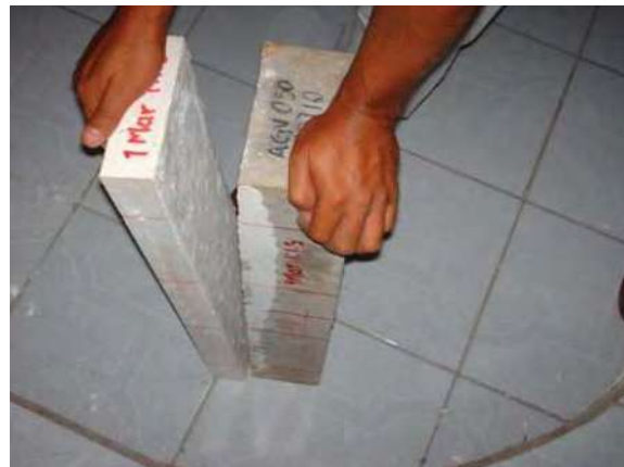
Fotografías 5.70. Prueba de Resistencia a Flexión en Especímenes ultra-thin compuesto de Concreto CPC y Nanoconcreto GP – 50%MAR TI, 50%GR2-3, CH
