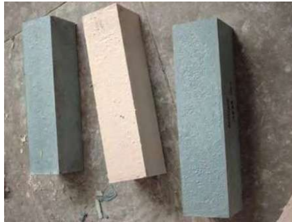
Fotografías 5.67. Desmolde y almacenamiento de vigas de 15x15x60 cm de nanocementos geopolimericos.
