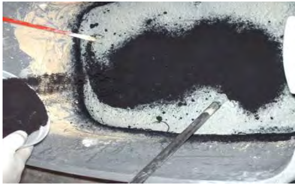
Fotografías 5.50 a y b. Preparación y elaboración de la mezcla de Nanoconcreto GP – 33%MAR TI, 33%GR2-3, 5%NEU#80, CH.
