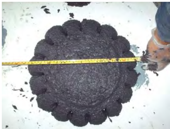
Fotografías 5.43 a, b, c, d, e y f. Medición del Revenimiento y Extensibilidad de la mezcla del Nanoconcreto GP – 25%MAR TI, 25%GR2-3, 100%OXIFe, 7%AGUA CH.
