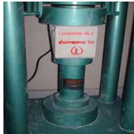
Fotografía 5.17. a y b. Determinación de la Resistencia a la Compresión del Nanoconcreto GP – 33%MAR TI, 33%GR2-3, 5%NEU#80.
