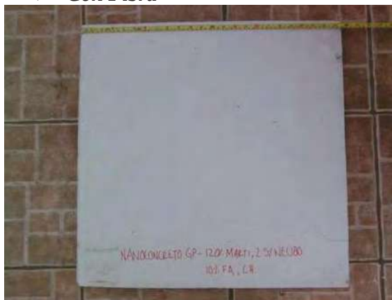
Fotografías 6.20 a y b respectivamente. Placa de Material Geopolimérico Ecológico Con y Sin Fibra después de Intemperismo Ambiental.
