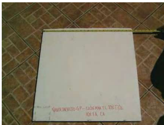
Fotografías 6.19 a y b respectivamente. Placa de Material Geopolimérico Reflectivo Con y Sin Fibra después de Intemperismo Ambiental.
