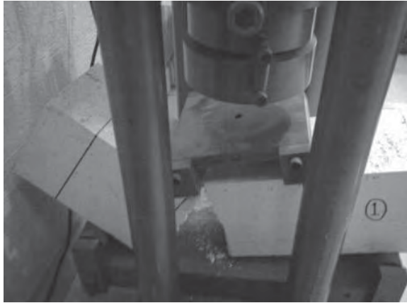
Fotografías 5.80. a y b. Prueba de Resistencia a Flexión en Especímenes de Nanoconcreto (especimen completo de nanoconcreto GP) GP – 50%MAR TI, 50%GR2-3, 5%NEU#80, CH.
