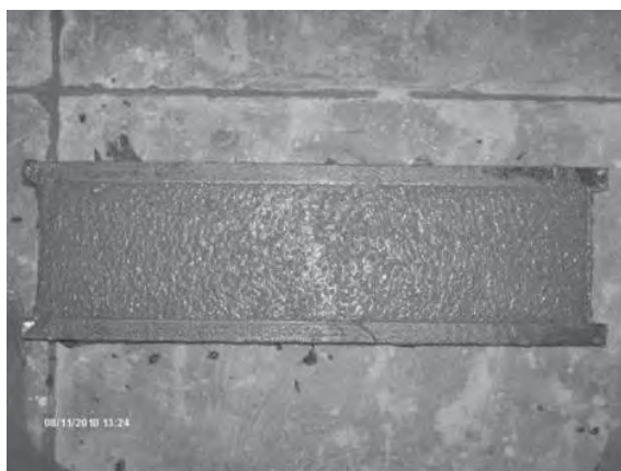
Fotografías 5.43 a, b, c, d, e y f. Medición del Revenimiento y Extensibilidad de la mezcla del Nanoconcreto GP – 25%MAR TI, 25%GR2-3, 100%OXIFe, 7%AGUA CH.
