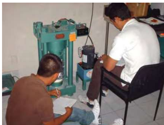
Fotografía 5.83 a, b y c. Preparación y medidas de las deformaciones en especímenes de concreto elaborado con CPC.
