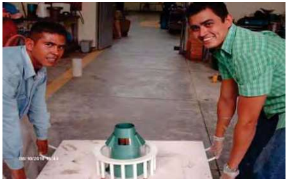
Fotografías 5.31. a y b. Preracion de moldes y elaboración de la mezcla de Nanoconcreto GP – 50%MAR TI, 50%GR2-3,CH.
