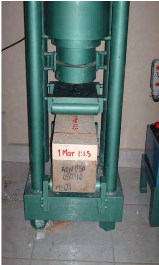
Fotografías 5.70. Prueba de Resistencia a Flexión en Especímenes ultra-thin compuesto de Concreto CPC y Nanoconcreto GP – 50%MAR TI, 50%GR2-3, CH
