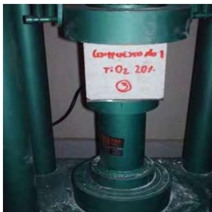
Fotografía 5.13. a y b. Determinación de la Resistencia a la Compresion del Nanoconcreto GP – 33%MAR TI, 33%GR2-3, 20%TiO2.
