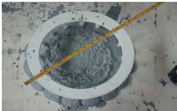
Fotografías 5.51 a, b, c, d y f. Medición del Revenimiento y Extensibilidad de la mezcla de Nanoconcreto GP – 33%MAR TI, 33%GR2-3, 5%NEU#80, CH.
