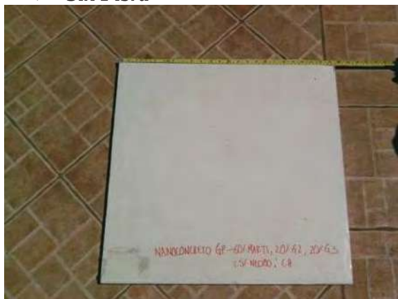
Fotografías 6.20 a y b respectivamente. Placa de Material Geopolimérico Ecológico Con y Sin Fibra después de Intemperismo Ambiental.
