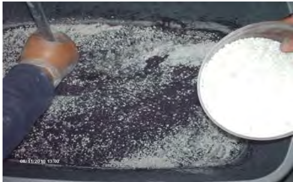
Fotografías 5.42 a y b. Elaboración de la mezcla del Nanoconcreto GP – 25%MAR TI, 25%GR2-3, 100%OXIFe, 7%AGUA CH.
