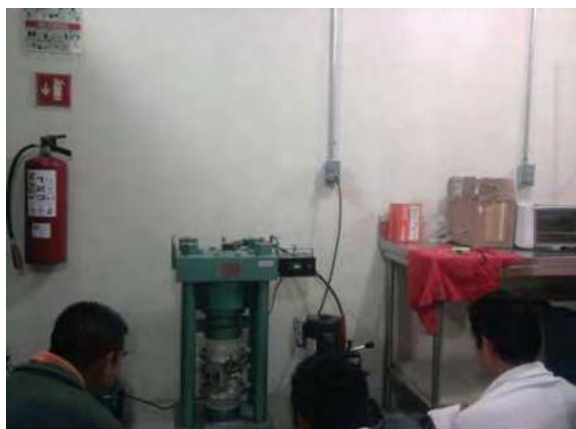
Fotografía 5.90 a, b y c. Preparación y medidas de las deformaciones en Especímenes ultra-thin de Concreto CPC y Nanoconcreto GP –33%MAR TI, 33%GR2-3, 30%TiO 2 , CH.
