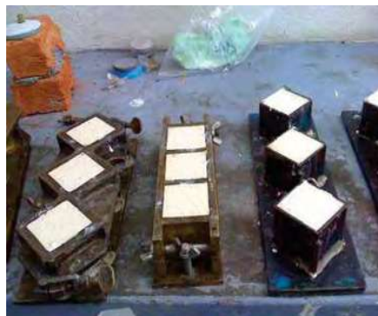
Fotografía 4.5. Elaboración de especímenes en moldes de 5 x 5 x 5 cm.
