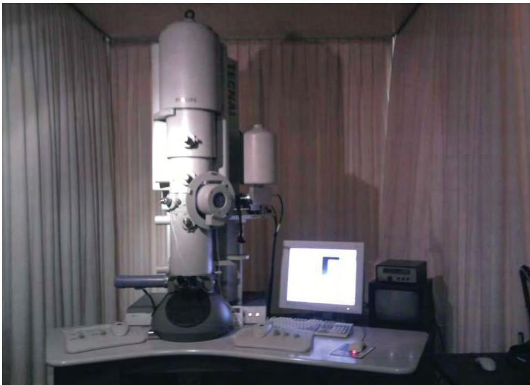
Fotografía 2.7. Microscopio TEM PHILIPS modelo TECNAI FEG DF20 utilizado.
