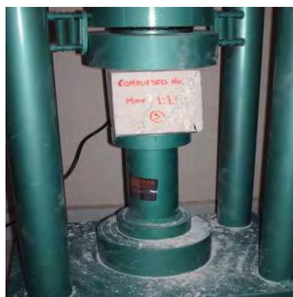
Fotografía 5.14. a y b. Determinación de la Resistencia a la Compresion del Nanoconcreto GP - 50%MAR TI, 50%GR2-3.
