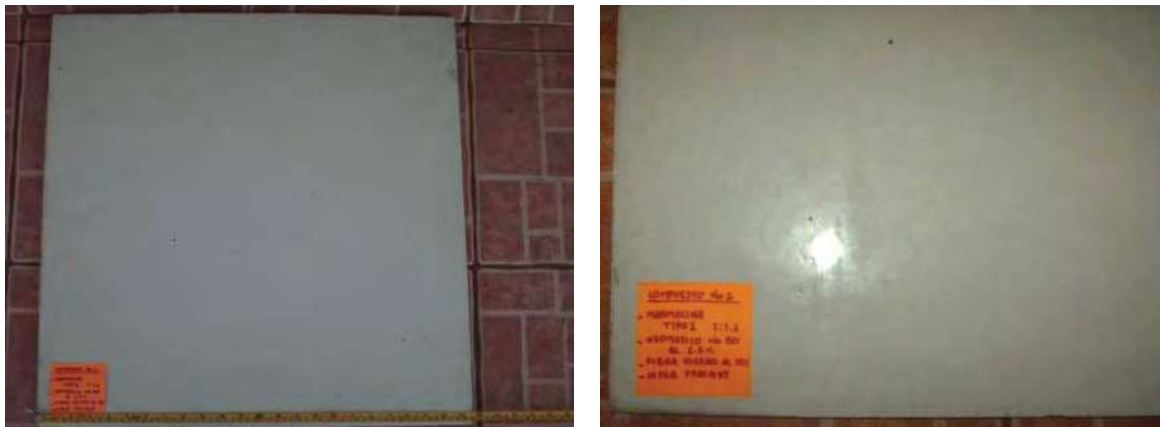
Fotografías 6.15 a y b respectivamente. Placa de Material Geopolimérico Ecológico Sin Fibra antes de Intemperismo Ambiental.
