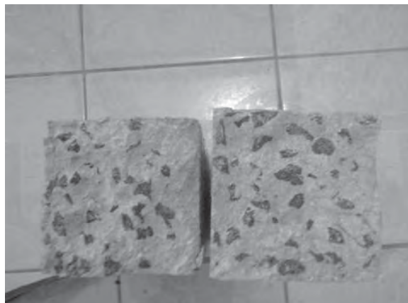
Fotografías 5.81 a y b. Prueba de Resistencia a Flexión en Especímenes de Nanoconcreto (especimen completo de nanoconcreto GP) GP – 50%MAR TI, 50%GR2-3, 5%NEU#80, 50%AGREGADO AGC, CH.
