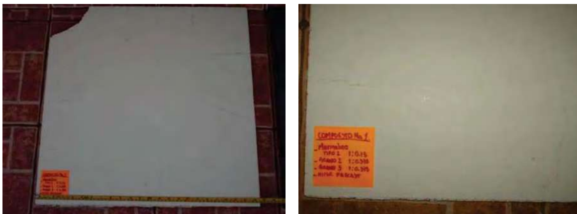
Fotografías 6.8 a y b respectivamente. Placa de Material Geopolimérico Estándar Sin Fibra antes de Intemperismo Ambiental.
