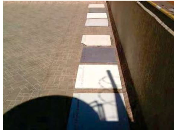
Fotografías 6.16 a, b c y d. Materiales después de 3 meses sometidos a intemperismo ambiental.
