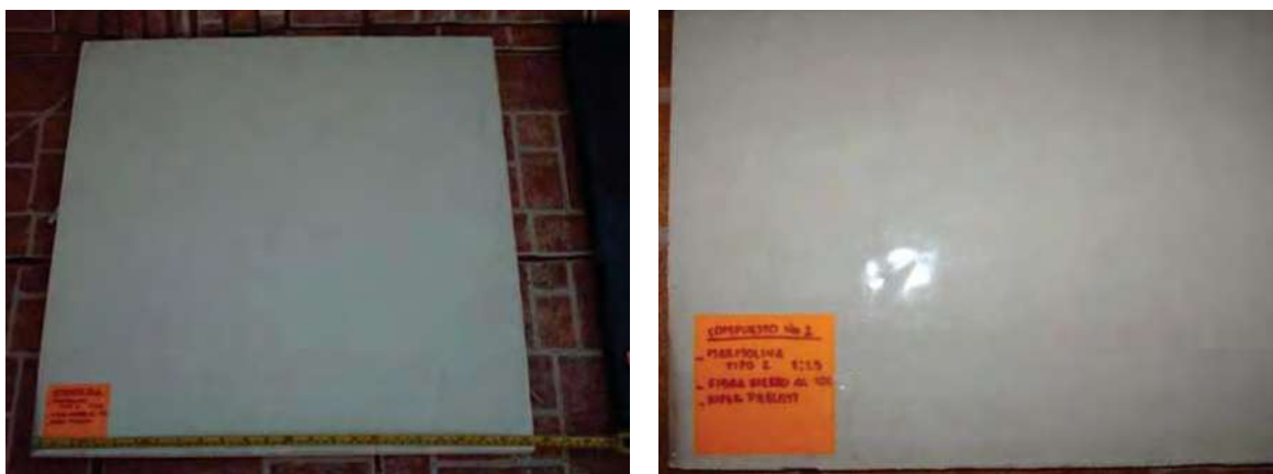
Fotografías 6.9 a y b respectivamente. Placa de Material Geopolimérico Estándar Con Fibra antes de Intemperismo Ambiental.
