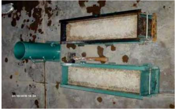
Fotografías 5.31. a y b. Preracion de moldes y elaboración de la mezcla de Nanoconcreto GP – 50%MAR TI, 50%GR2-3,CH.
