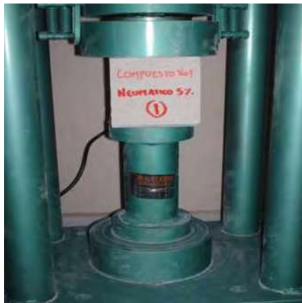
Fotografía 5.17. a y b. Determinación de la Resistencia a la Compresión del Nanoconcreto GP – 33%MAR TI, 33%GR2-3, 5%NEU#80.
