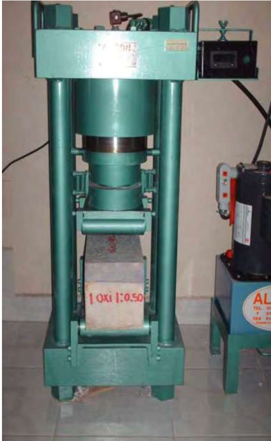
Fotografías 5.72. Prueba de Resistencia a Flexión en Especímenes ultra-thin compuesto de Nanoconcreto GP – 25%MAR TI, 25%GR2-3, 50%OXIFe, CH.
