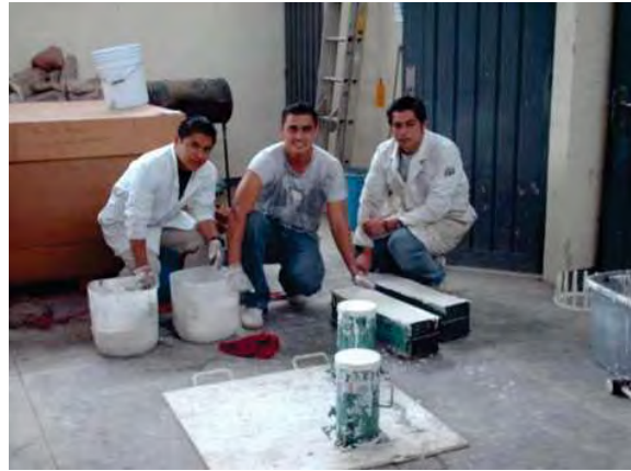
Fotografías 5.56 a, b, c y d. Colado de la mezcla de Nanoconcreto GP – 33%MAR TI, 33%GR2-3, 10%TiO 2 , CH.
