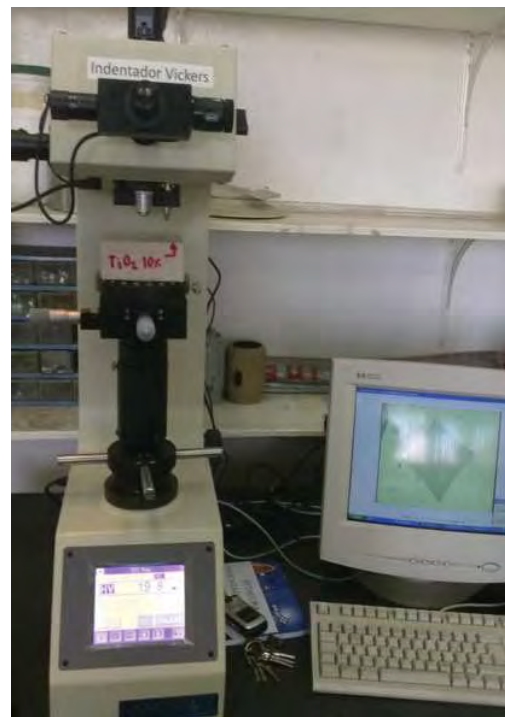
Fotografía 2.11. Indentador Vicker utilizado para la obtención de la dureza del material.
