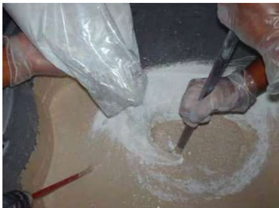
Fotografías 5.58 a, y b. Preparación y Elaboración de la mezcla de Nanoconcreto GP – 33%MAR TI, 33%GR2-3, 30%TiO 2 , CH.
