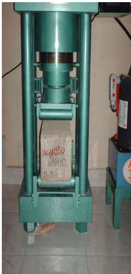
Fotografías 5.69. Prueba de Resistencia a Flexión en Especímenes de Concreto elaborado con CPC.
