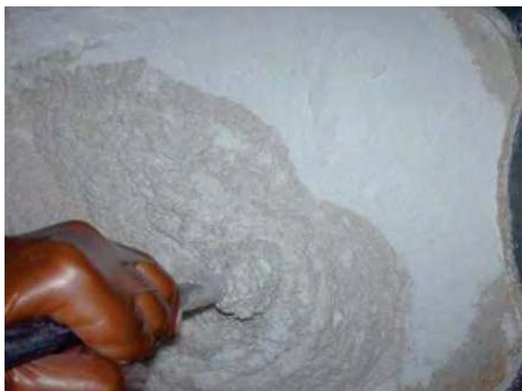
Fotografías 5.54 a, y b. Preparación y Elaboración de la mezcla de Nanoconcreto GP – 33%MAR TI, 33%GR2-3, 10%TiO 2 , CH.
