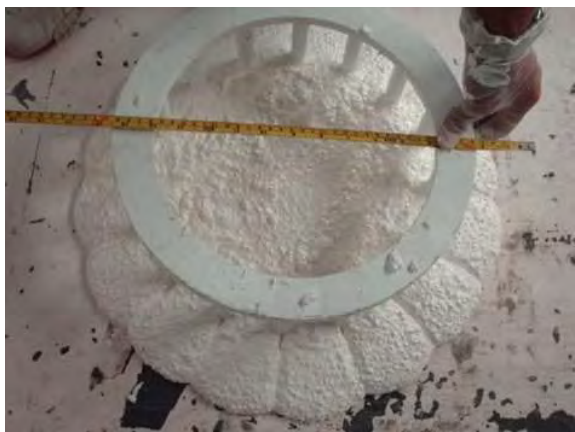
Fotografías 5.55 a, b, c y d. Medición del Revenimiento y Extensibilidad de la mezcla de Nanoconcreto GP – 33%MAR TI, 33%GR2-3, 10%TiO 2 , CH.
