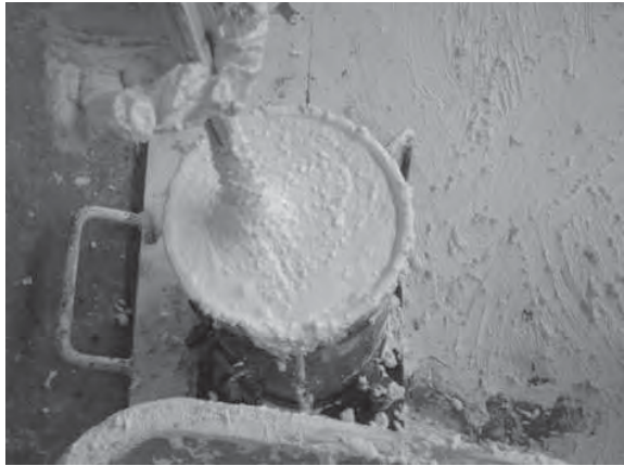
Fotografías 5.56 a, b, c y d. Colado de la mezcla de Nanoconcreto GP – 33%MAR TI, 33%GR2-3, 10%TiO 2 , CH.
