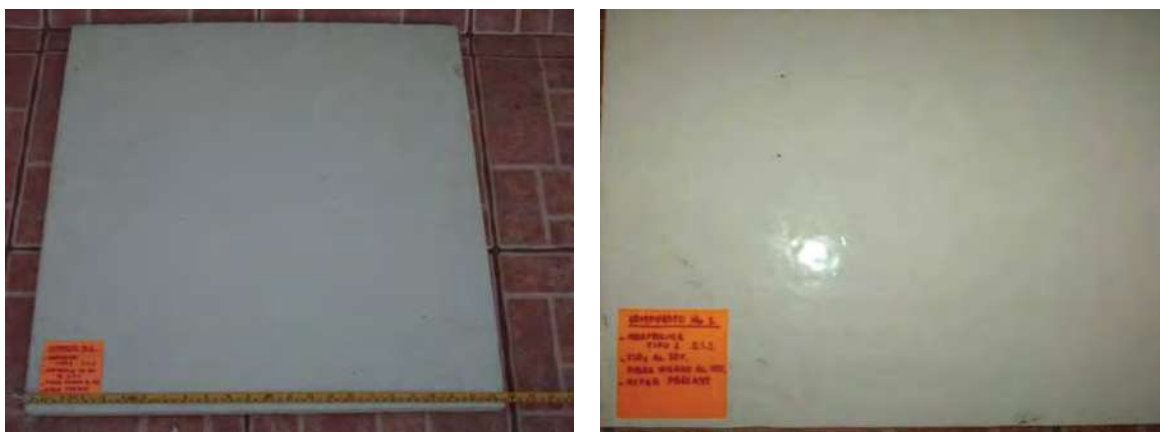
Fotografías 6.13 a y b respectivamente. Placa de Material Geopolimérico Reflectivo Con Fibra antes de Intemperismo Ambiental.
