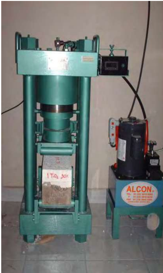
Fotografías 5.76. Prueba de Resistencia a Flexión en Especímenes ultra-thin compuesto de Nanoconcreto GP – 33%MAR TI, 33%GR2-3, 30%TiO 2 , CH.
