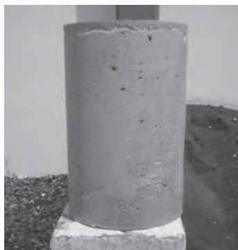
Fotografías 5.53 a, y b. Desmolde y almacenamiento de especímenes de Nanoconcreto GP – 33%MAR TI, 33%GR2-3, 5%NEU#80, CH.
