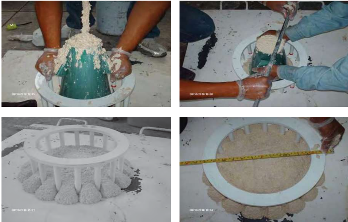
Fotografía 5.33. a, b, c y d. Medición de la Extensibilidad en Nanoconcreto GP – 50%MAR TI, 50%GR2-3,CH.
