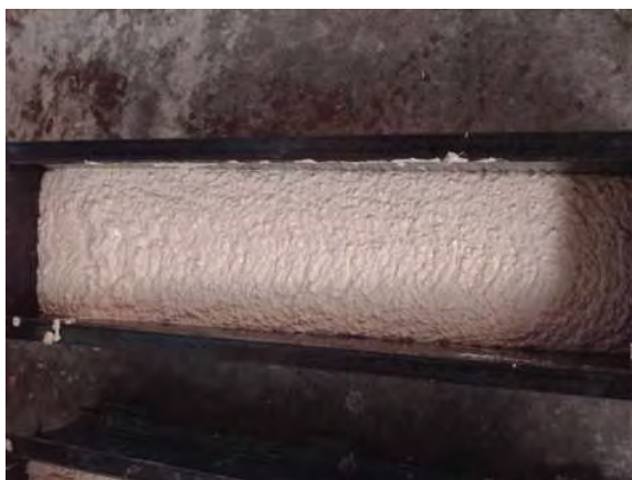
Fotografías 5.64 a y b. Elaboración y colado de la mezcla de Nanoconcreto GP – 50%MAR TI, 50%GR2-3, CH de 15x15x60cm.
