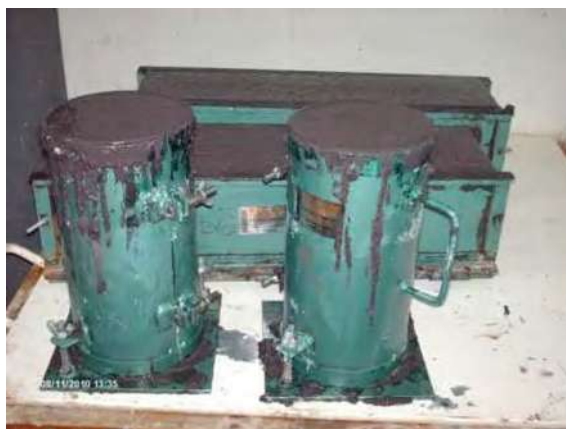
Fotografías 5.48 a, b, c y d. Colado de la mezcla del Nanoconcreto GP – 25%MAR TI, 25%GR2-3, 100%OXIFe, 7%AGUA CH.
