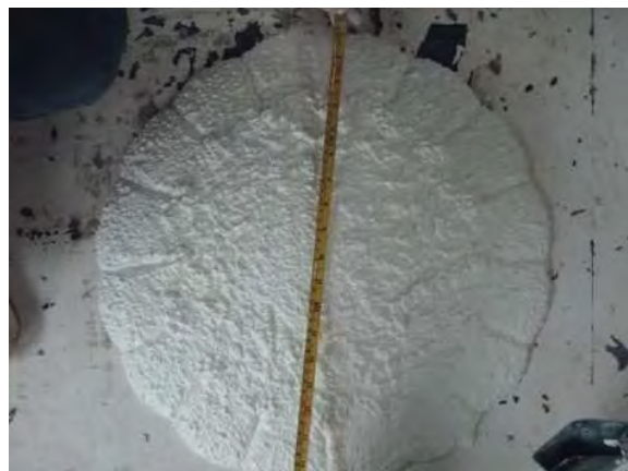
Fotografías 5.55 a, b, c y d. Medición del Revenimiento y Extensibilidad de la mezcla de Nanoconcreto GP – 33%MAR TI, 33%GR2-3, 10%TiO 2 , CH.
