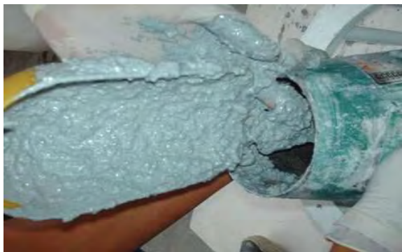
Fotografías 5.50 a y b. Preparación y elaboración de la mezcla de Nanoconcreto GP – 33%MAR TI, 33%GR2-3, 5%NEU#80, CH.
