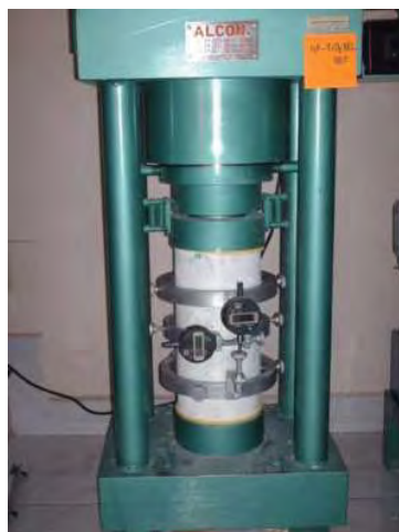
Fotografía 5.89 a, b y c. Preparación y medidas de las deformaciones en Especímenes ultra-thin de Concreto CPC y Nanoconcreto GP –33%MAR TI, 33%GR2-3, 10%TiO 2 , CH.
