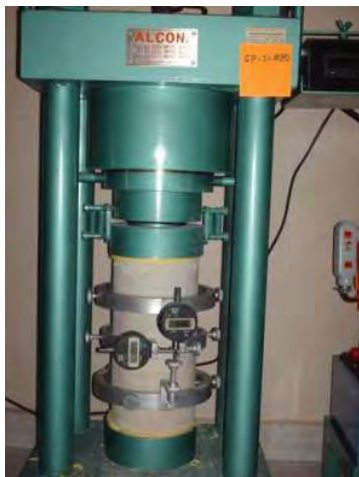
Fotografía 5.88 a, b y c. Preparación y medidas de las deformaciones en Especímenes ultra-thin de Concreto CPC y Nanoconcreto GP – 33%MAR TI, 33%GR2-3, 5%NEU#80, CH.
