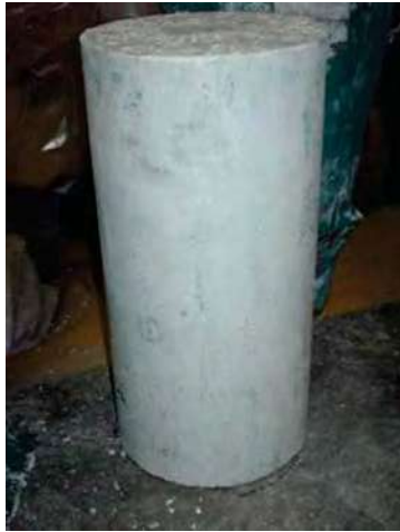
Fotografías 5.61 a y b. Desmolde y almacenamiento de la mezcla de Nanoconcreto GP – 33%MAR TI, 33%GR2-3, 30%TiO 2 , CH.
