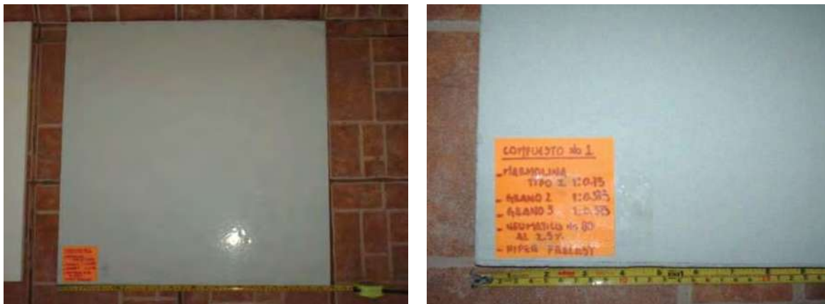
Fotografías 6.14 a y b respectivamente. Placa de Material Geopolimérico Ecológico Sin Fibra antes de Intemperismo Ambiental.
