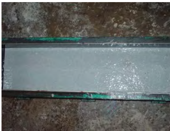
Fotografías 5.65 a y b. Elaboración y colado de la mezcla de Nanoconcreto GP – 50%MAR TI, 50%GR2-3, 5%NEU#80, CH de 15x15x60cm.
