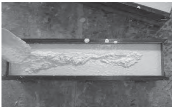
Fotografía 5.38. a, b, c, d, e y f respectivamente. Medición de la Extensibilidad y Revenimiento de la mezcla del Nanoconcreto GP – 33%MAR TI, 33%GR2-3, 5%WOLLAS, CH.
