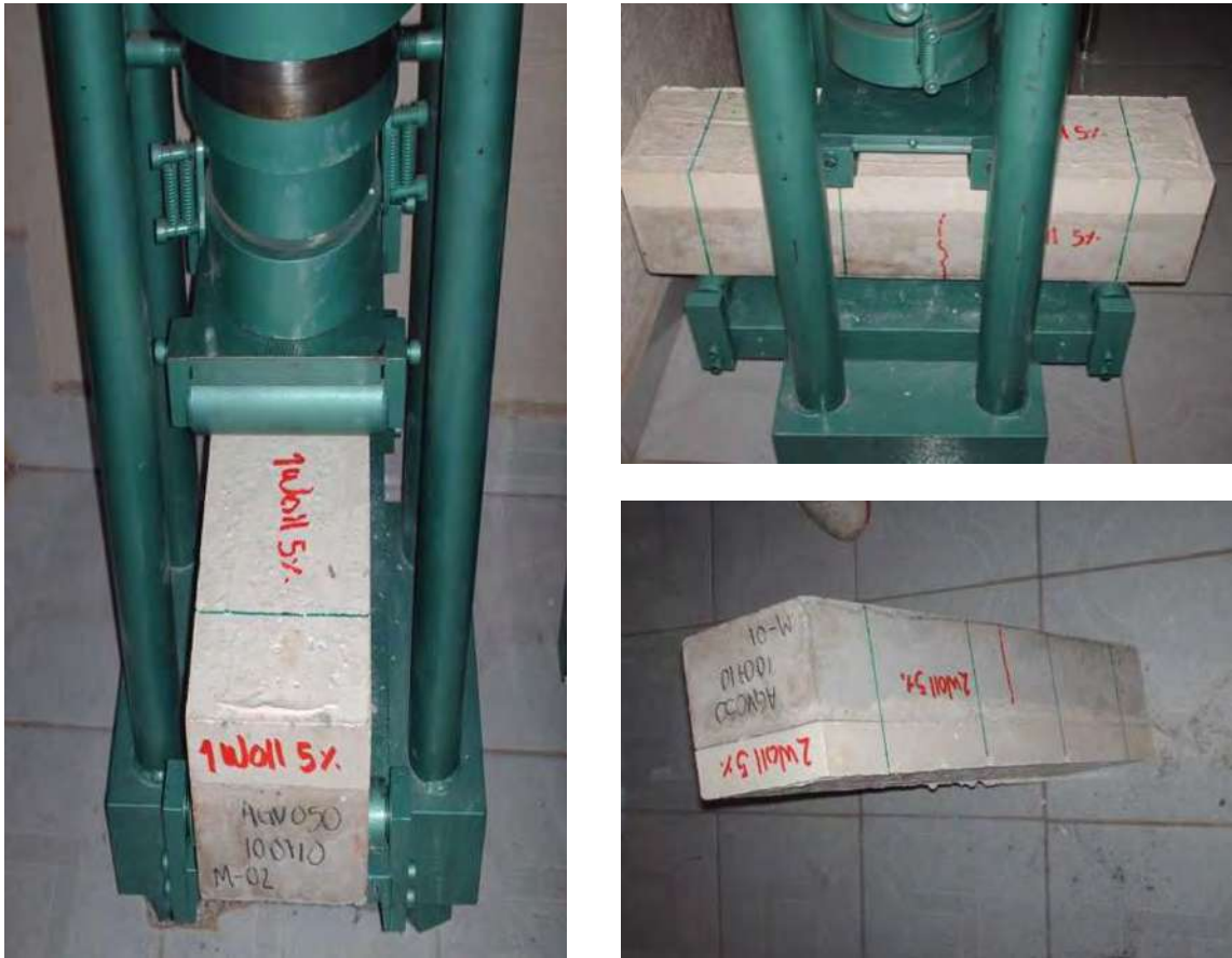
Fotografías 5.71. Prueba de Resistencia a Flexión en Especímenes ultra-thin compuesto de Nanoconcreto GP – 33%MAR TI, 33%GR2-3, 5%WOLLAS, CH.
