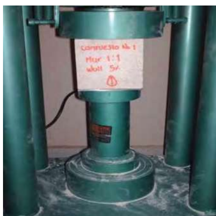
Fotografía 5.15. a y b. Determinación de la Resistencia a la Compresion del Nanoconcreto GP – 33%MAR TI, 33%GR2-3, 5%WOLLAS.
