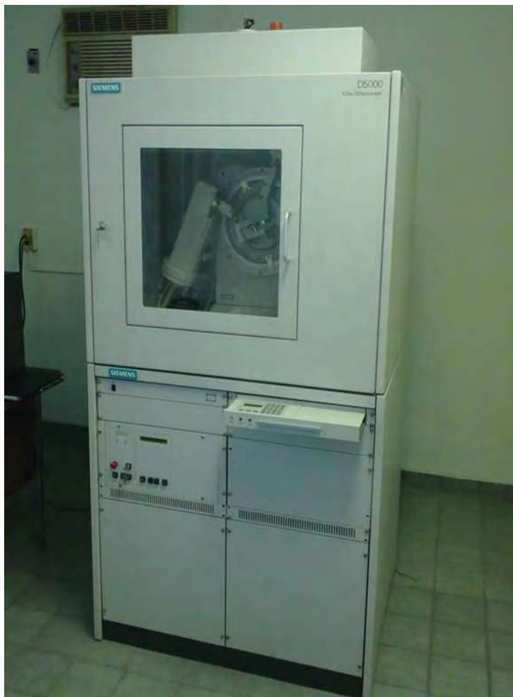
Fotografía 2.5. Equipo de análisis DRX SIEMENS D5000 utilizado.
