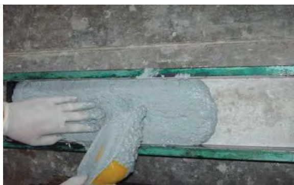
Fotografías 5.51 a, b, c, d y f. Medición del Revenimiento y Extensibilidad de la mezcla de Nanoconcreto GP – 33%MAR TI, 33%GR2-3, 5%NEU#80, CH.
