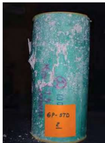
Fotografía 5-84 a, b y c. Preparación y medidas de las deformaciones en Especímenes ultra-thin de Concreto CPC y Nanoconcreto GP – 50%MAR TI, 50%GR2-3, CH
