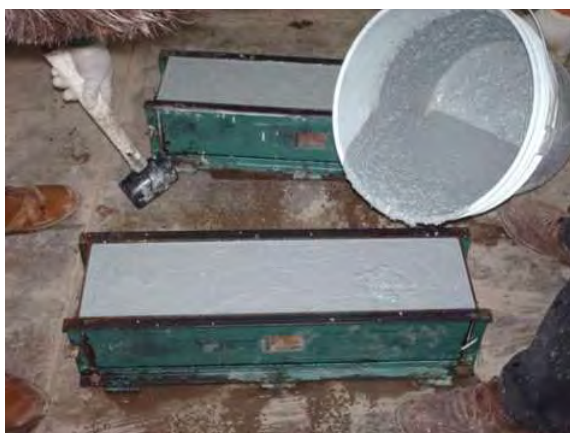
Fotografías 5.63 a y b. Elaboración y colado de la mezcla de Nanoconcreto GP – 33%MAR TI, 33%GR2-3, 5%NEU, CH de 5x15x60cm una vez que el concreto elaborado con CPC alcanza su fraguado inicial.
