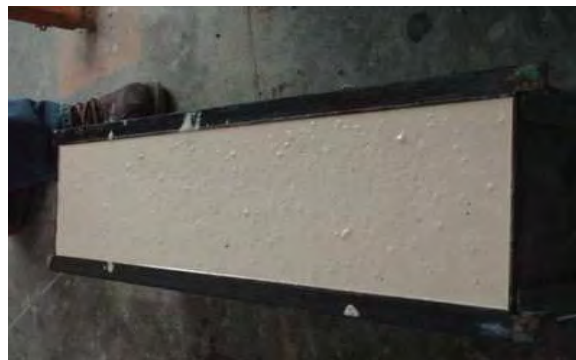
Fotografía 5.38. a, b, c, d, e y f respectivamente. Medición de la Extensibilidad y Revenimiento de la mezcla del Nanoconcreto GP – 33%MAR TI, 33%GR2-3, 5%WOLLAS, CH.
