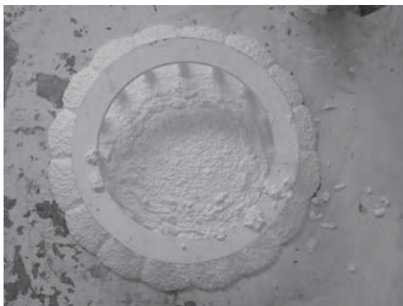
Fotografías 5.58 a, y b. Preparación y Elaboración de la mezcla de Nanoconcreto GP – 33%MAR TI, 33%GR2-3, 30%TiO 2 , CH.
