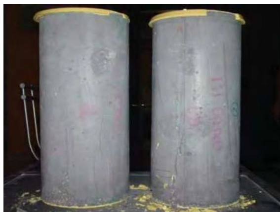
Fotografía 5.87 a, b y c. Preparación y medidas de las deformaciones en Especímenes ultra-thin de Concreto CPC y Nanoconcreto GP – 25%MAR TI, 25%GR2-3, 100%OXIFe, 7%AGUA, CH.
