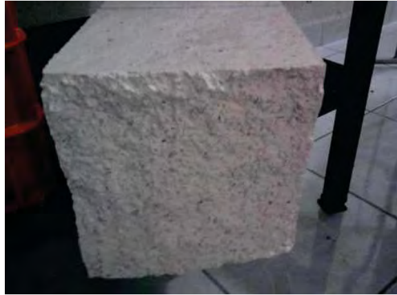
Fotografías 5.80. a y b. Prueba de Resistencia a Flexión en Especímenes de Nanoconcreto (especimen completo de nanoconcreto GP) GP – 50%MAR TI, 50%GR2-3, 5%NEU#80, CH.
