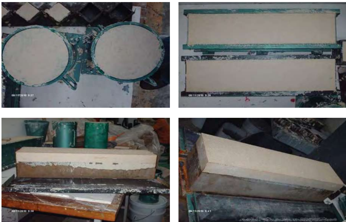
Fotografía 5.36. a, b, c y d respectivamente. Desmolde a las 24 horas de colado del Nanoconcreto GP – 50%MAR TI, 50%GR2-3, CH.
