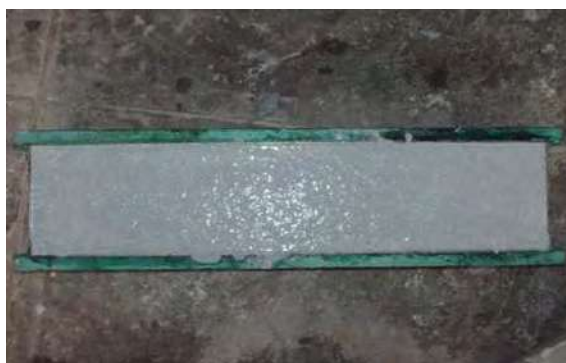
Fotografías 5.51 a, b, c, d y f. Medición del Revenimiento y Extensibilidad de la mezcla de Nanoconcreto GP – 33%MAR TI, 33%GR2-3, 5%NEU#80, CH.
