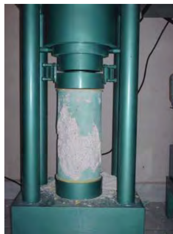
Fotografía 5.85 a, b y c. Preparación y medidas de las deformaciones en Especímenes ultra-thin de Concreto CPC y Nanoconcreto GP – 33%MAR TI, 33%GR2-3, 5%WOLLAS, CH.
