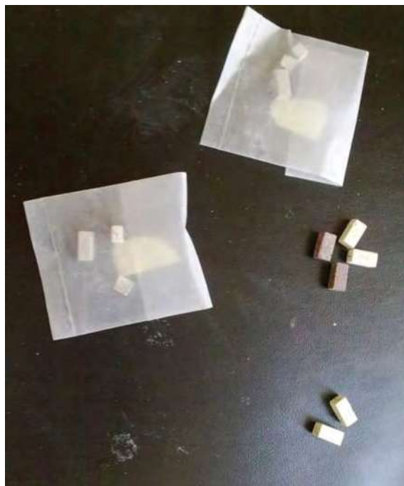
Fotografía 2.12. a y b. Especímenes labrados para prueba de dilatometría.
