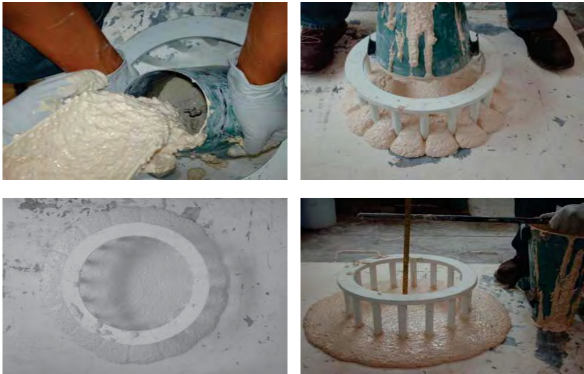
Fotografía 5.37. a, y b respectivamente. Preparación de la mezcla del Nanoconcreto GP – 33%MAR TI, 33%GR2-3, 5%WOLLAS, CH.
