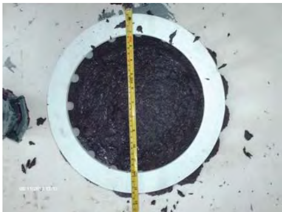
Fotografías 5.43 a, b, c, d, e y f. Medición del Revenimiento y Extensibilidad de la mezcla del Nanoconcreto GP – 25%MAR TI, 25%GR2-3, 100%OXIFe, 7%AGUA CH.
