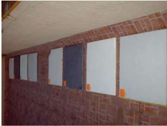
Fotografías 6.16 a, b c y d. Materiales después de 3 meses sometidos a intemperismo ambiental.
