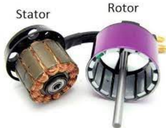
Figura 3.1: Partes de un motor BLDC [1].
