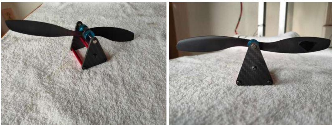
Figura 6.6: Izquierda: Hélice no balanceada. Derecha: Hélice balanceada usando cinta aislante.
