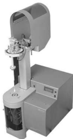
Figura 2.11. Imagen de la Termobalanza Setaram Setsys Evolution usada en el presente trabajo.
